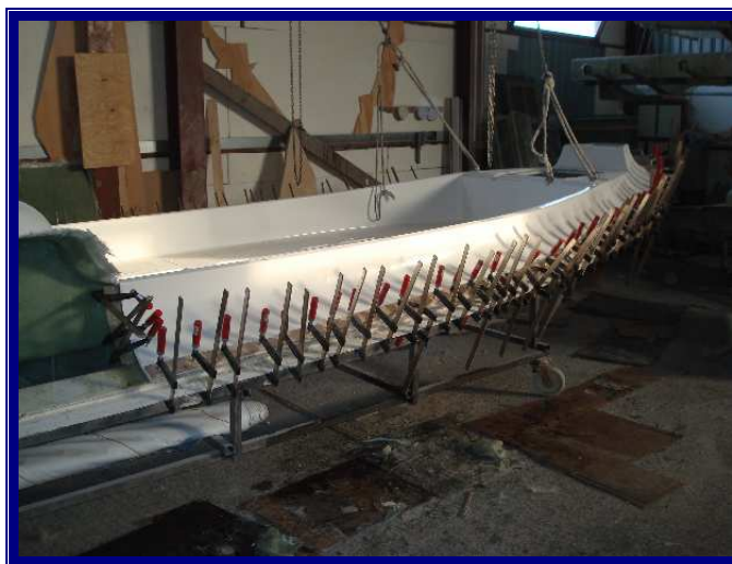
Slika 3.7 Spajanje odljevaka palube i dna
