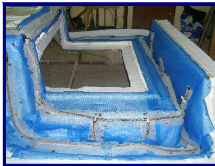
Slika 4.21 Krug cjevovoda smole na krmenom dijelu palube
