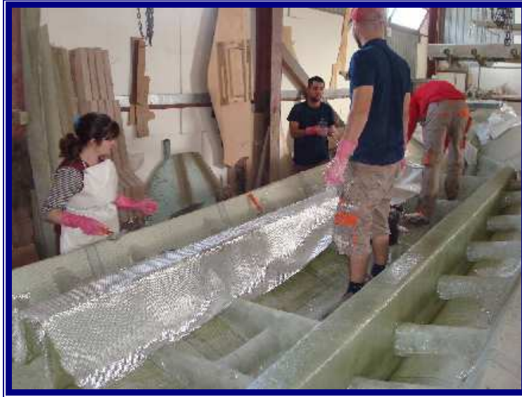
Slika 3.5 Postavljanje i učvršćivanje roštilja dna
