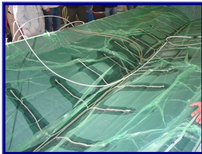
Slika 4.16 Uvođenje smole u laminat
