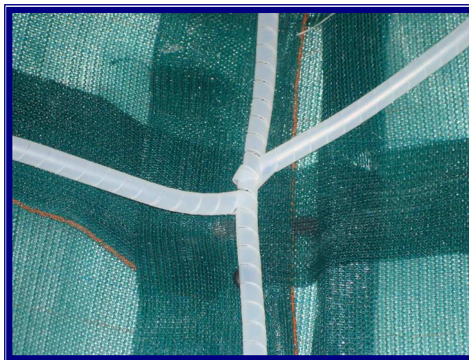
Slika 4.14 Postavljanje cjevovoda smole
