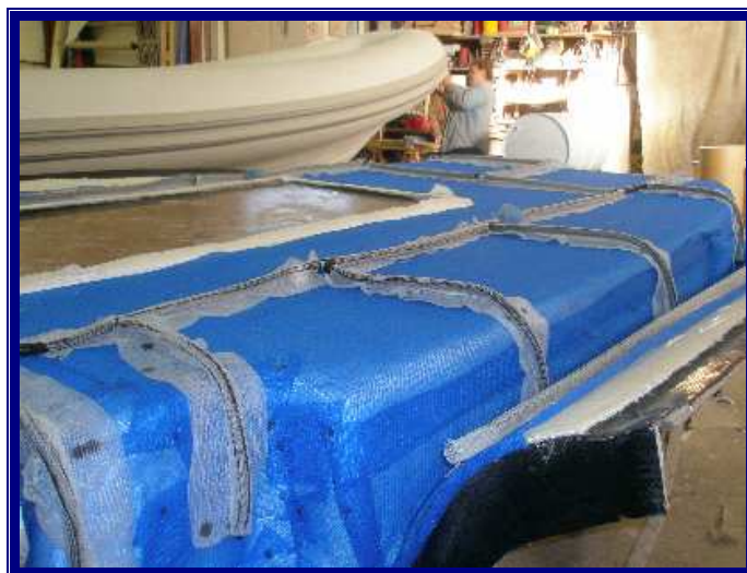
Slika 4.20 Najviši krug cjevovoda smole
