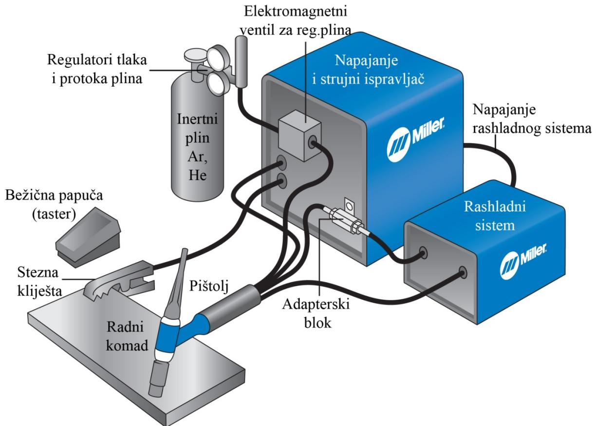
Slika 1. Osnovni dijelovi uređaja za TIG zavarivanje [6]
