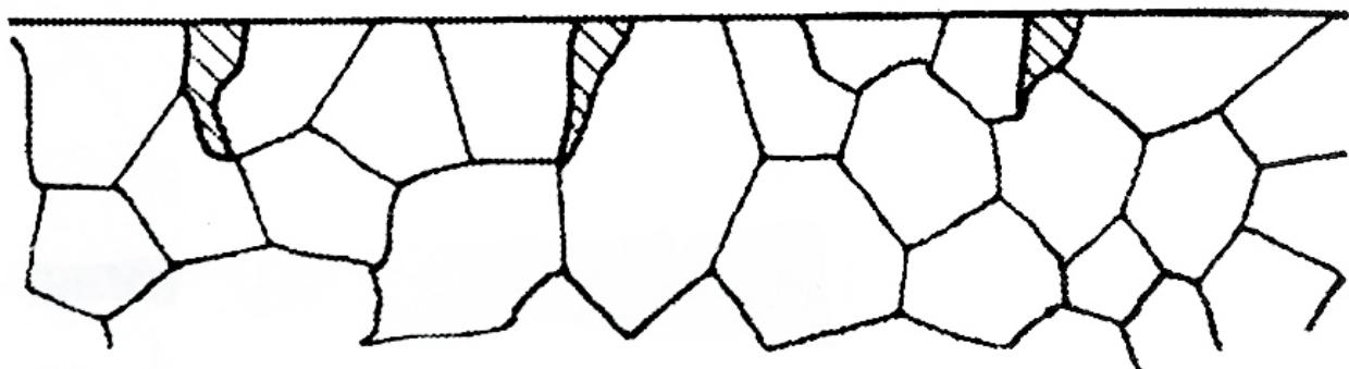
Slika 39. Pojavni oblik selektivne, točkaste - jamičaste (“pitting”) korozije [16]
