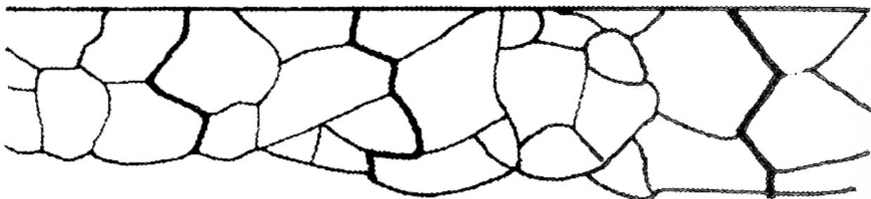
Slika 40. Pojarni oblik selektivne, interkristalne korozije [16]
