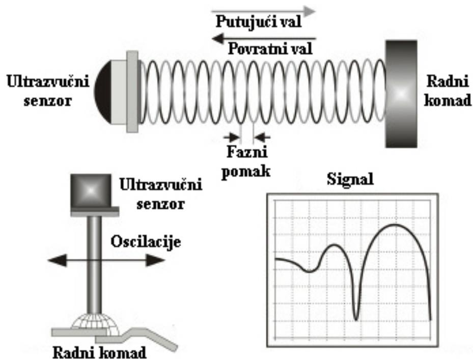
Slika 30. Princip rada ultrazvučnog senzora [13]
