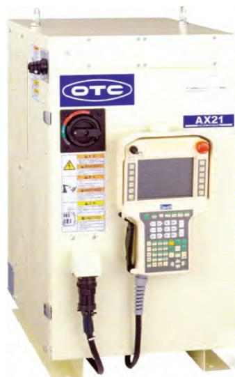
Slika 45. Slika robotskog upravljačkog sklopa OTC AX-21 [17]
