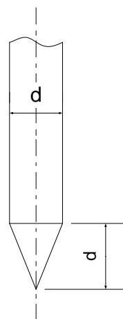
Slika 52. Izgled elektrode za TIG navarivanje austenitnog čelika
