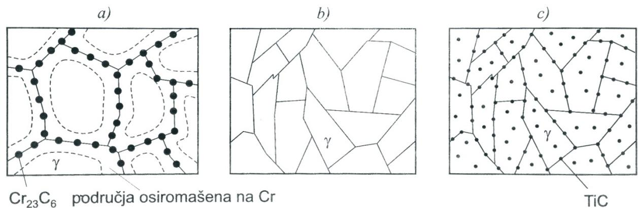
Slika 41. Shematski prikaz: a) senzibilizirane strukture Cr-Ni čelika, b) stabilizirane strukture nakon gašenja, c) strukture čelika stabilizirane titanom [16]
