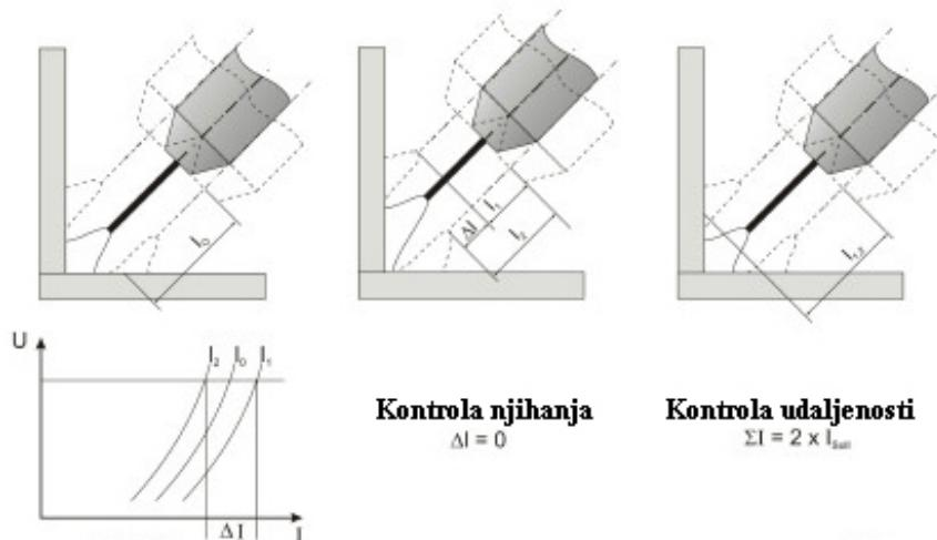
Slika 31. Princip rada senzora udaljenosti el. luka [13]
