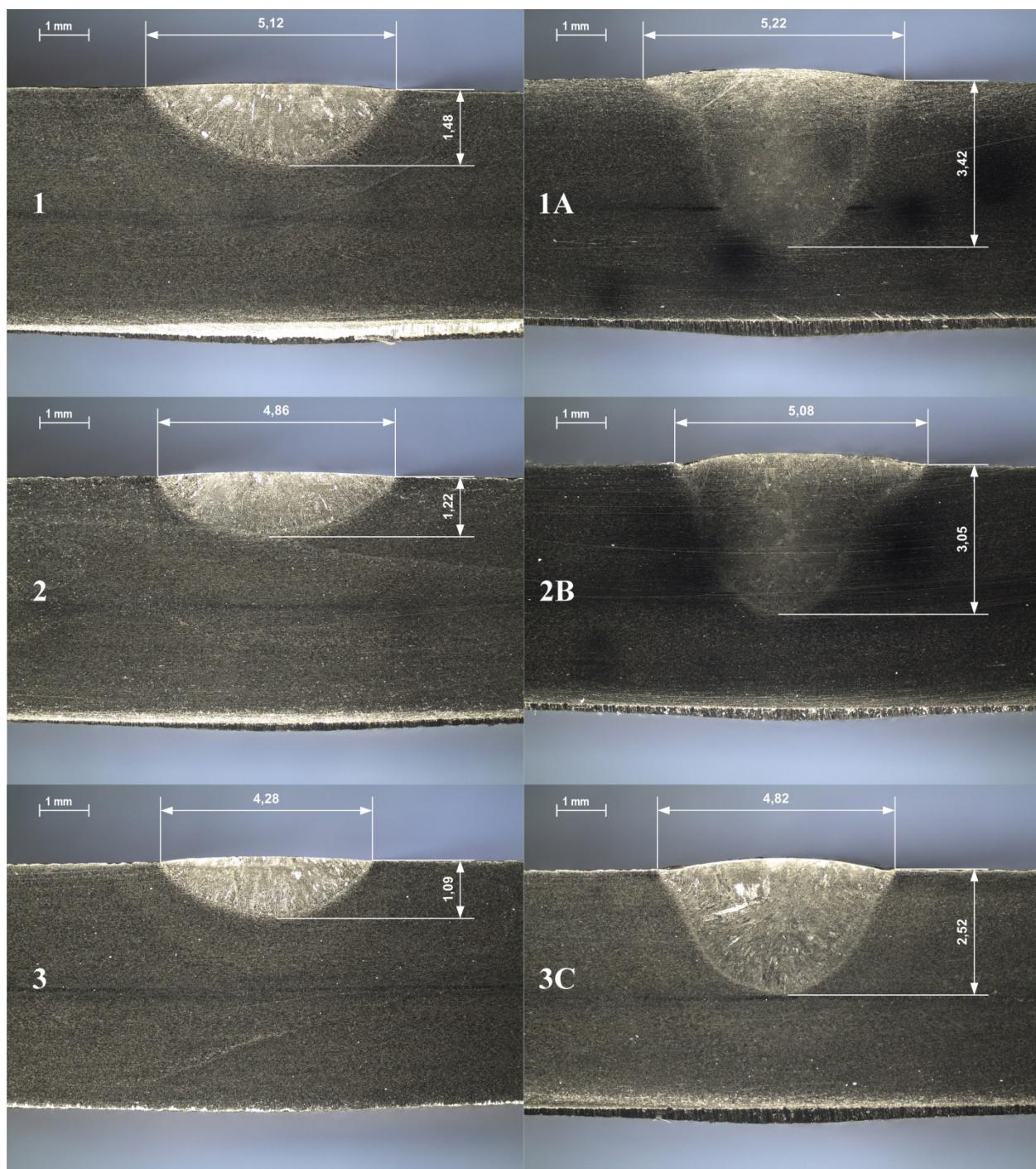
Slika 60. Usporedba makrouzoraka navara izvedenih bez premaza (1,2,3) i s aktivacijskim premazom od SiO<sub>2</sub> (1A - 8 [cm/min]; 2B - 10 [cm/min]; 3C - 12 [cm/min])
