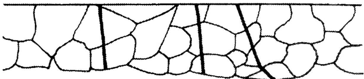
Slika 42. Pojavni oblik selektivne, napetosne korozije [16]
