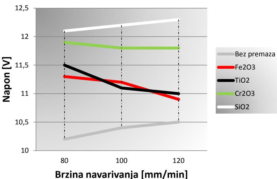
Slika 58. Grafički prikaz odnosa napona i brzine navarivanja ovisno o vrsti aktivacijske paste
