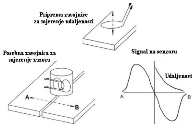
Slika 29. Princip rada induktivnog senzora s jednom ili više zavojnica [13]
