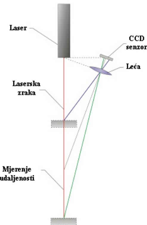
Slika 33. Princip rada optičkih senzora [13]
