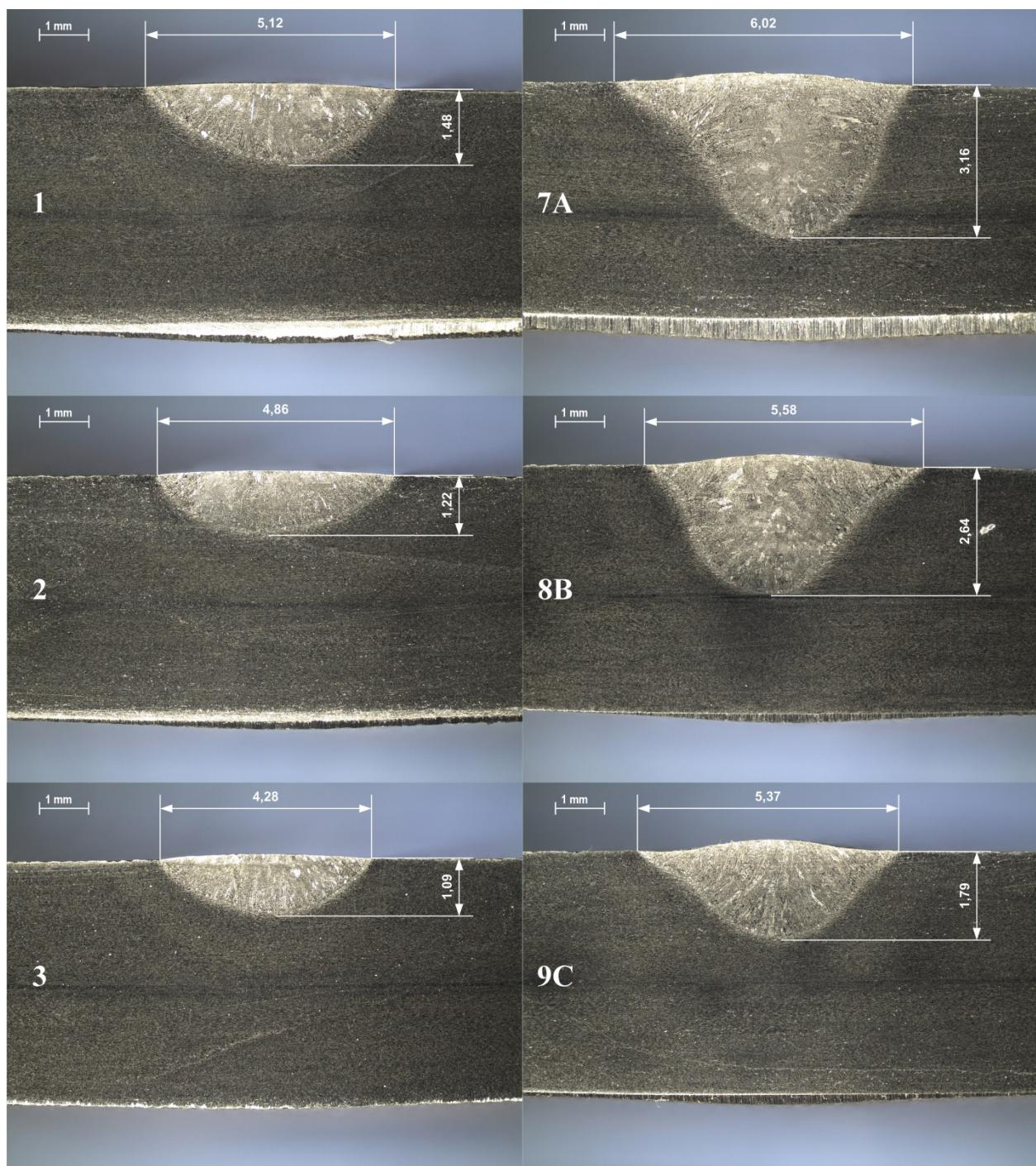
Slika 62. Usporedba makrouzoraka navara izvedenih bez premaza (1,2,3) i s aktivacijskim premazom od Cr<sub>2</sub>O<sub>3</sub> (7A - 8 [cm/min]; 8B - 10 [cm/min]; 9C - 12 [cm/min])
