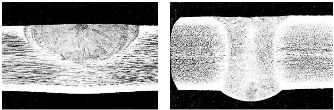
a) Zavar bez A-TIG talila pri 187 [A], 9,5 [V], 100 [mm/min], 1,07 [kJ/mm]
