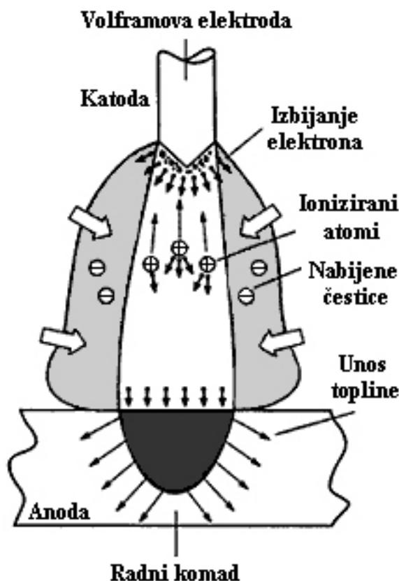
Slika 18. Mehanizam nastanka električnog luka kod A-TIG procesa po Lucas-u i Howse-u
