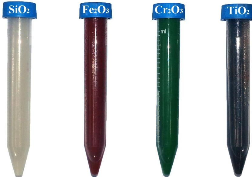
Slika 55. Izgled pripremljenih aktivacijskih A-TIG premaza
