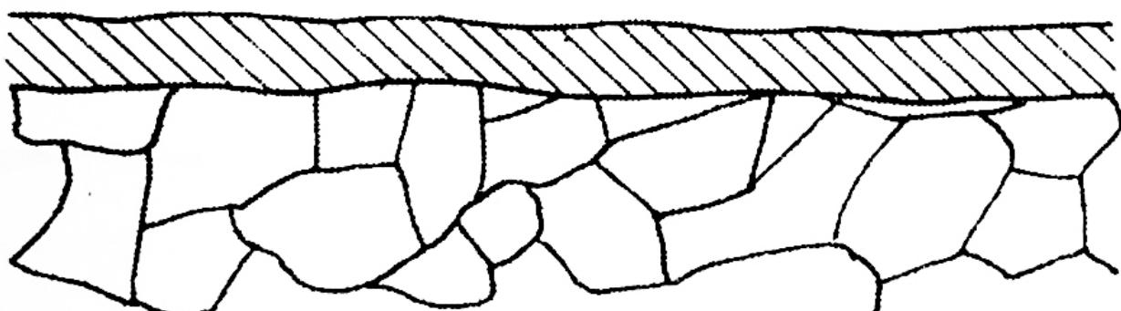
Slika 37. Pojavni oblik opće - jednolične korozije [16]
