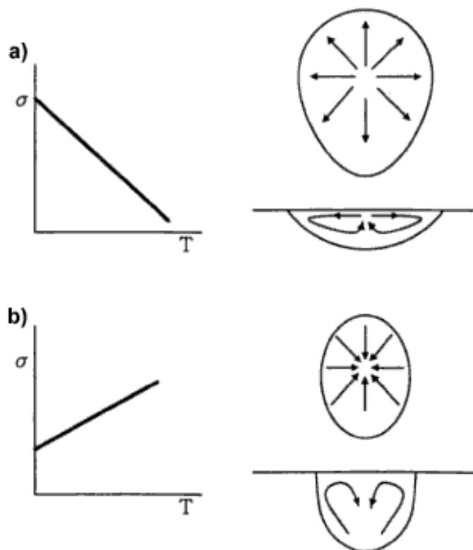
Slika 17. Maragonijev efekt strujanja fluida: a) negativan koeficijent - plića penetracija
