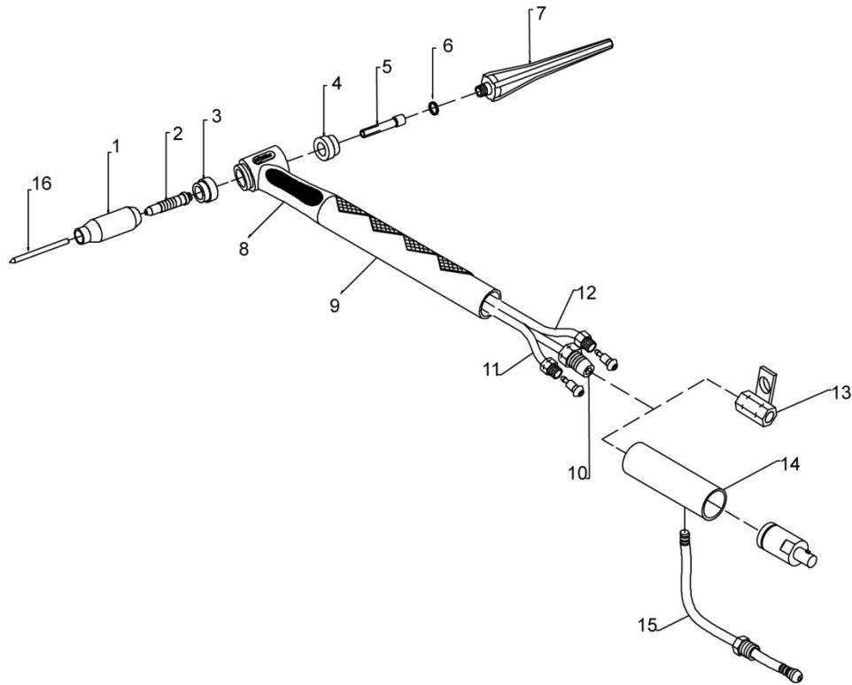
Slika 5. TIG pištolj za ručno zavarivanje s vodenim hlađenjem, rastavljen prema numeriranom redoslijedu sklapanja [6]
