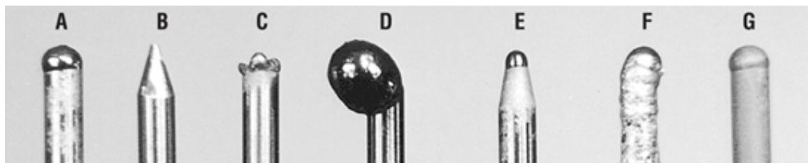
Slika 8. Primjeri izgleda vrhova korištenih elektroda [6]
