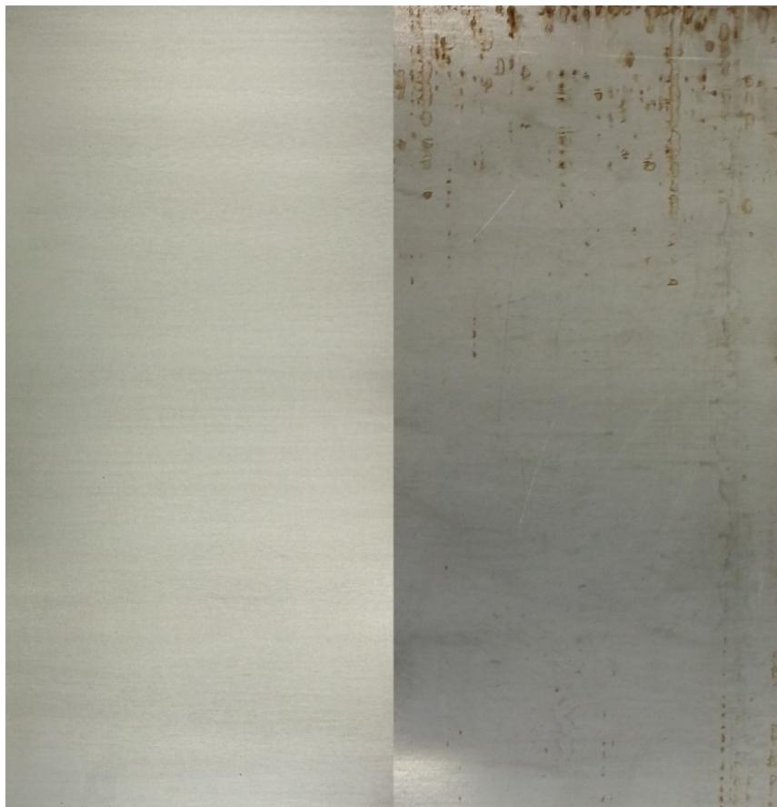
Slika 53. Prikaz površinske pripreme osnovnog materijala, lijevo-očišćeno, desno-neočišćeno
