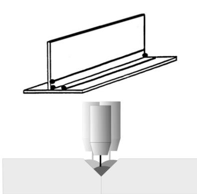
Slika 24. Mogućnost višeslojnog zavarivanja
