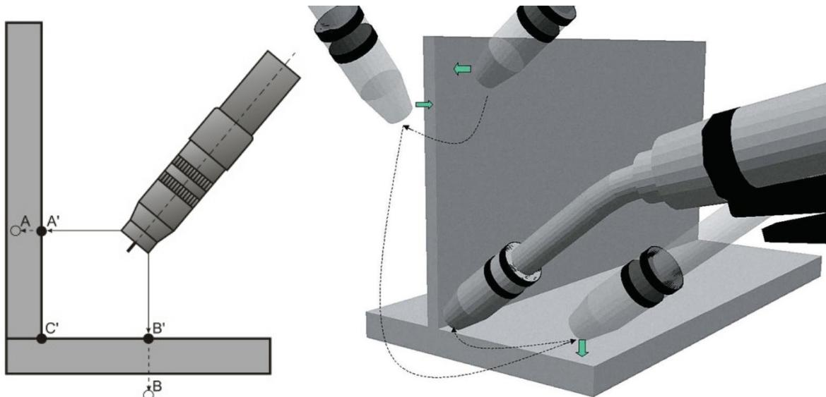
Slika 28. Način detekcije radnog komada uz pomoć kontaktnog električnog senzora [13,15]
