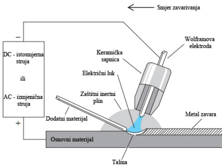
Slika 2. Shematski prikaz TIG zavarivanja [10]
