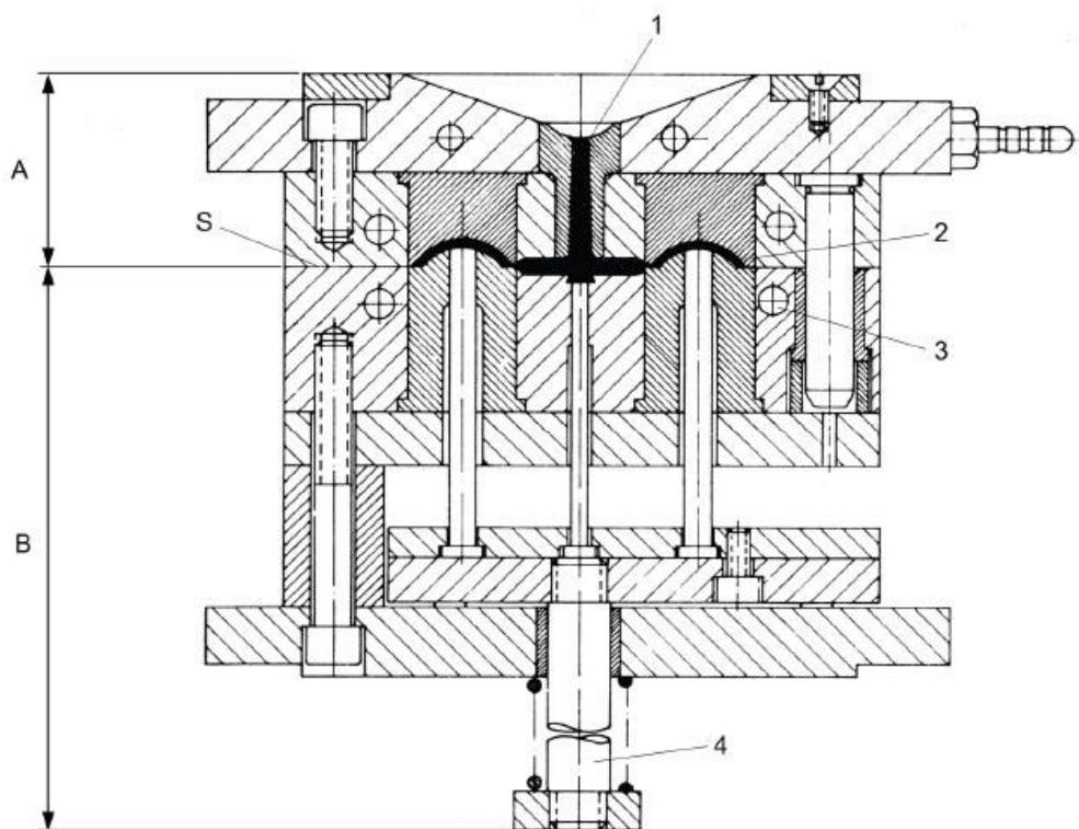
**Slika 3.1. Kalup za injekcijsko prešanje plastomera [9]**
