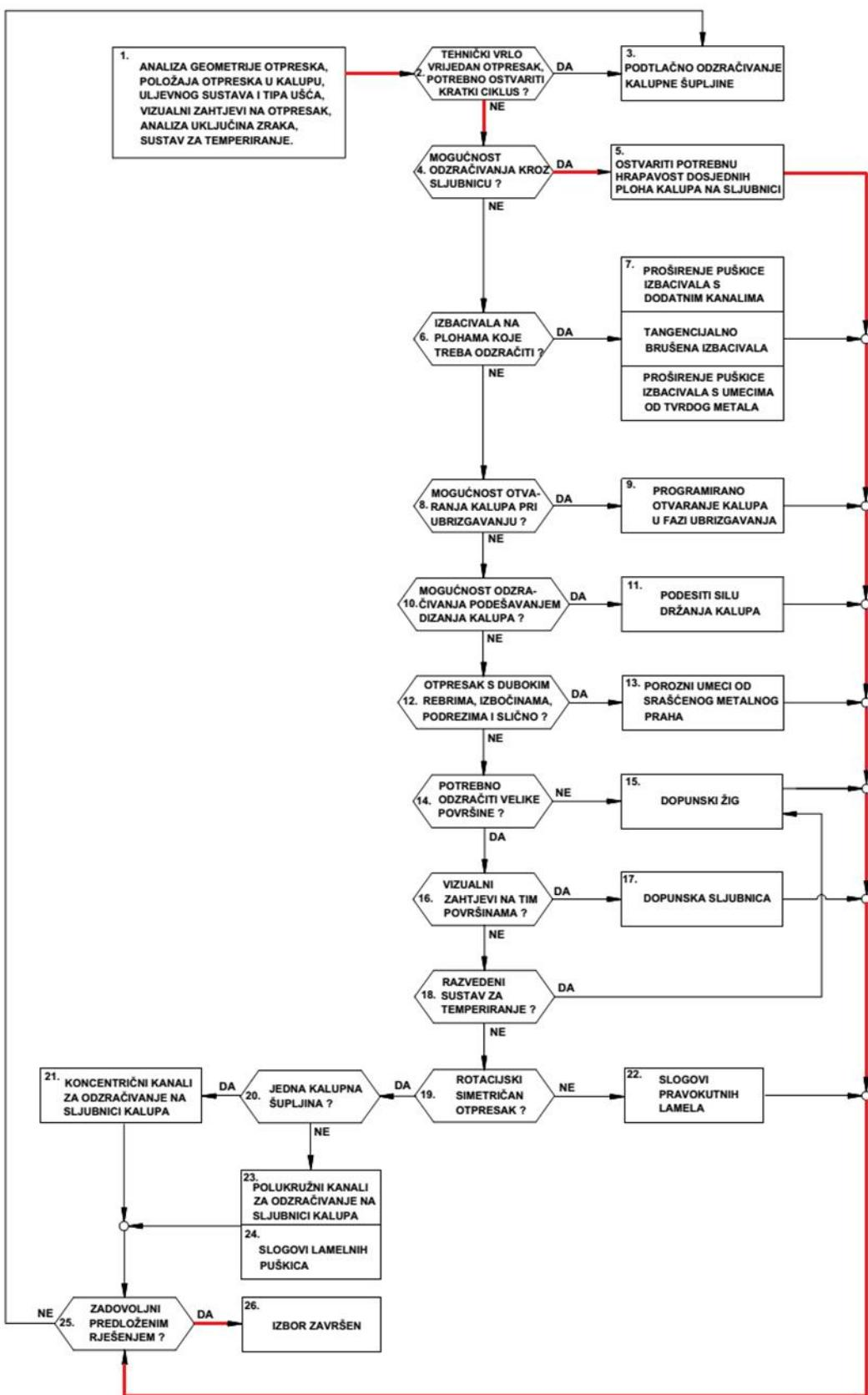
Slika 4.14. Dijagram odlučivanja za načelno određivanje sustava za odzračivanje kalupa [10]
