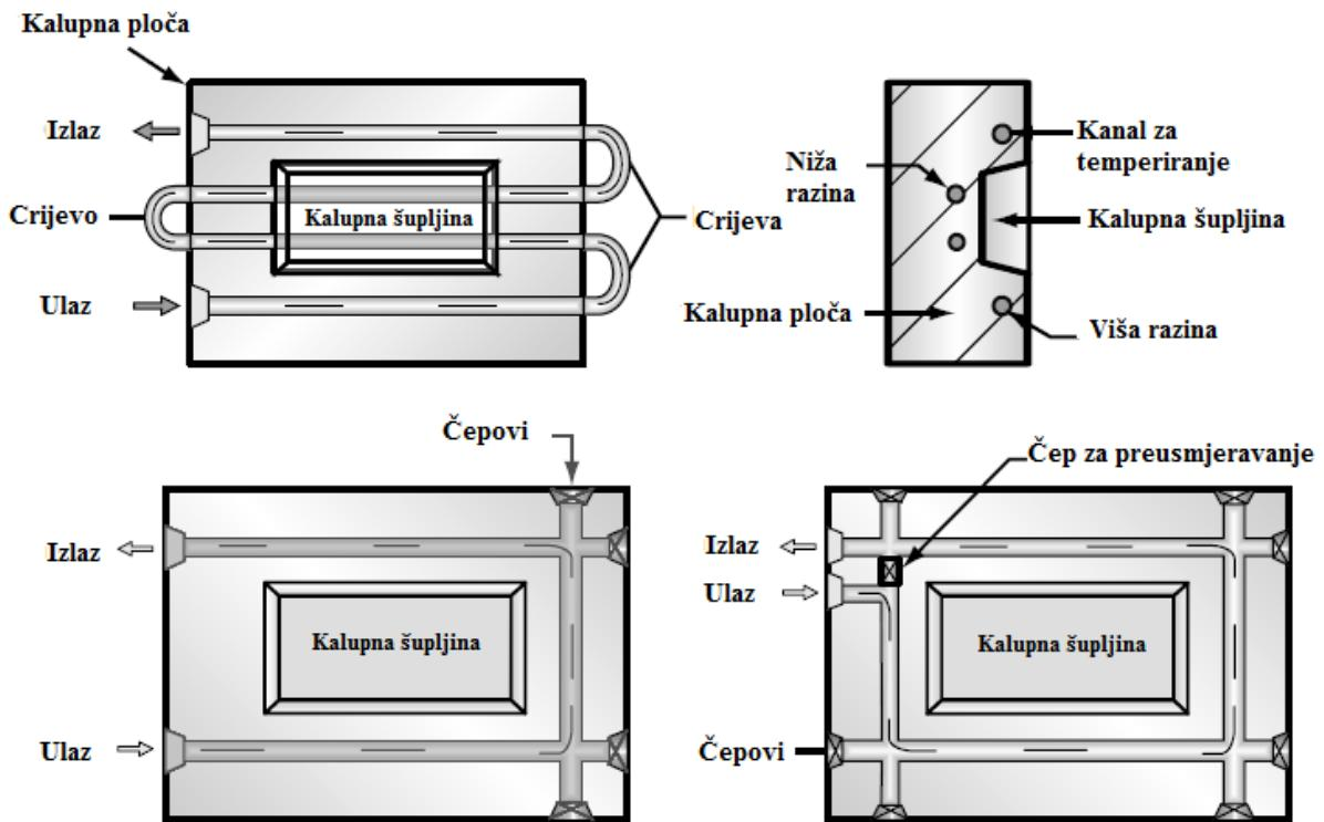
Slika 3.13. Krug za temperiranje ploča kalupa [4]
