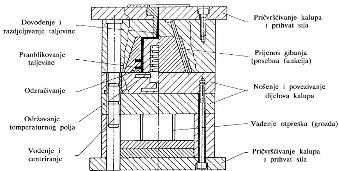
**Slika 3.2. Parcijalne funkcije kalupa za injekcijsko prešanje plastomera [10]**
