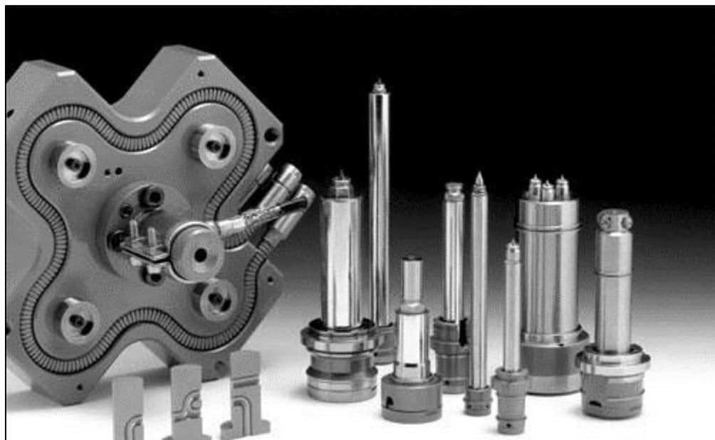
**Slika 3.10. Prikaz komponenti vrućeg uljevnog sustava [14]**
