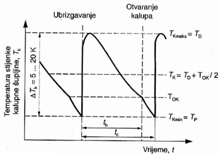
$t_h$  – vrijeme hlađenja,  $t_c$  – vrijeme ciklusa,  $T_D$  – dodirna temperatura,  $T_k$  – temperatura stijenke kalupne šupljine,  $T_p$  – početna temperatura,  $T_{OK}$  – temperatura u trenutku otvaranja kalupa
