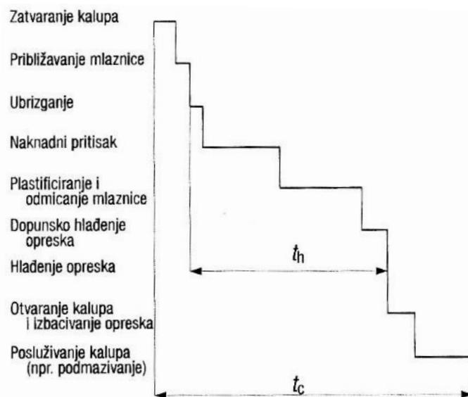
Slika 2.1. Trajanje pojedine faze injekcijskog prešanja plastomera [3]
