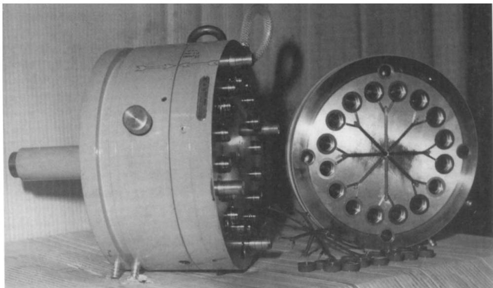
Slika 3.5. Okruglo kućište za izradu čepova s navojem [4]
