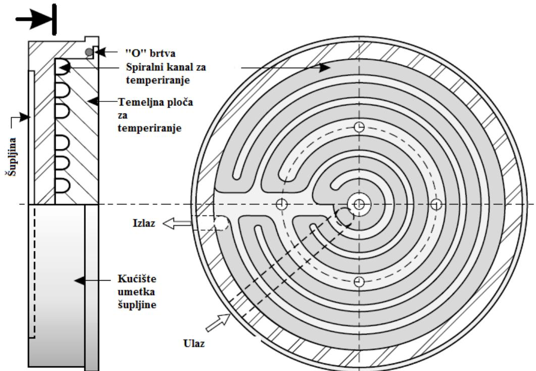
Slika 3.14. Primjer kružnog umetka i spiralnog kanala za temperiranje istoga [4]
