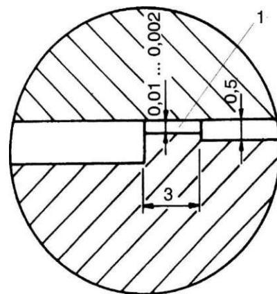
Slika 3.15. Primjer odzračivanja kalupne šupljine; 1 - kanal za odzračivanje [3]
