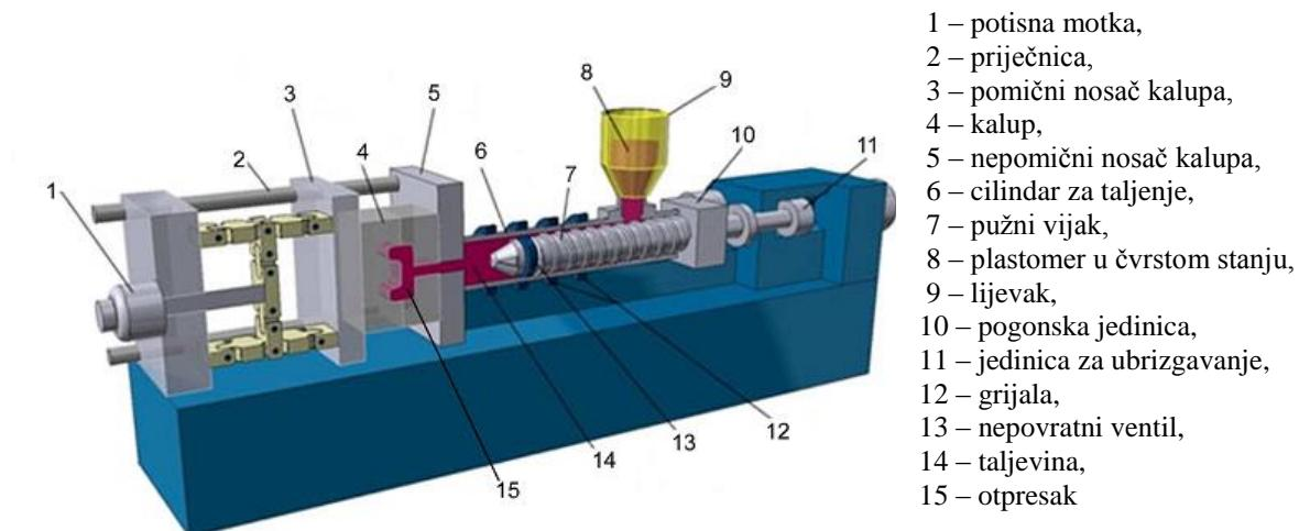
Slika 2.2. Presjek jedinica za ubrizgavanje te otvaranje i zatvaranje kalupa [2]
