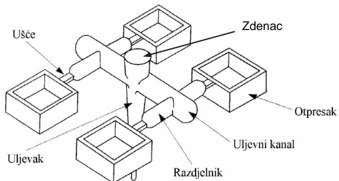
Slika 3.6. Elementi čvrstog uljevnog sustava [10]
