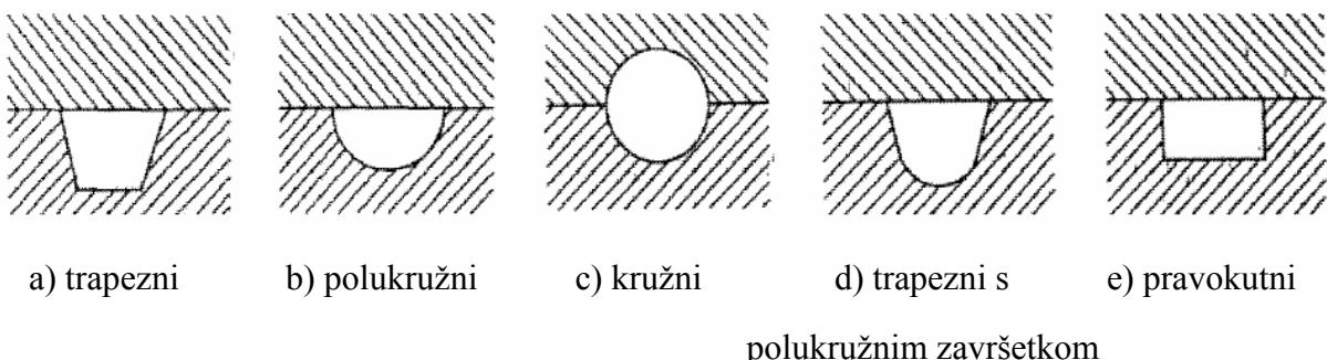
Slika 3.7. Poprečni presjek mogućih oblika uljevnog kanala [12]
