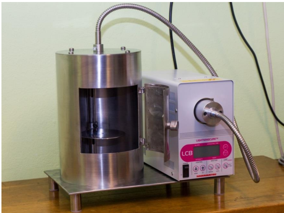
Slika 38. Uređaj za UV zračenje uzoraka Hamamatsu UV Spot Light LC8
