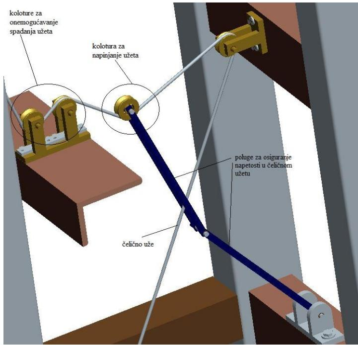
Slika 53 Sustav kolotura za napinjanje čeličnog užeta
