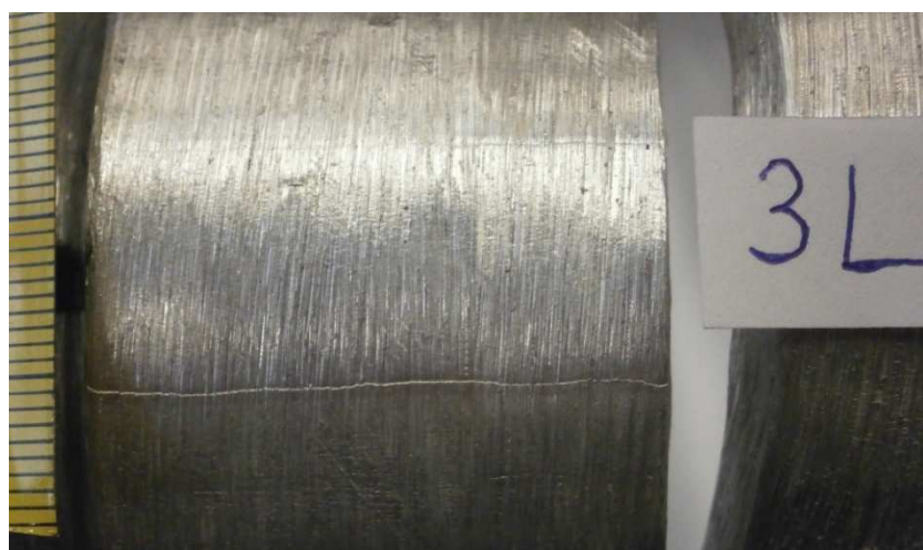
Slika 42. Uzorak 3 – lice zavara opterećeno na vlak
