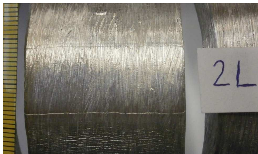
Slika 40. Uzorak 2 – lice zavora opterećeno na vlak
