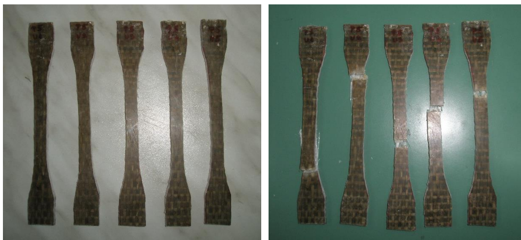
Slika 45. Epruvete prije i poslije ispitivanja rastezne čvrstoće uzorka 4
