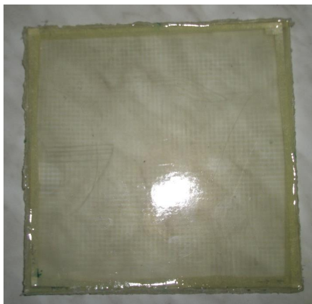
Slika 37. Kompozitna ploča ojačana s dva sloja stakla
