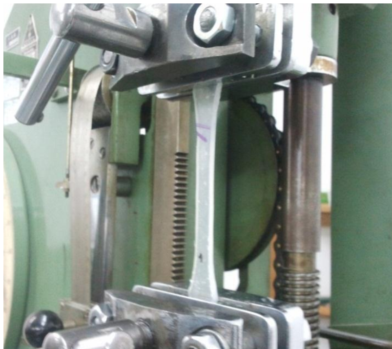
Slika 39. Kidanje epruvete prilikom statičkog rasteznog pokusa
