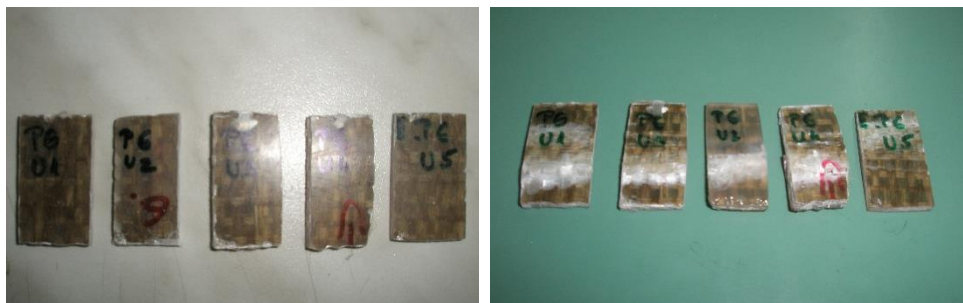
Slika 55. Epruvete prije i poslije ispitivanja međuslojne čvrstoće uzorka 5
