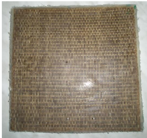
Slika 20. Kompozit ojačan s dva sloja lanenih vlakana
