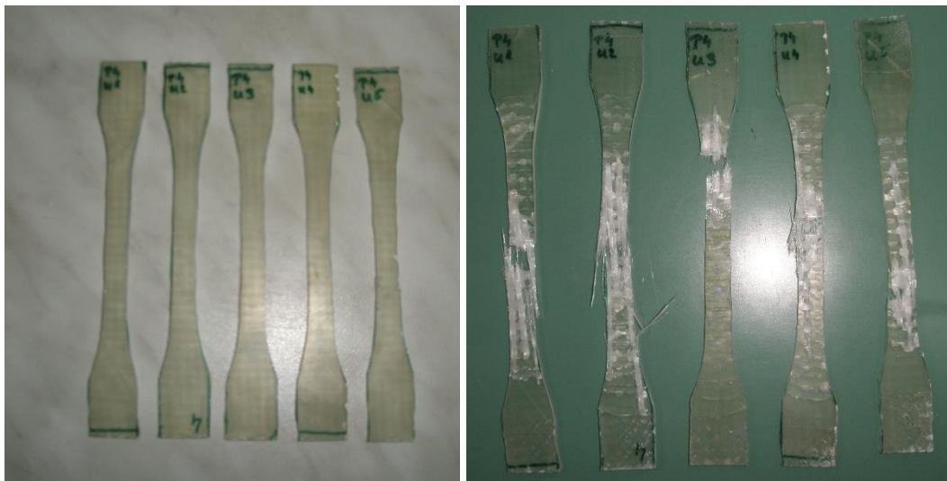
Slika 38. Epruvete prije i poslije ispitivanja rastezne čvrstoće
