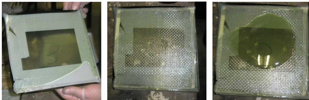
Slika 28. Lijevo- nanošenje smole na podlogu, sredina- polaganje vlakana, desno-nanošenje smole na položena vlakna
