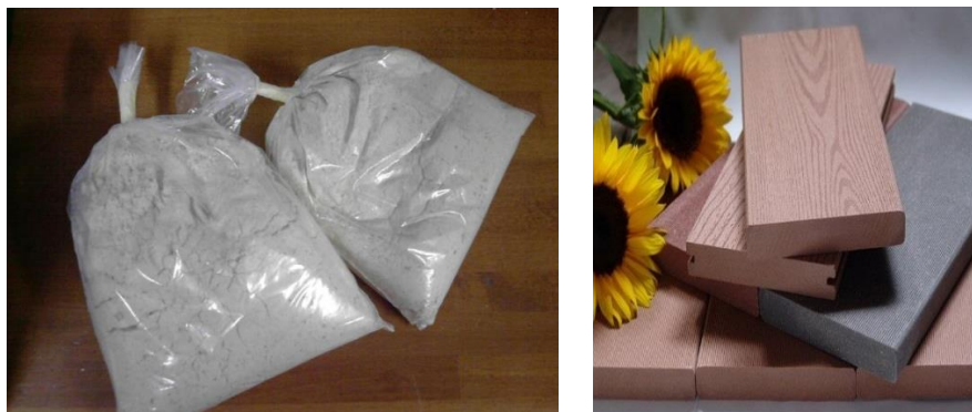
Slika 4. Lijevo drveno brašno, desno proizvodi ojačani drvnim brašnom [10]
