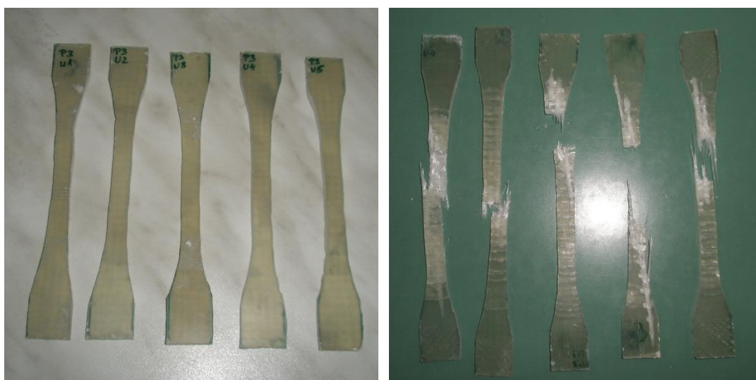
Slika 30. Epruvete prije i poslije rasteznog ispitivanja
