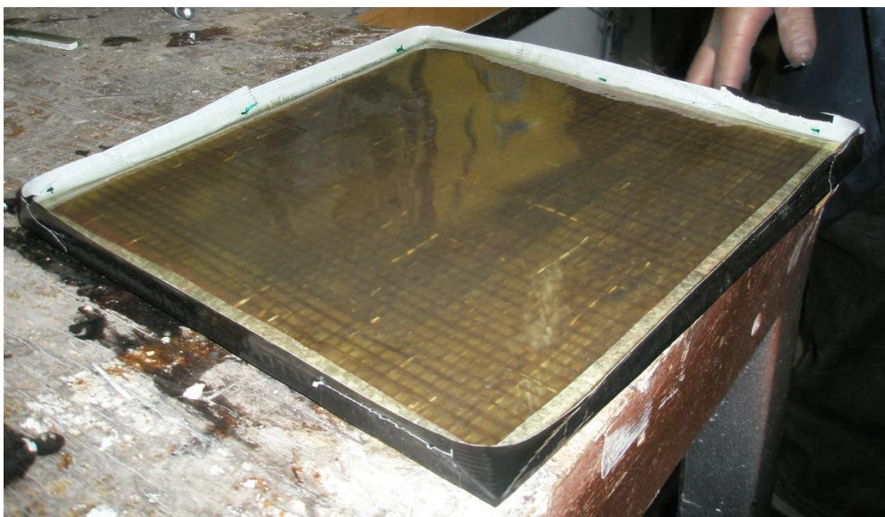
Slika 44. Kompozit ojačan staklenim i lanenim pletivom
