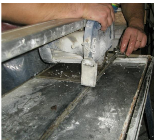
Slika 21. Rezanje rubova kompozita
