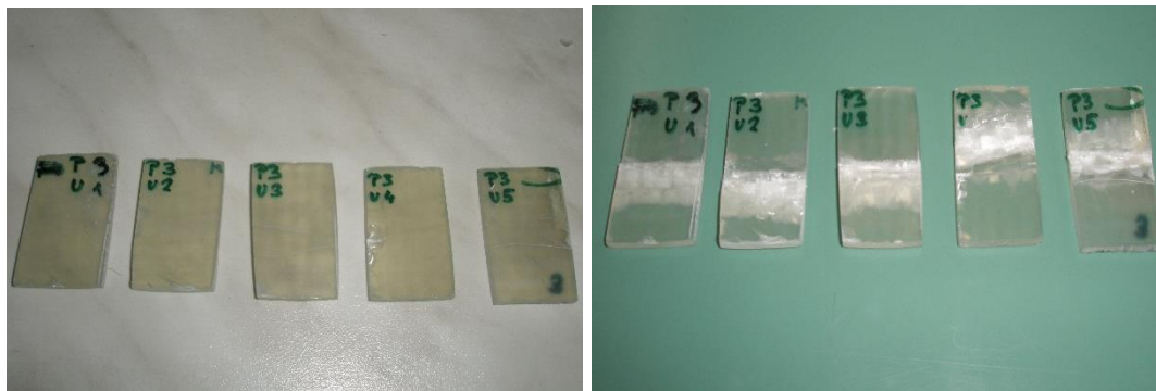
Slika 34. Epruvete prije i poslije ispitivanja međuslojne čvrstoće
