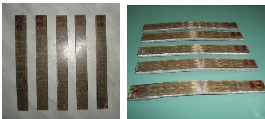
Slika 47. Epruvete prije i poslije ispitivanja savojne čvrstoće uzorka 4
