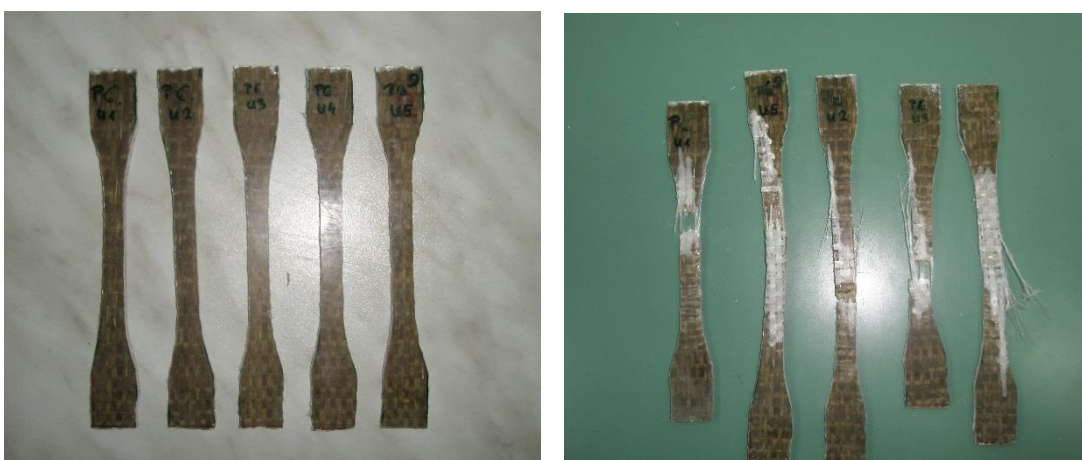
Slika 51. Epruvete prije i poslije ispitivanja rastezne čvrstoće uzorka 5
