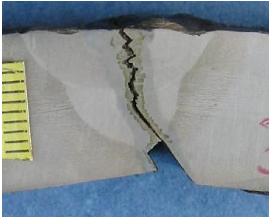
Slika 4.2.12 Makroizbrusak uzorka 33 sa unosom topline 18 kJ/cm
