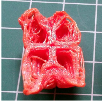
Slika 3.27 Rezultat prevelike brzine printanja [45]
