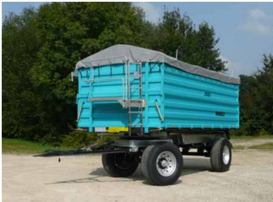
Slika 6. Prikolica sa okretnom prednjom osovinom, ceradom i ljestvama [2]
