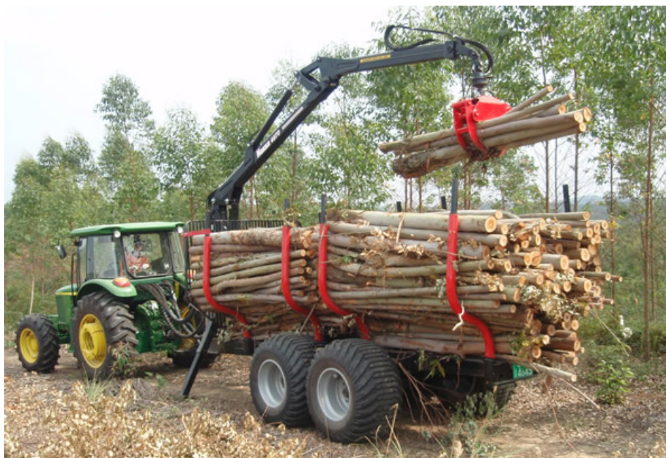
Slika 12. Šumska traktorska prikolica s dizalicom u radu [6]
