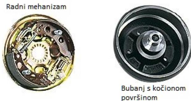
**Slika 33. Glavni dijelovi kočionog sklopa[19]**
