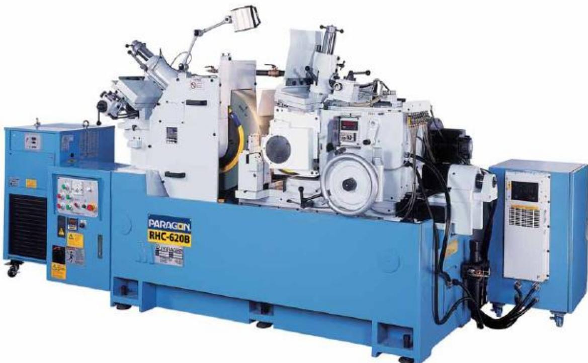
Slika 25. Visokobrzinska kružna brusilica za obradu bez šiljaka [17]
