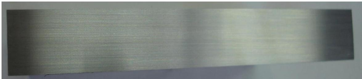
Slika 38. Površina obratka materijala 1.2842 bez pogreška brušenja
