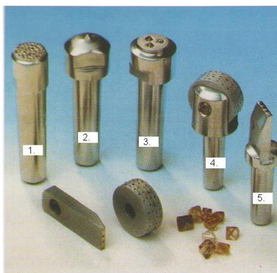
Slika 13. Prikaz alata za obradu rezne površine brusa [9]
