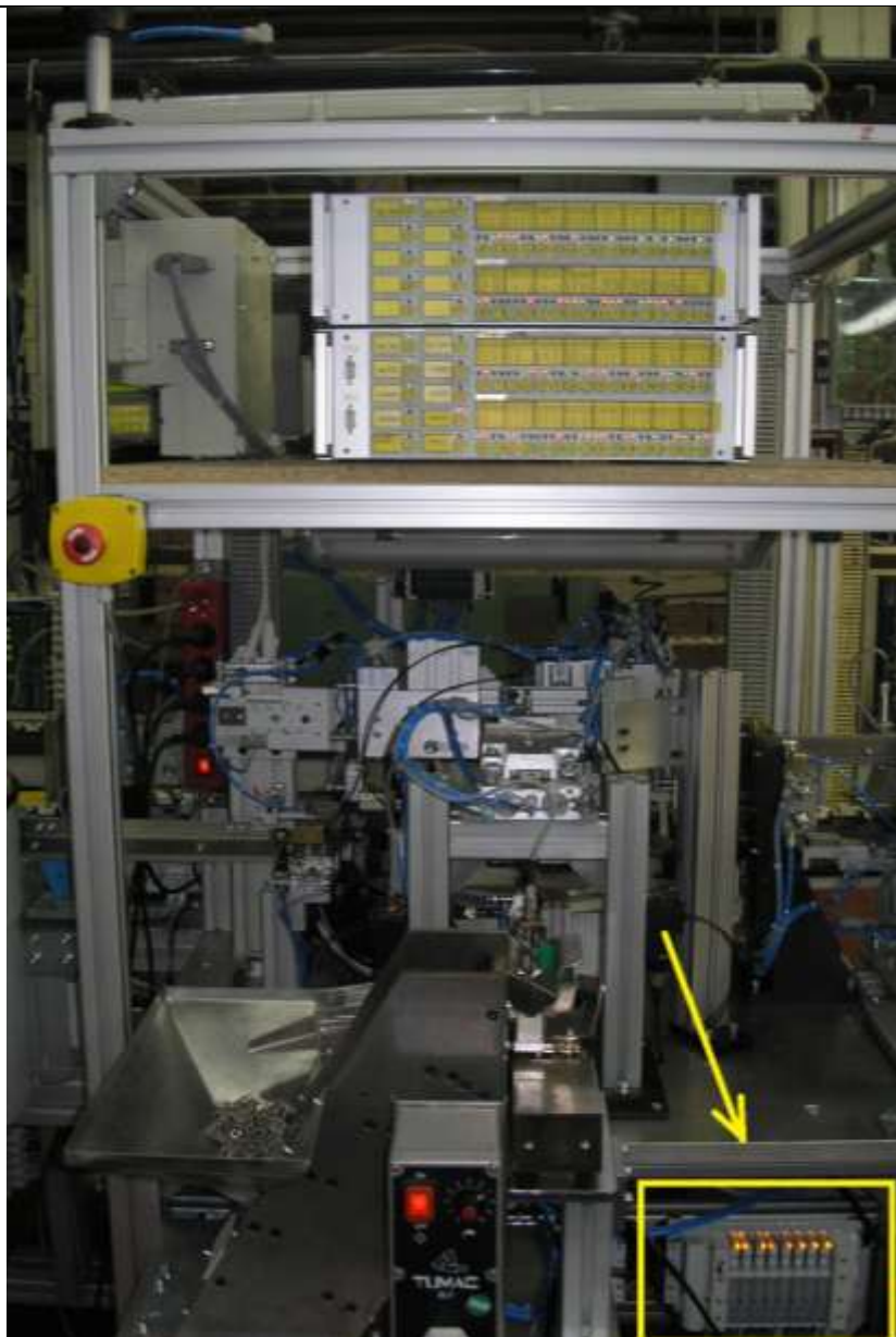
Slika 20. Lokacija ventilskeg bloka na automatu
