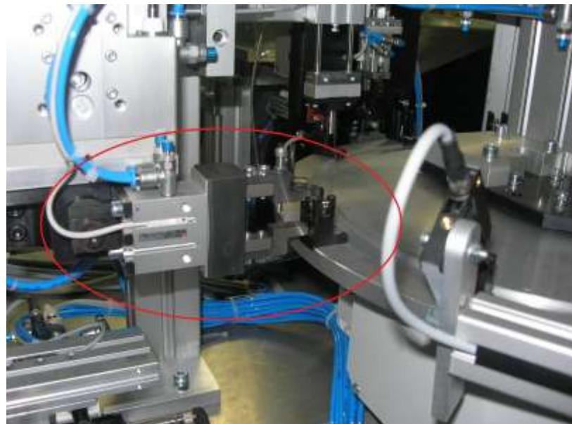
Slika 28. Prihvatanje i vađenje montažnog sklopa iz gnijezda na okretnom stolu
