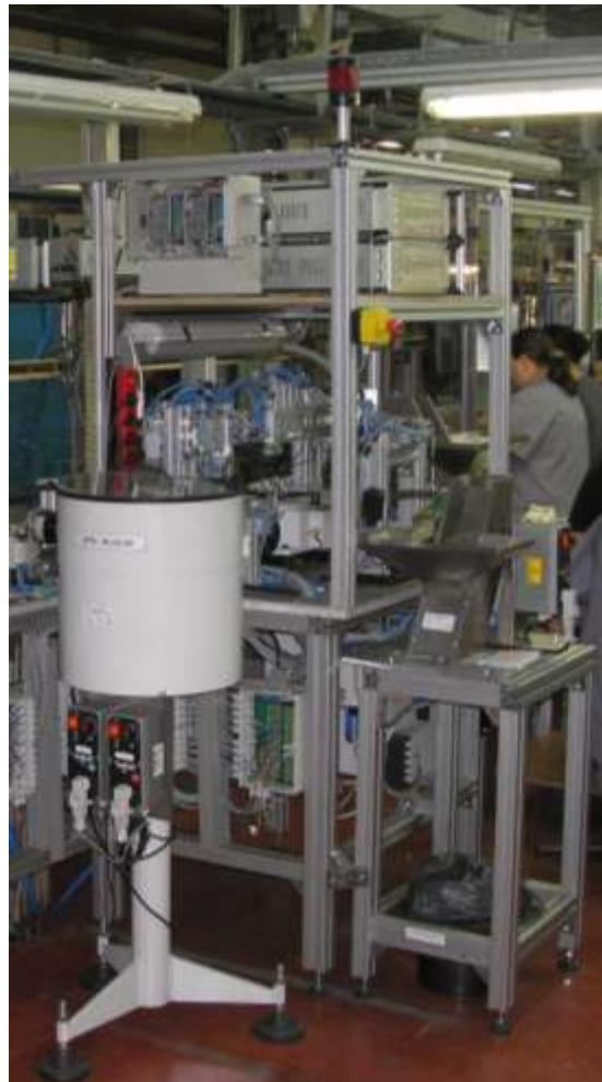
Slika 5. Automat za montažu čahure, opruge i ležaja
