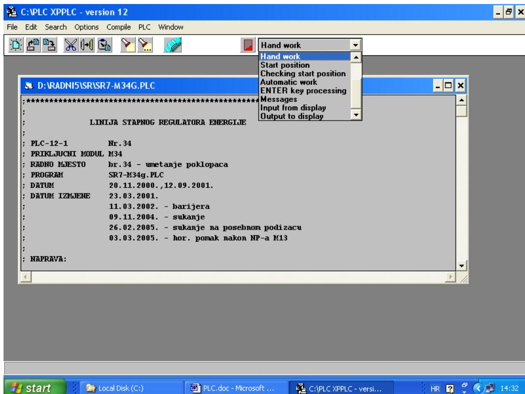
**Slika 25. Programsko sučelje softvera WinPLC za programiranje PLC-12 programabilnih logičkih kontrolera**
