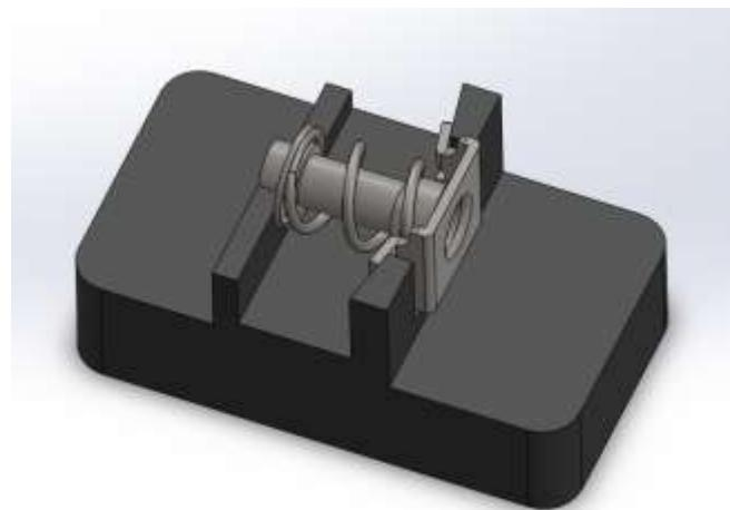
Slika 8. Montažni sklop umetnut u transportno kućište
