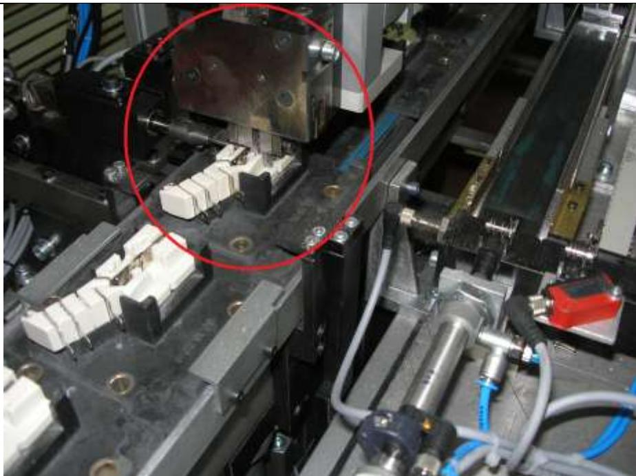
**Slika 31. Umetanje montažnog sklopa u štapni limiter**
