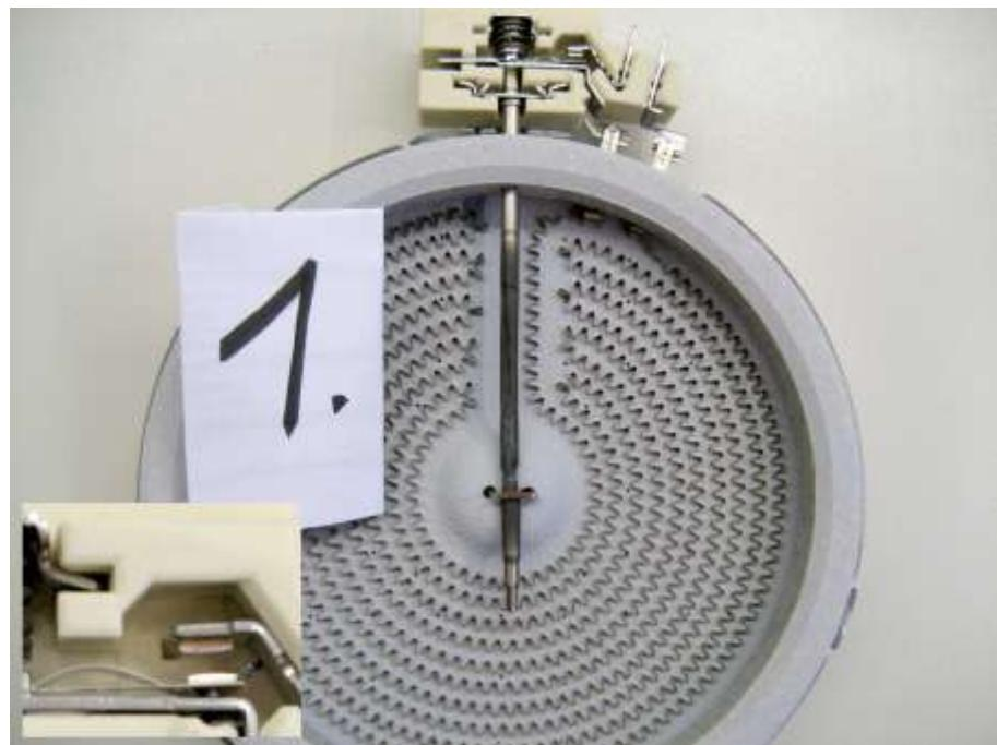
Slika 3. Primjena štarnog limitera u grijajućoj ploči
