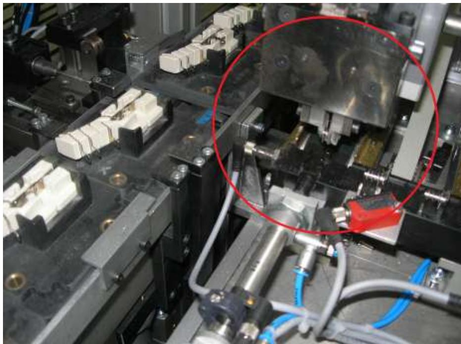
Slika 30. Prihvatanje i vađenje montažnog sklopa iz transportnog kućišta
