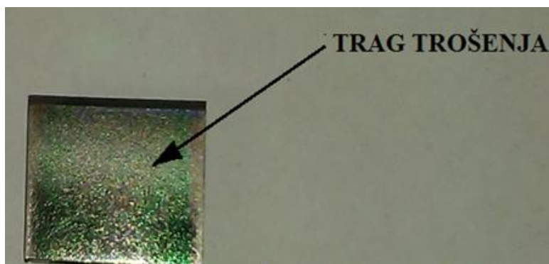
Slika 51. Izgled uzorka nakon provedenog postupka erozijskog trošenja
