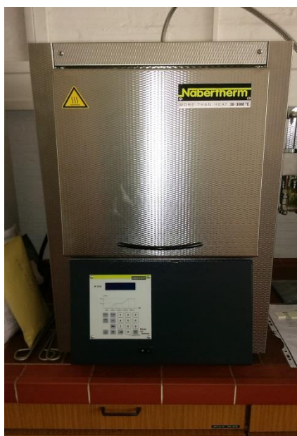
Slika 25. Peć u kojoj su uzorci kalcinirani
