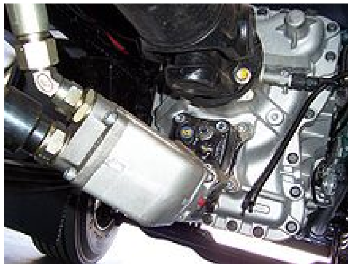
Slika 6. Prikaz PTO modula [5]
