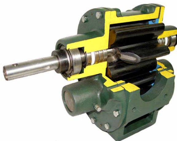
Slika 14. Zupčasta pumpa s vanjskim ozubljenjem u presjeku [10]
