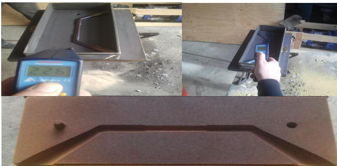
Slika 37. Temperature ploče i epruvete, školjka
