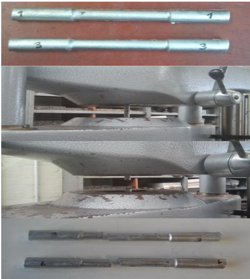
Slika 50. Epruvete, prije, za vrijeme i nakon kidanja
