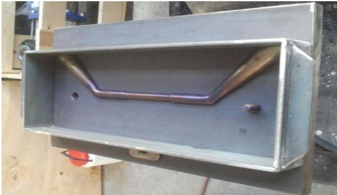
Slika 33. Dopravljeni alat za školjkasti lijev sa montiranim okvirom
