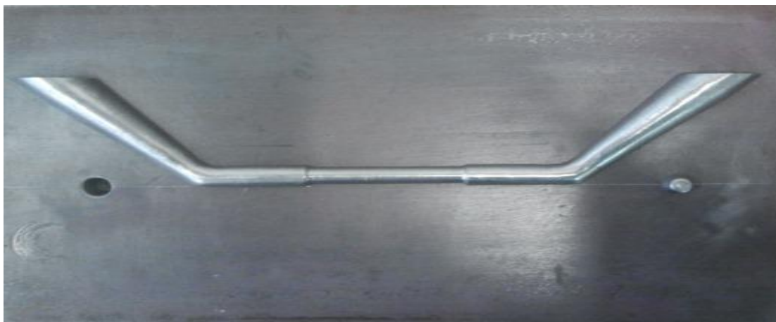
Slika 32. Gotov alat sa zaticima za centriranje
