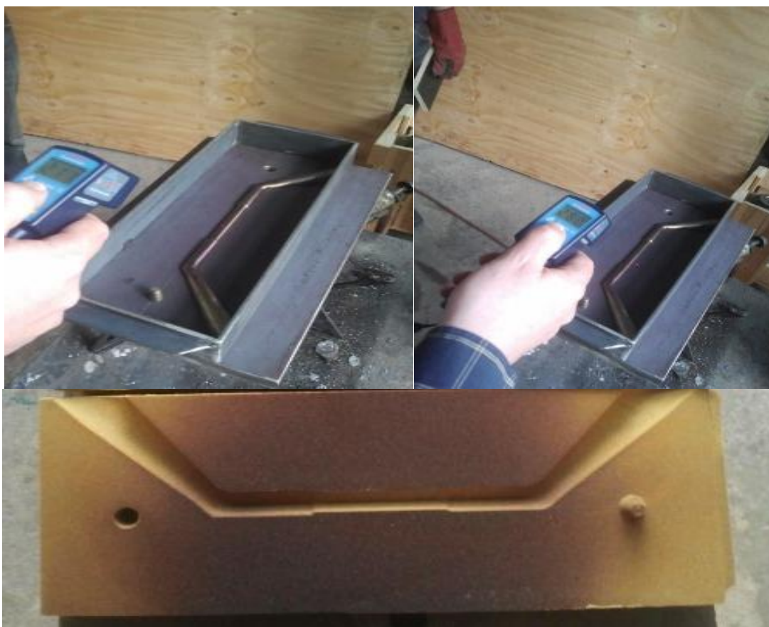
Slika 36. Temperatura ploče i epruvete, školjka
