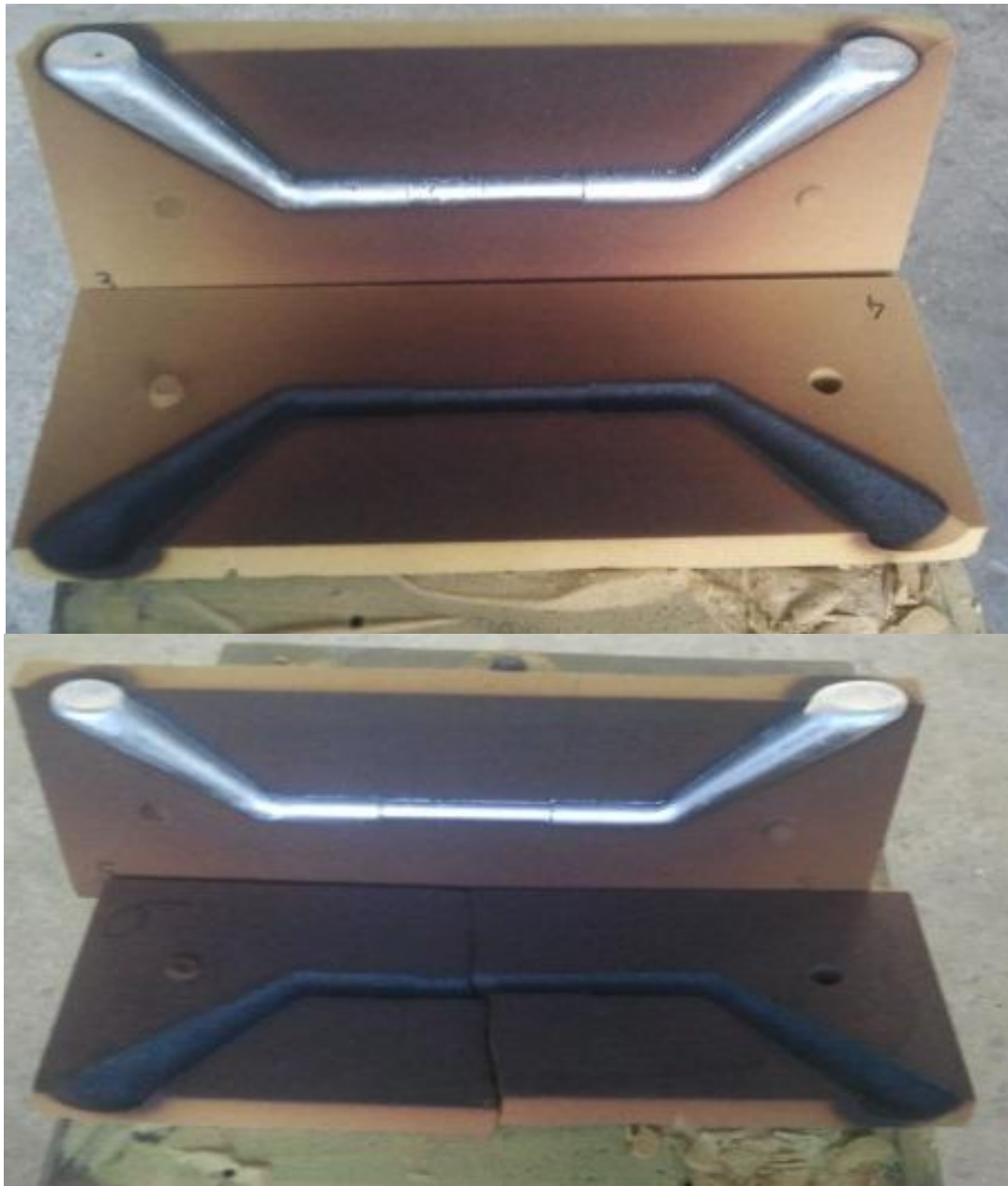
Slika 45. Odljevci i školjke tokom hlađenja
