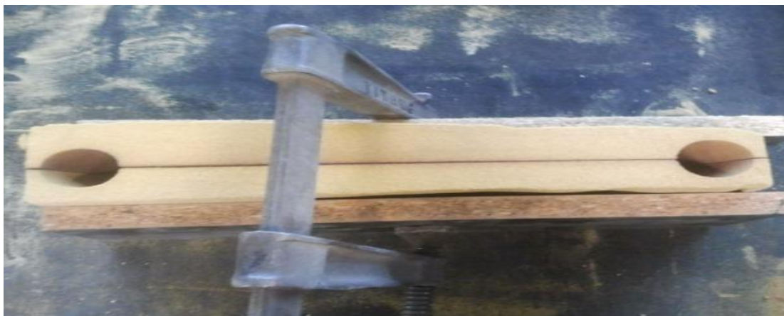
Slika 41. Oblaganje i stezanje kalupa
