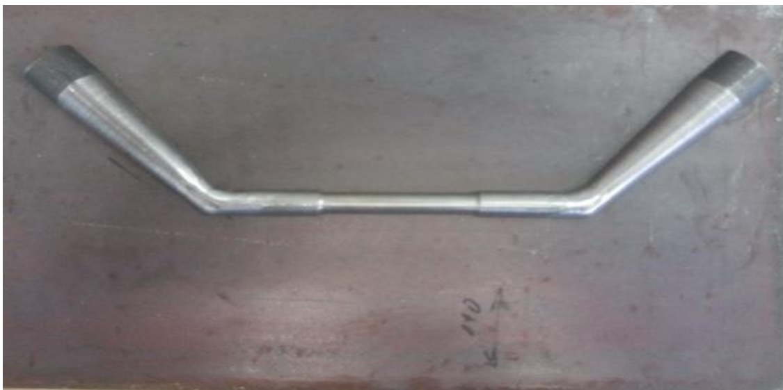
Slika 31. Montaža epruvete na ploču
