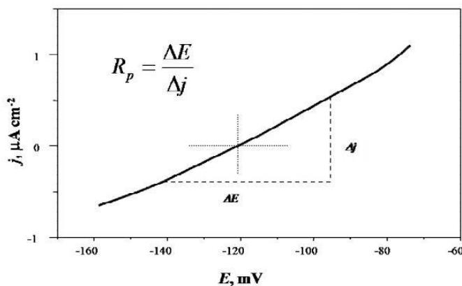
Slika 18. Određivanje polarizacijskog otpora prema F. Mansfeldu [8]
