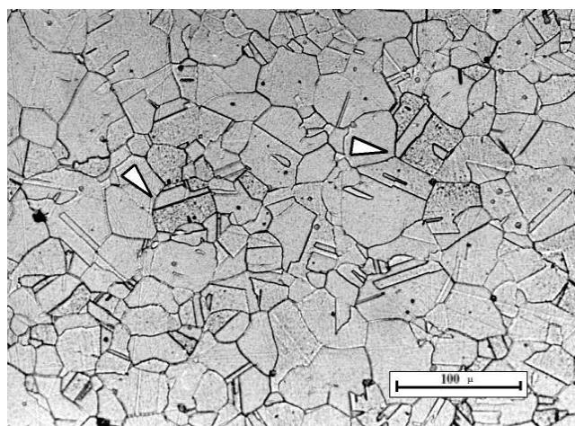
Slika 1. Mikrostruktura austenitnog nehrđajućeg čelika [2]
