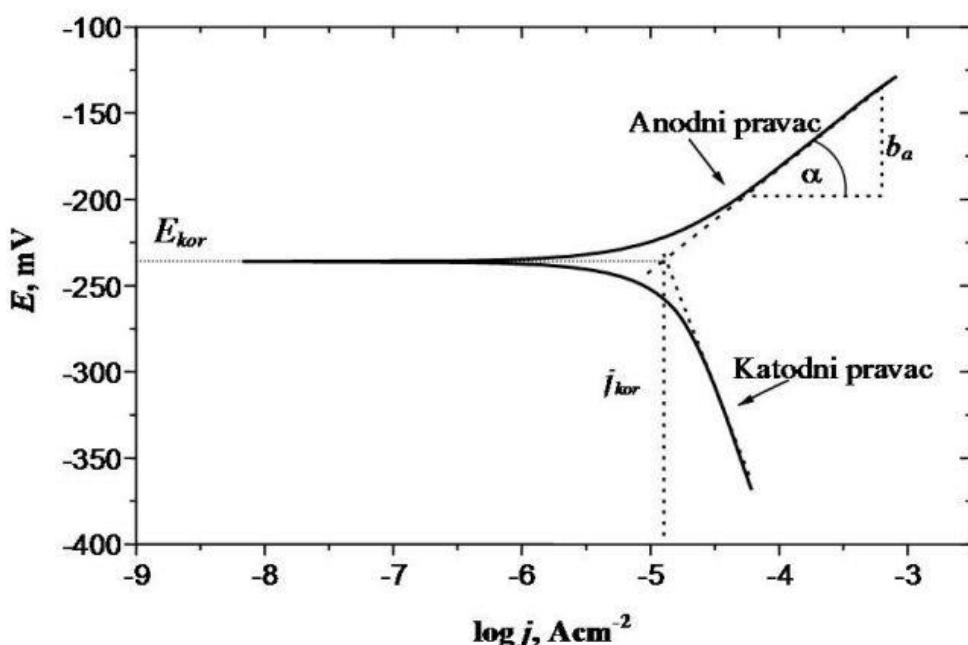
Slika 19. Princip anodno - katodne polarizacije [8]
