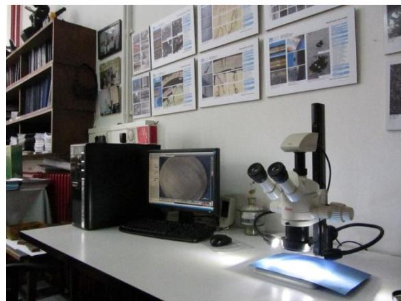
Slika 24. Stereomikroskop model Leica MZ6
