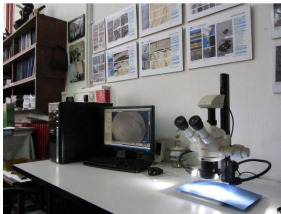
Slika 24. Stereomikroskop model Leica MZ6
