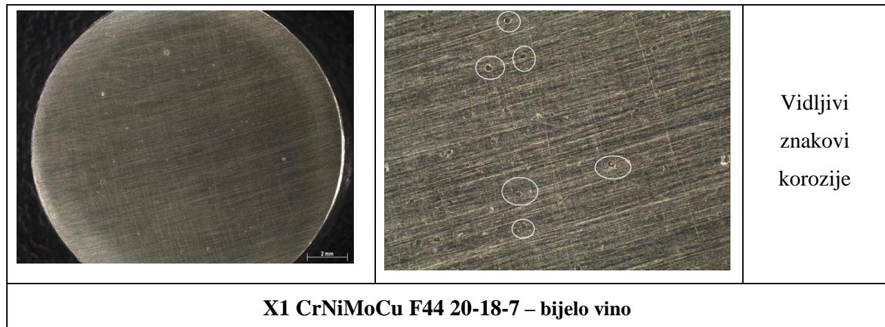
Slika 30. Makrostruktura ispitanih čelika u bijelom vinu
