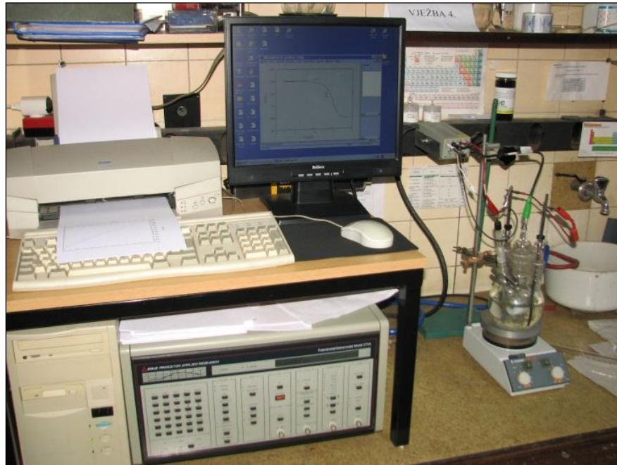
Slika 21. Potencijostat/Galvanostat model 273A
