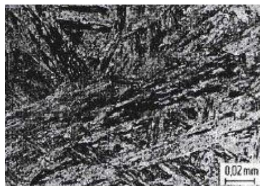
Slika 7. Mikrostruktura martenzitnog nehrđajućeg čelika [2]
