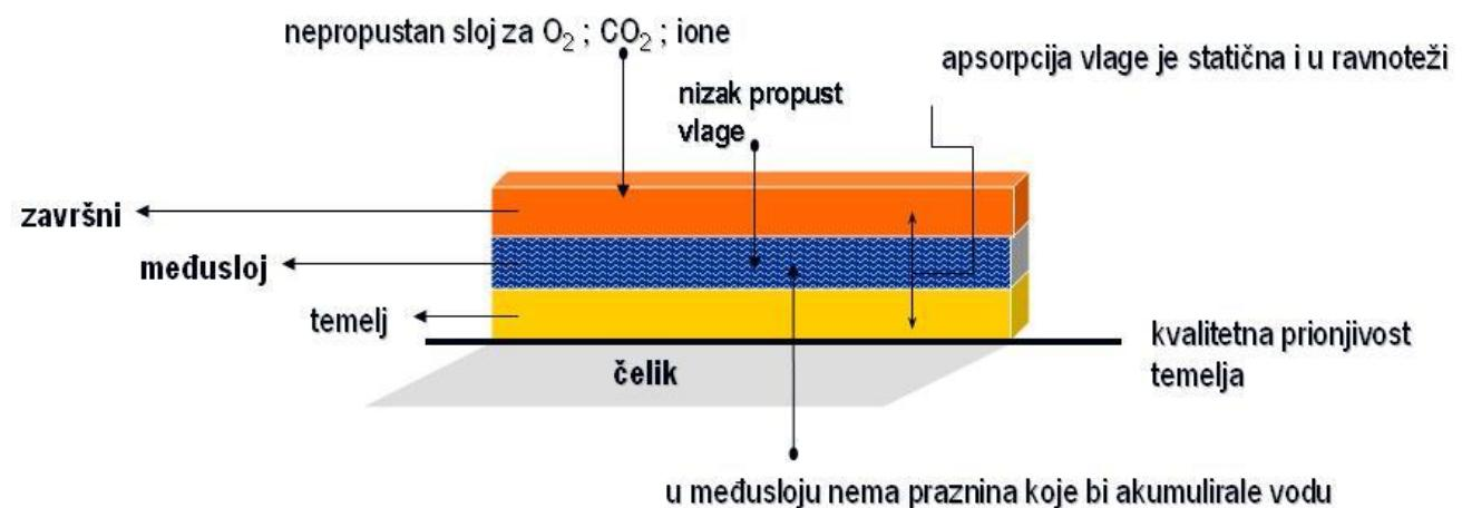
**Slika 7. Sustav zaštite čelika na osnovi nepropusnosti [6]**
