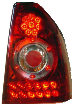
Slika 5.6. Žmigavac od ABS-a [19]
