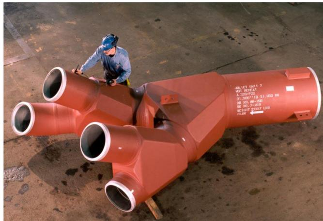
**Slika 3. Ultrazvučno ispitivanje [5]**
