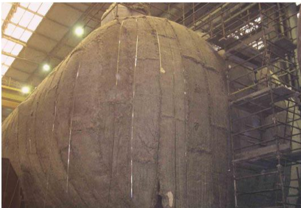
Slika 2. Toplinska obrada tlačnog kotla [5]
