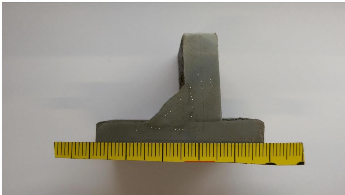
**Slika 22. Ispitivanje tvrdoće – makro uzorak 1**
