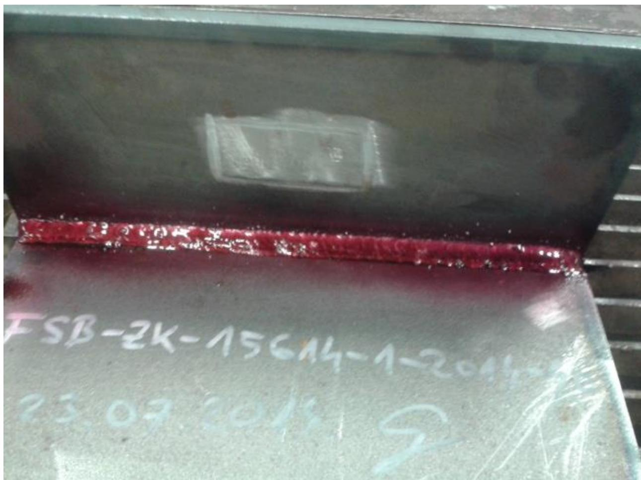
**Slika 16. Penetrant na zavaru**
