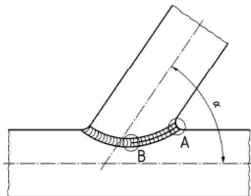
A - uzorak za makroskopsko ispitivanje i ispitivanje tvrdoće
