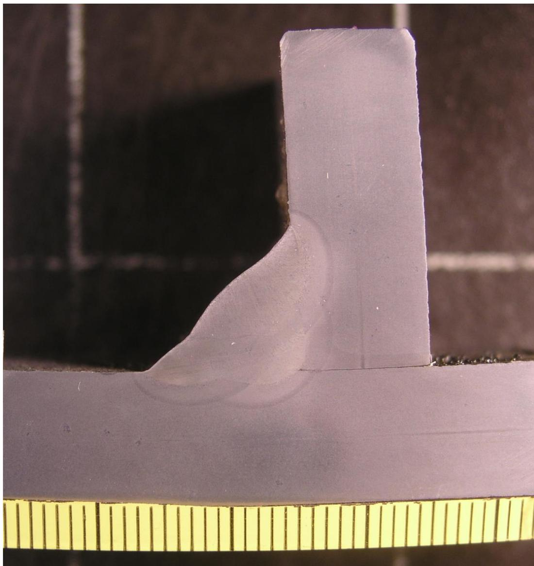
**Slika 19. Makro uzorak 1 nakon poliranja**
