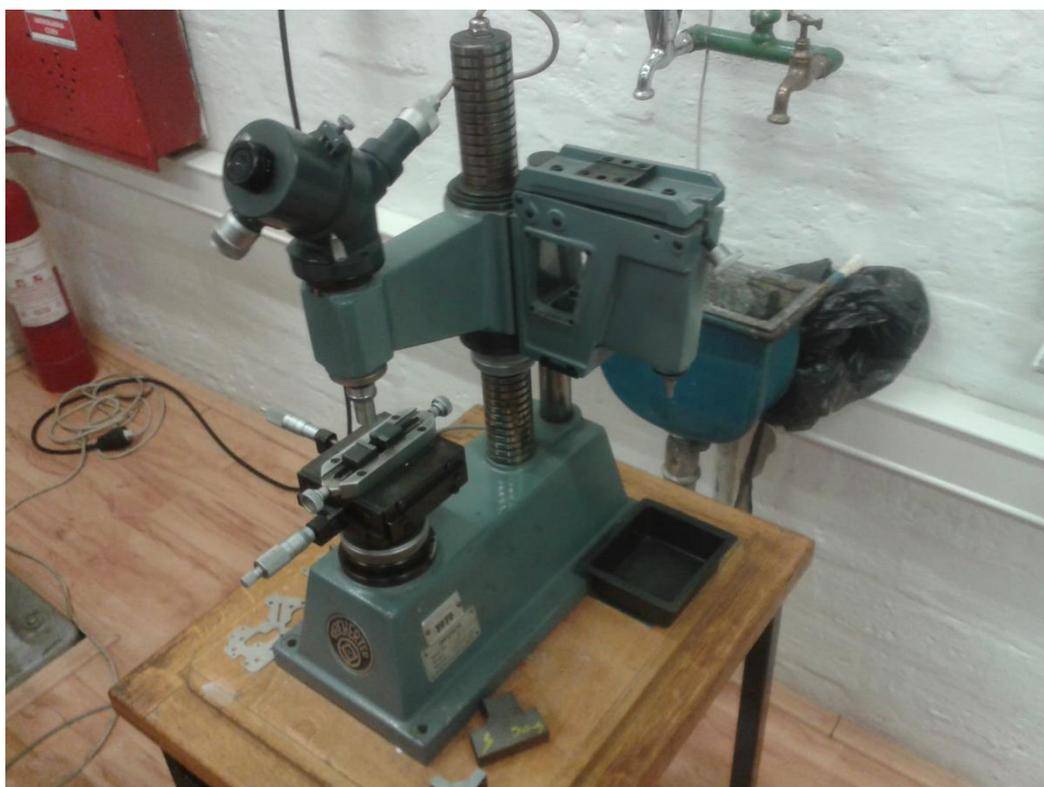
**Slika 21. Uređaj za mjerenje tvrdoće po Vickersu**
