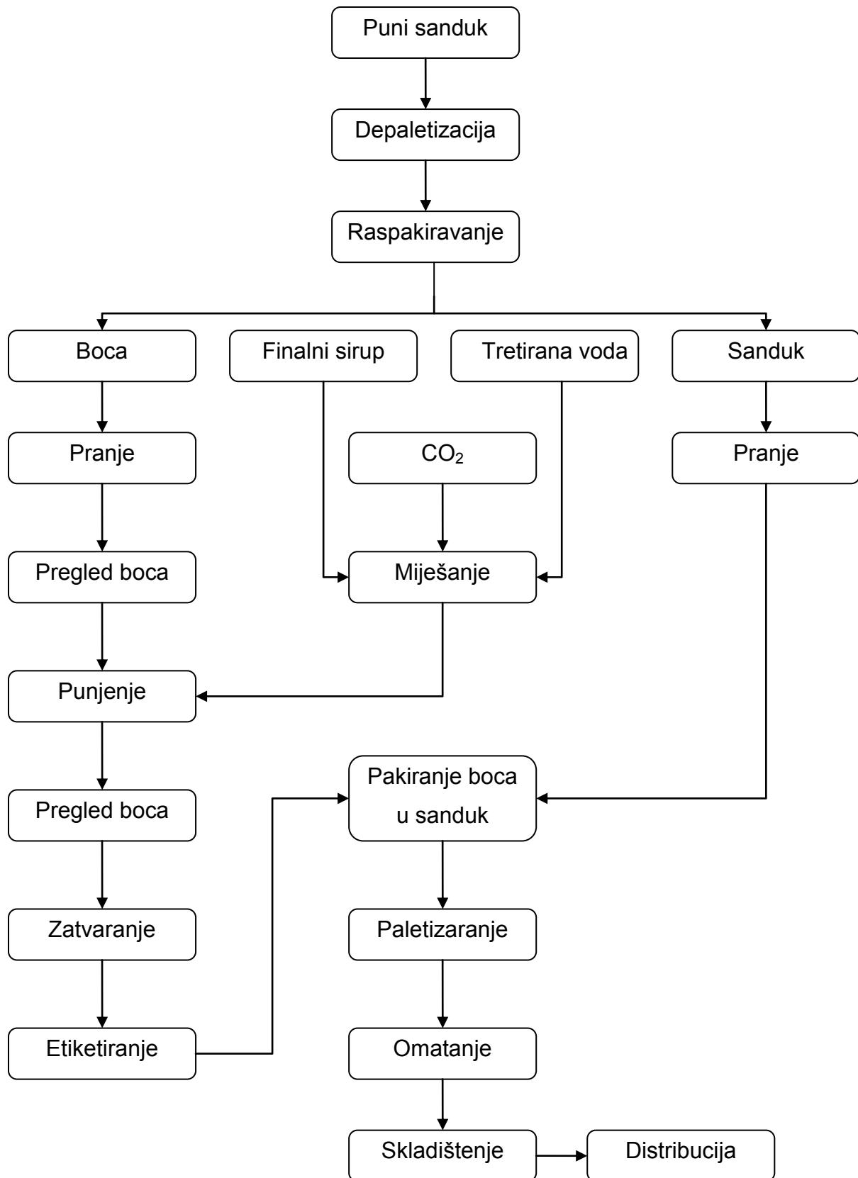
Slika 5.13. Shematski prikaz rada RGB linije [3]
