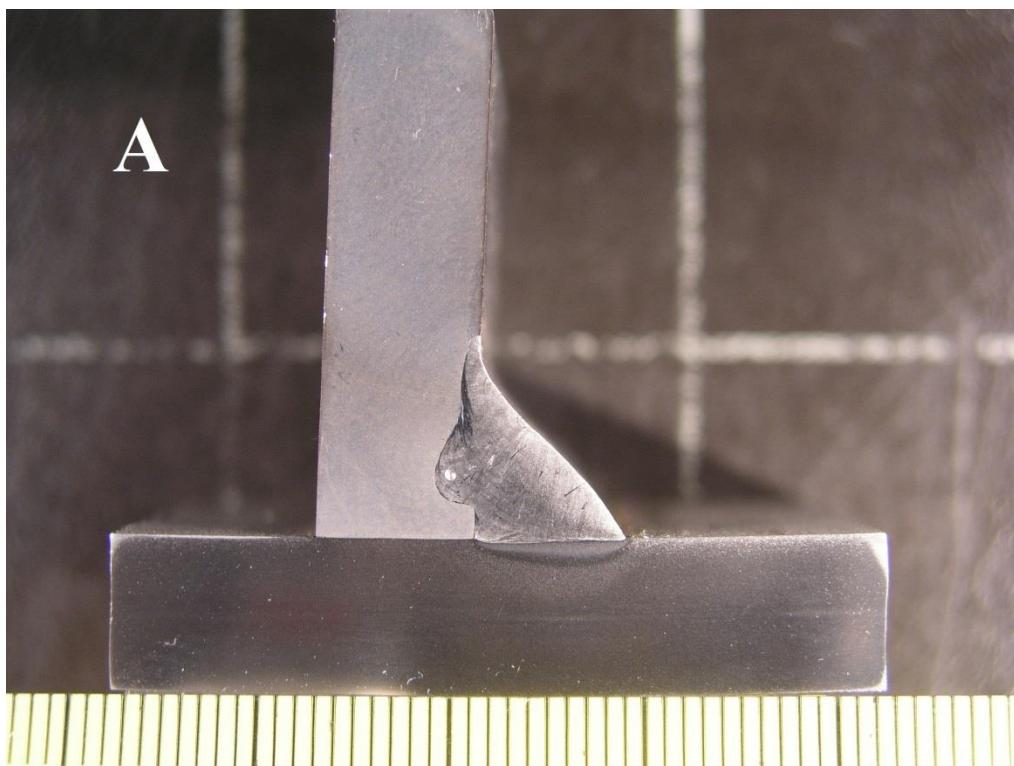
**Slika 19. Makro izbrusak presjeka zavara – uzorak A**
