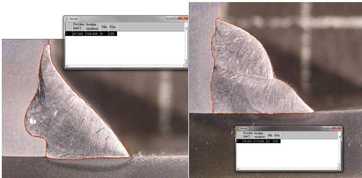
Slika 26. Prikaz mjerenja površine presjeka zavara. Uzorak A – lijevo, uzorak B – desno
