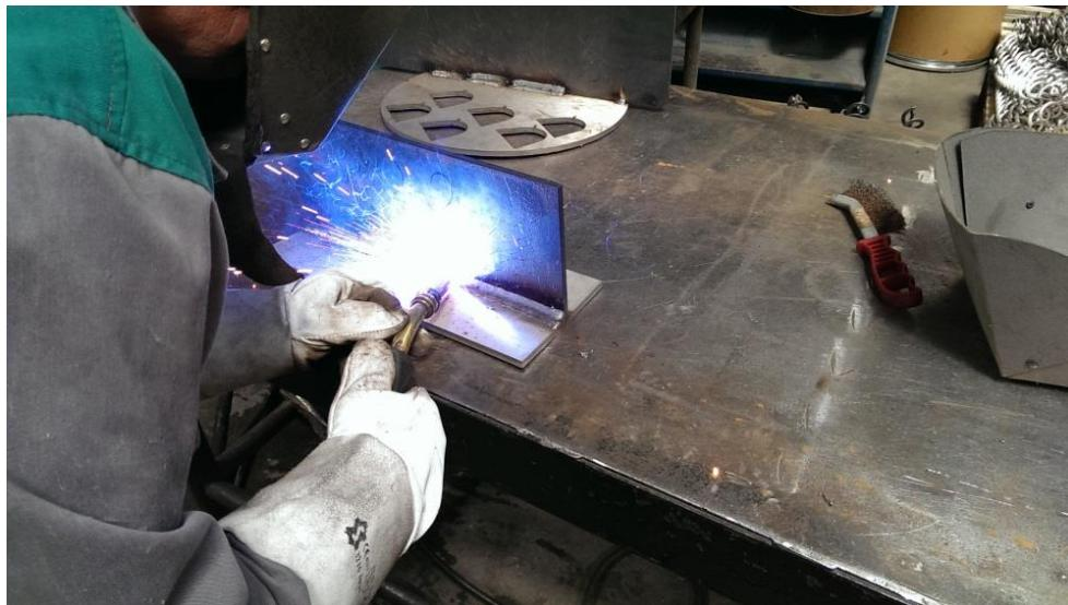
**Slika 15. Zavarivanje ispitnog uzorka s tri prolaza**
