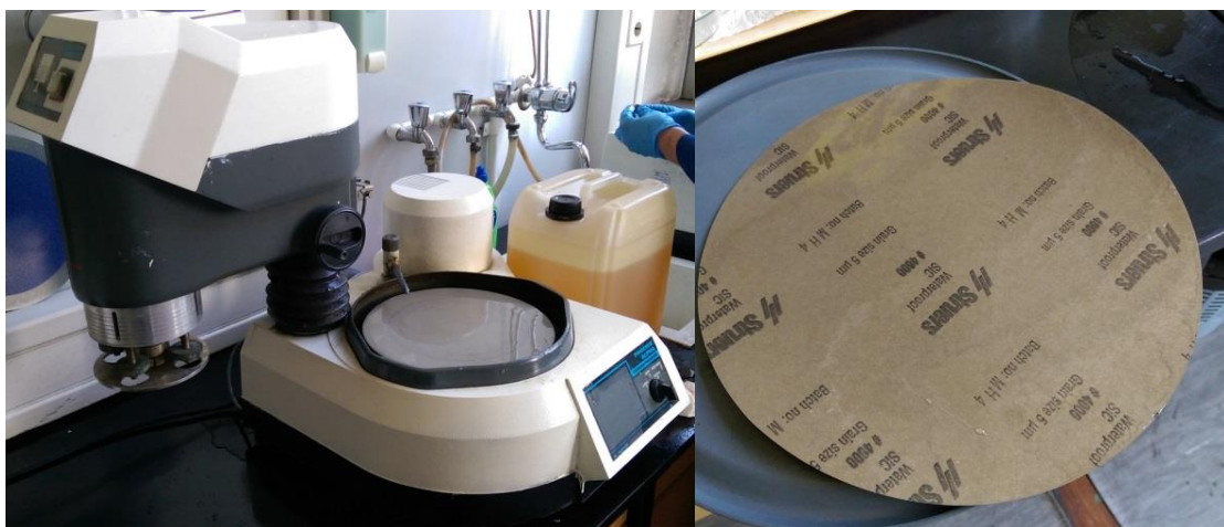
Slika 18. Stroj za poliranje izrezanih ispitnih uzoraka – lijevo, brusni papir hrapavosti #4000 – desno
