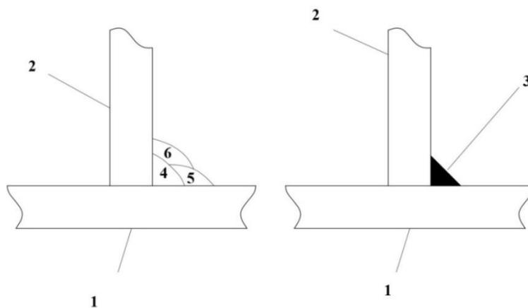
**Slika 22. Prikaz zavara i osnovnih materijala na makro izbruscima za mjerjenje feritnog broja**
