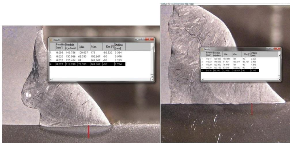
**Slika 27. Prikaz mjerjenja srednje vrijednosti dubine ZUT – a na strani 1.4828 X15CrNiSi20-12 osnovnog materijala. Uzorak A – lijevo, uzorak B – desno**
