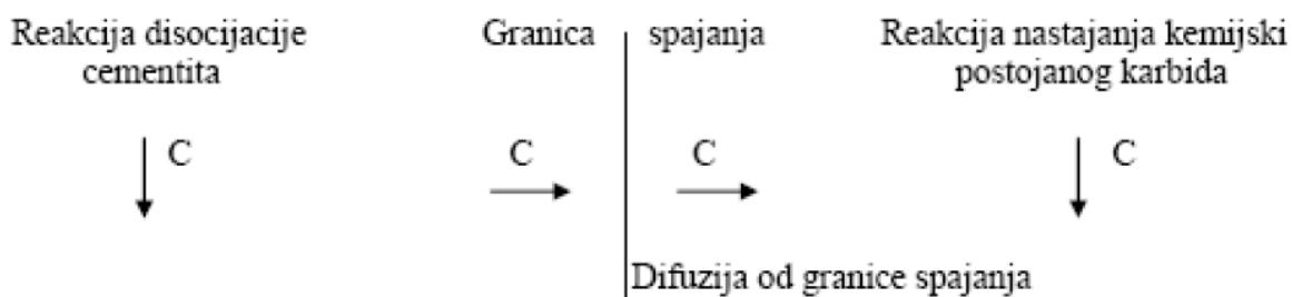
**Slika 8. Difuzija ugljika prilikom zavarivanja ugljičnog čelika s austenitnim čelikom [15]**
