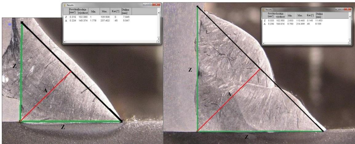
Slika 25. Prikaz mjerenja visine zavara. Uzorak A – lijevo, uzorak B - desno
