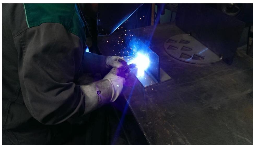
**Slika 14. Zavarivanje ispitnog uzorka s jednim prolazom**
