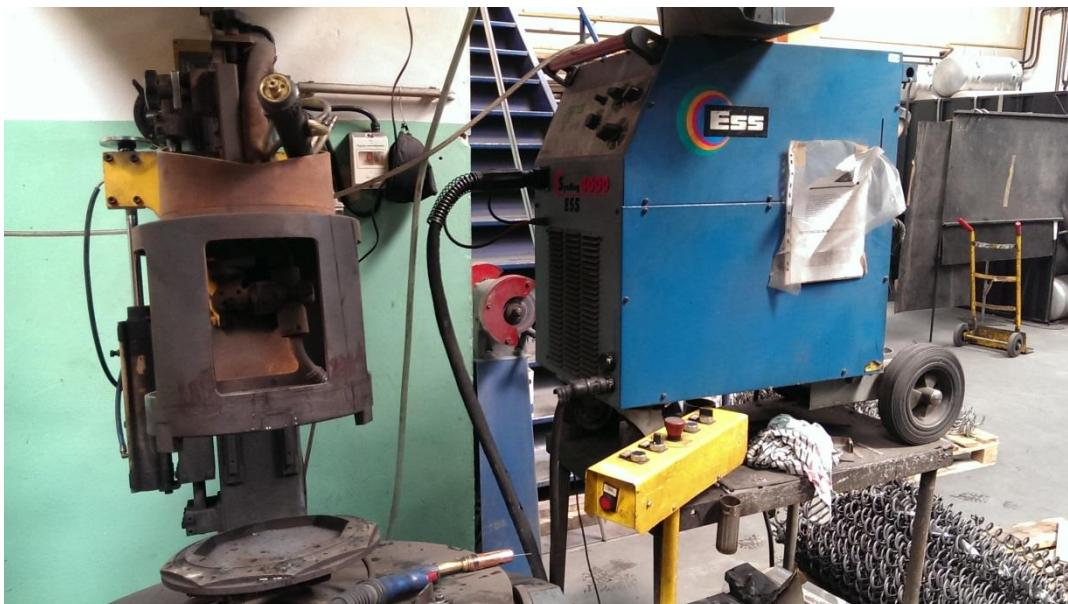
Slika 11. Izvor struje za zavarivanje ESS SynMag 4000
