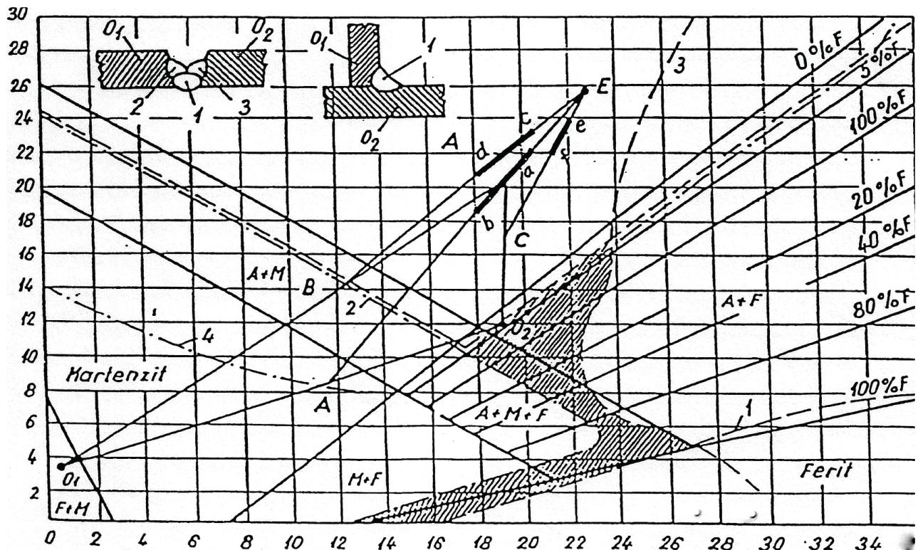
**Slika 6. Primjena Schaefflerovog strukturnog dijagrama pri određivanju kemijske i strukturne heterogenosti slojeva zavara [8]**
