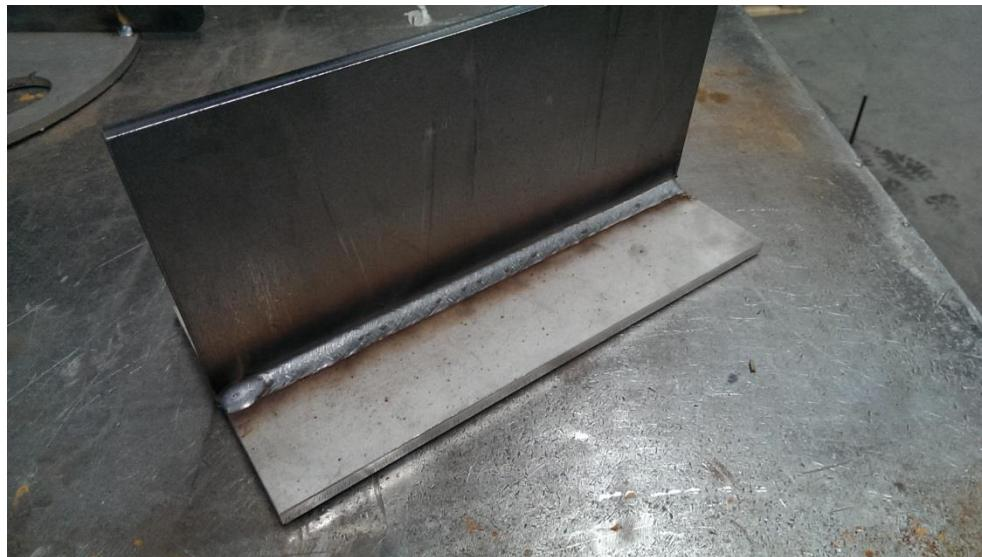
**Slika 16. Zavareni ispitni uzorak s jednim prolazom**
