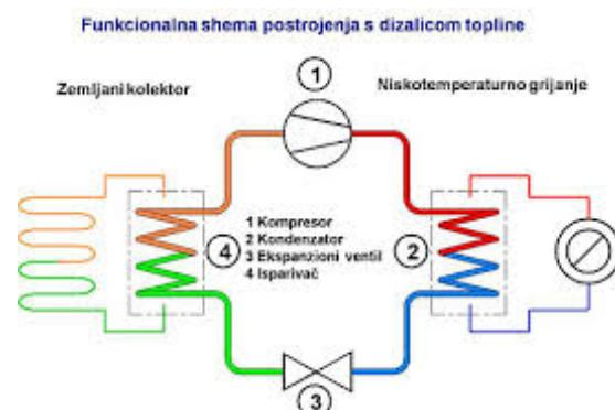
Slika 1.3 Princip rad dizalice topline (1.kompressor, 2.kondenzator, 3.eksanzisjski ventil, 4. isparivač)
