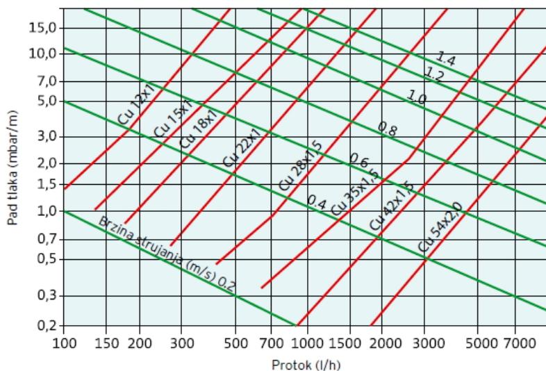
Slika 6.5 Pad tlaka u bakrenoj cijevi 60 % voda 40 % glikol
