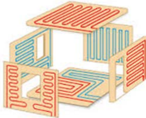
Slika 1.2 Površinsko grijanje ili hlađenje
