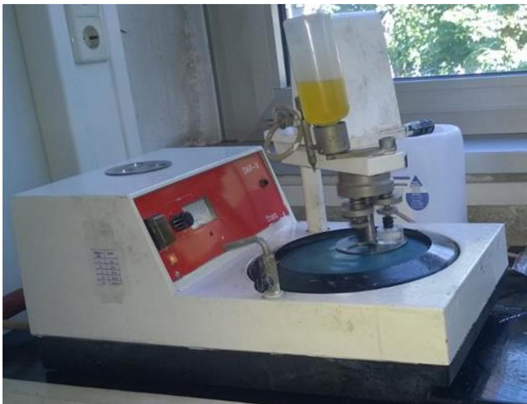
Slika 8. Prikaz uređaja za poliranje.
