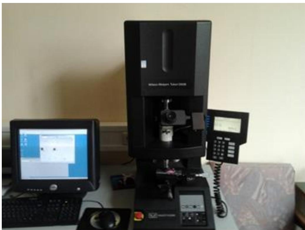
**Slika 16. Mikrotvrdomjer WILSON-WOLPERT TUKON 2100 B proizvođača INSTRON.**
