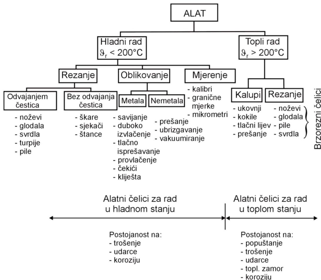
**Slika 2. Shematski prikaz podjele alatnih čelika.**
