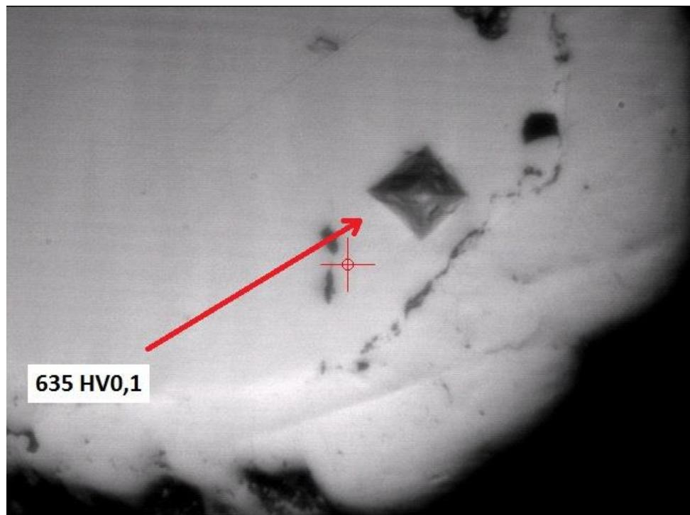
Slika 17. Mjerenje tvrdoće osnovnog materijala (HV 0,1).
