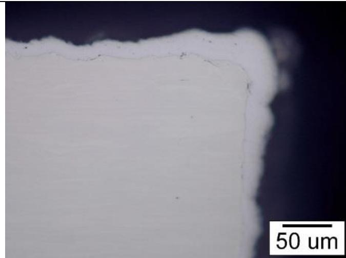
Slika 12. Prikaz poprečnog presjeka pile u reznom području
