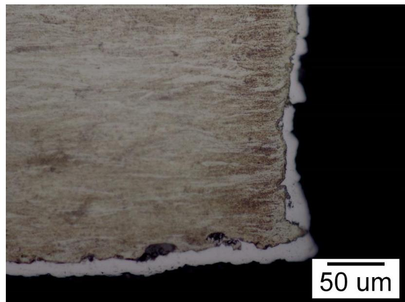
Slika 15. Prikaz mikrostukture u reznom području nakon nagrizanja.
