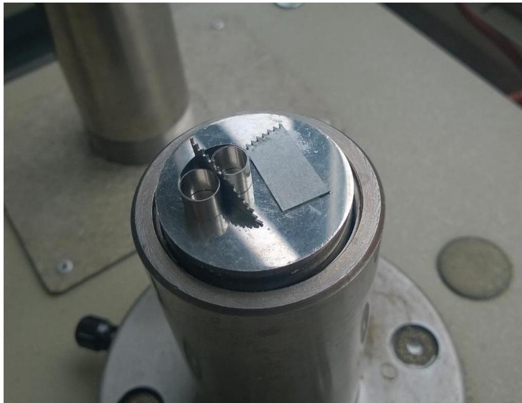
**Slika 6. Prikaz uzorka na preši prije kapsuliranja**
