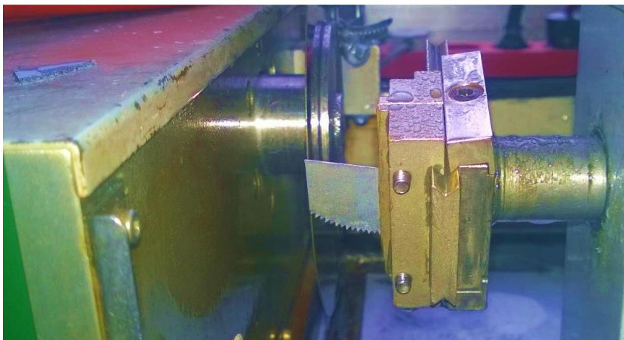
Slika 5. Prikaz postupka izrezivanja dijela uzorka pile.
