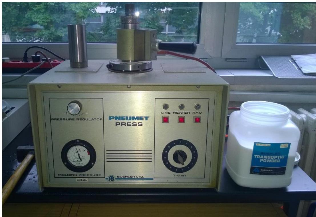
Slika 7. Prikaz uređaja za kapsuliranje.
