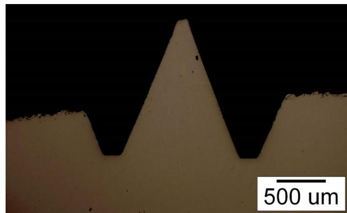
**Slika 10. Polirana površina uzorka u području zuba pile.**
