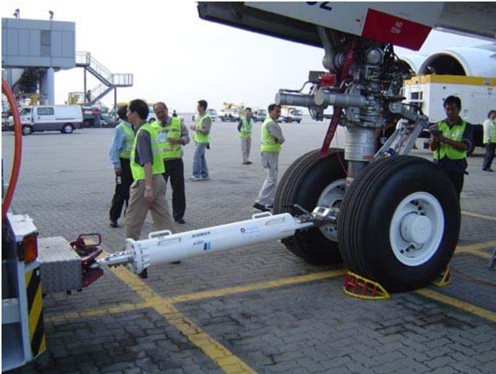
Slika 2.1 Vuča zrakoplova pomoću vučnog ruda
