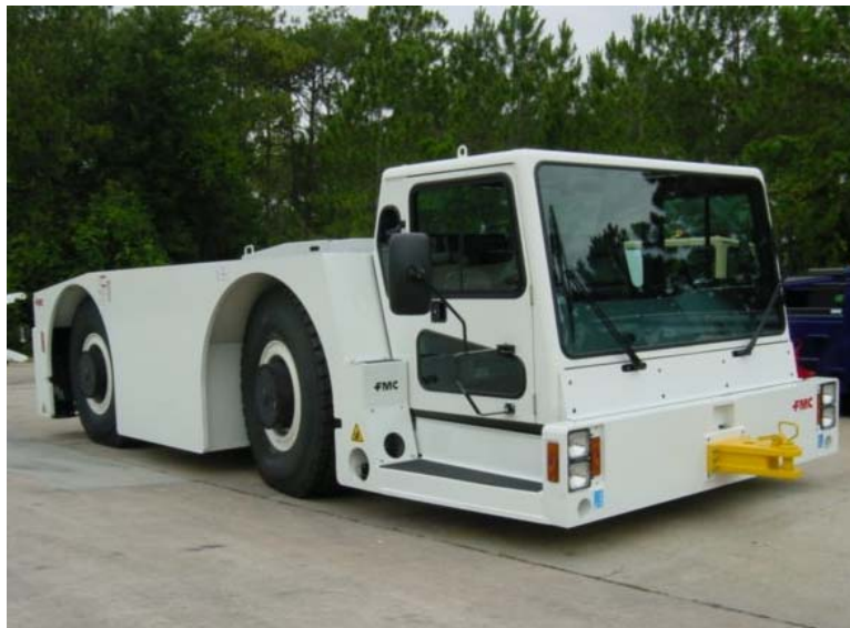
Slika 2.4 Vučno vozilo B-1200 ; FMC technologies
