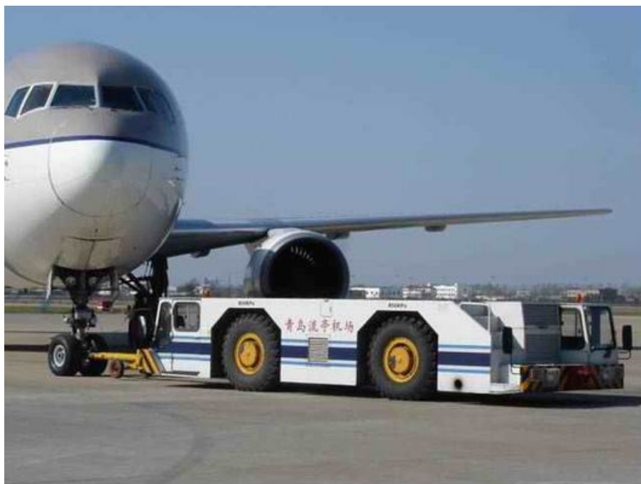
Slika 1.1 Konvencionalan način vuče
