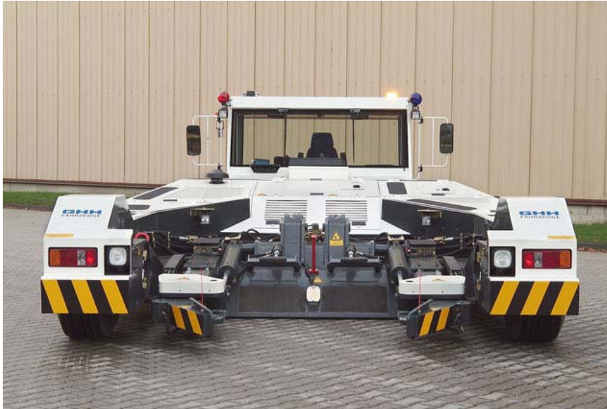
Slika 3.3 Podizna rampa u spušenom položaju
