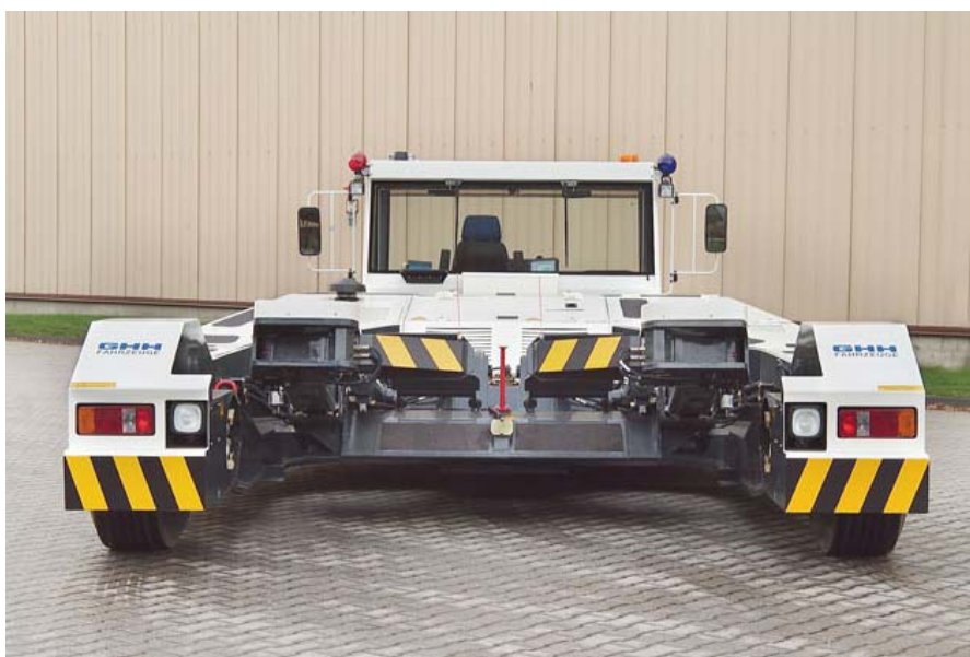
Slika 3.6 Podizanje nosne noge podvozja
