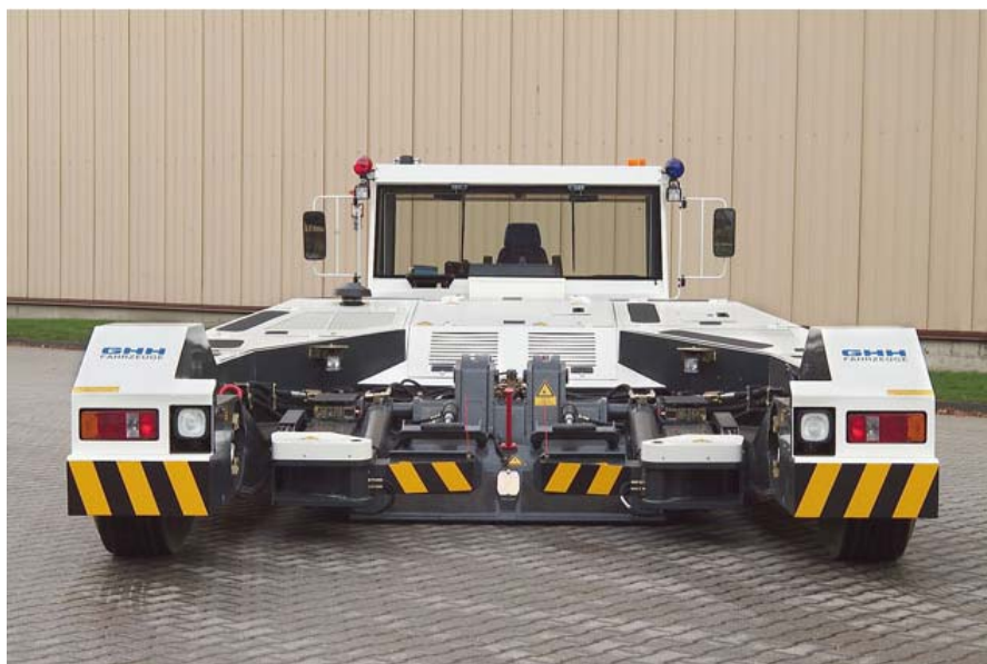
Slika 3.5 Primicanje nosne noge podiznoj rampi
