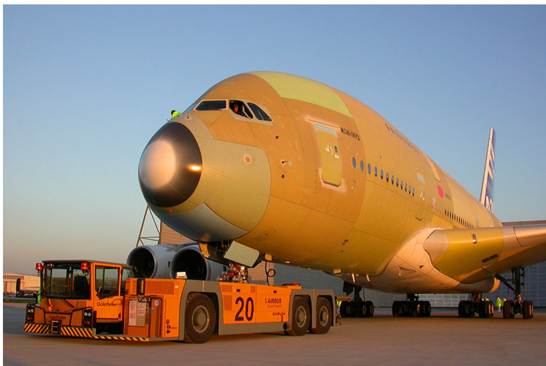
Slika 1.2 Vuča bez vučnog ruda
