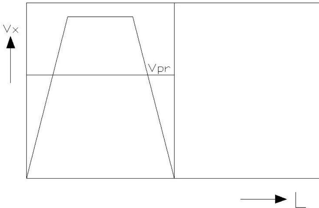
**Slika 43. Promjena brzine kretanja dizalice u horizontalnom smjeru**
