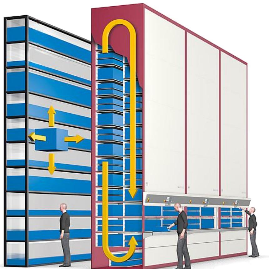
**Slika 2. Usporedba klasičnog skladišnog regala s policama i vertikalnog karusela**
