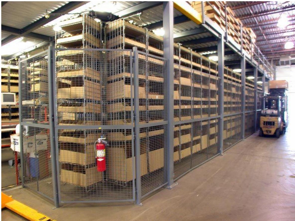
**Slika 1. Horizontalni karusel zaštićen ogradom**
