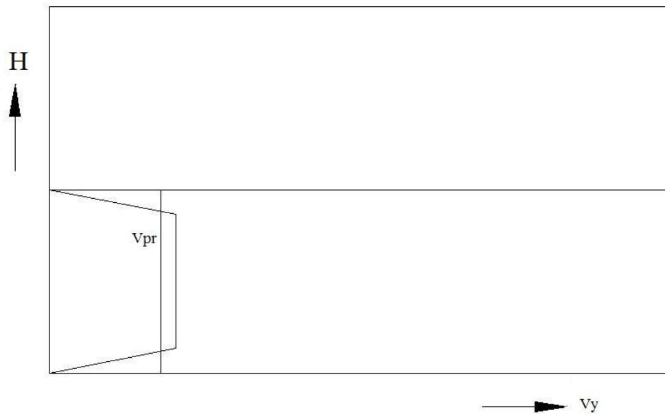
**Slika 44.** Promjena brzine kretanja dizalice u vertikalnom smjeru
