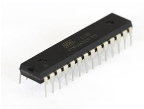
Slika 8 – Stvarni izgled ATmega328
