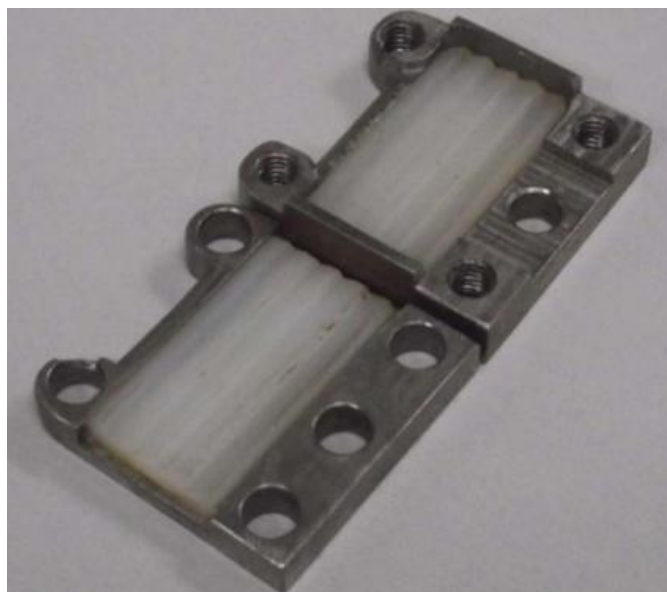
Slika 16. Čeljusti s unutarnje strane [9]
