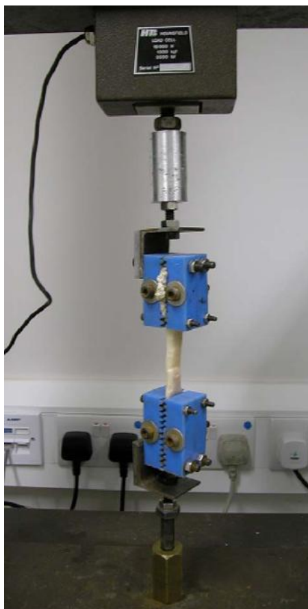
Slika 11. Statički vlačni test s nazubljenim čeljustima – model 1 [8]
