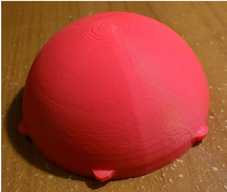
Slika 5.20. FDM model polimerne čašice implantata kuka
