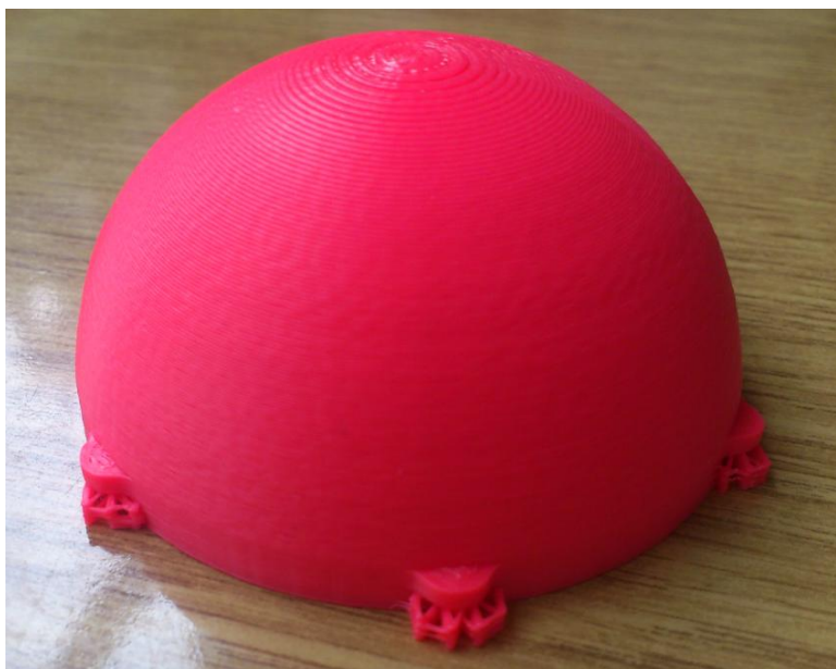
Slika 5.18. Proizvedeni model s potpornim dijelovima
