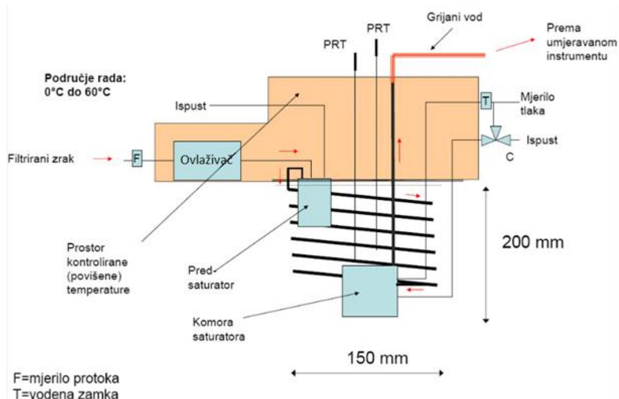
Slika 2. Shematski prikaz visokotemperaturnog generatora vlažnosti (HRS)
