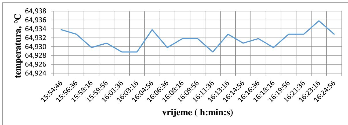
Slika 19. Stabilnost temperature (65°C, 30 min)
