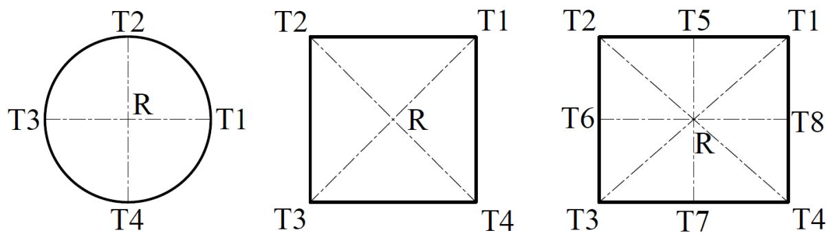
**Slika 5. Prikaz uobičajenih razmještaja termometara unutar radnog volumena kupke, bez izotermnog bloka**
