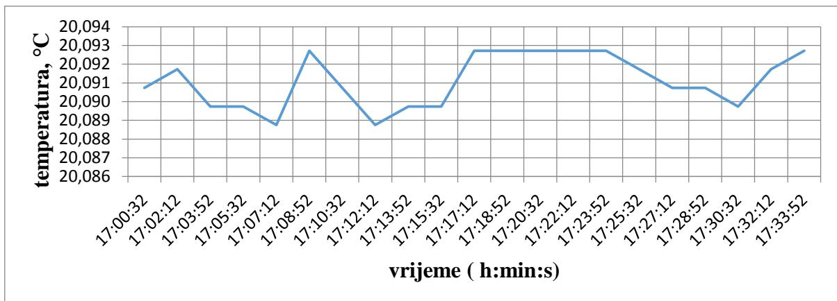
Slika 16. Stabilnost temperature ( 20°C, 30 min )
