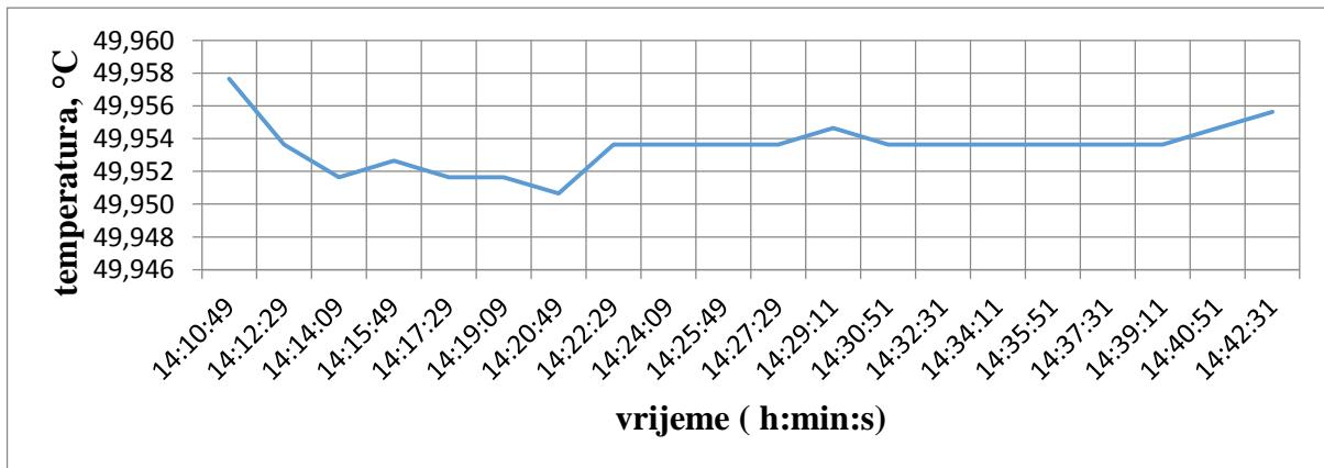
Slika 18. Stabilnost temperature ( 50°C, 30 min )
