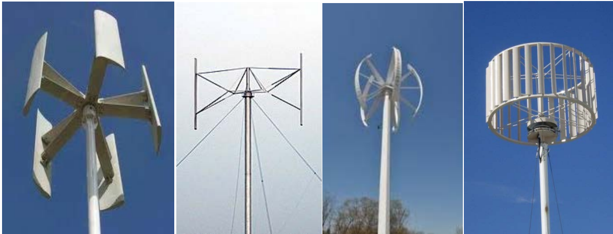
Slika 3 - Vjetroagregati s vertikalnom osi vrtnje [8]
