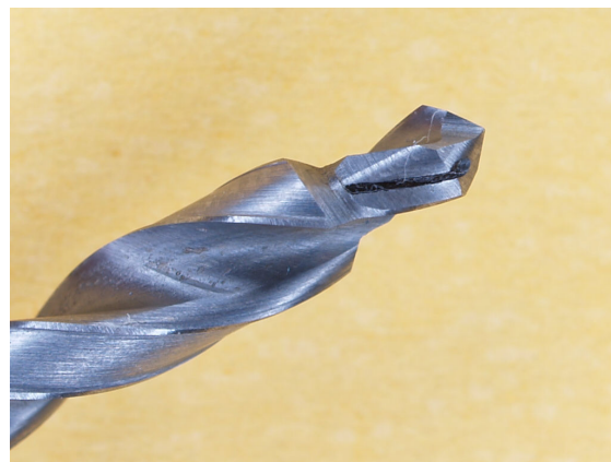
Slika 58. Oštrica dvostupnjevanog svrdla br.2 promjera 2,5/3,4 nakon 180 mjerenja
