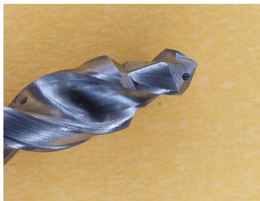
Slika 59. Oštrica dvostupnjevanog svrdla promjera 3,4/4,5 prije mjerenja
