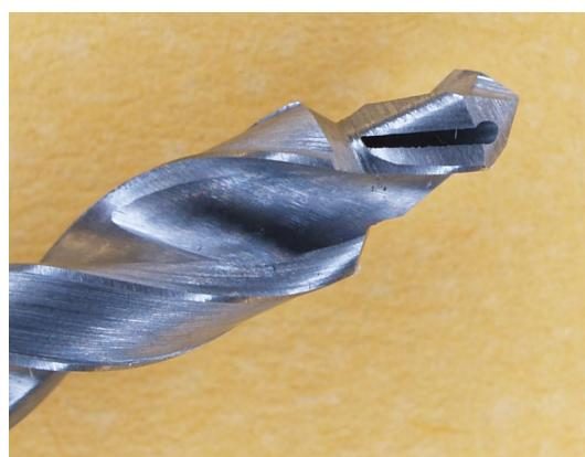
Slika 55. Oštica dvostupnjevanog svrdla br.1 promjera 2,5/3,4 prije mjerena
