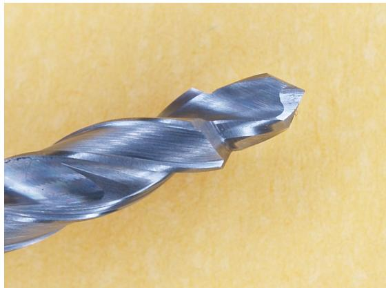
Slika 57. Oštrica dvostupnjevanog svrdla
