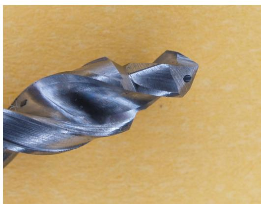
Slika 59. Oštrica dvostupnjevanog svrdla
