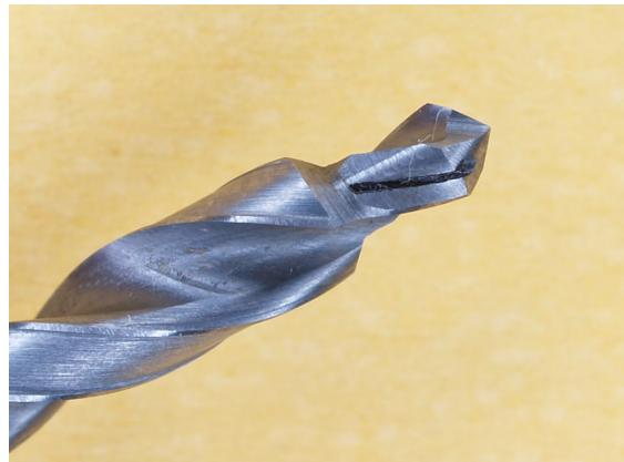
Slika 58. Oštrica dvostupnjevanog svrdla
