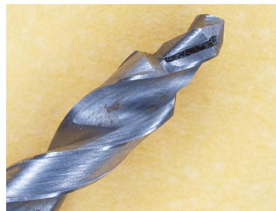
Slika 56. Oštica dvostupnjevanog svrdla br.1 promjera 2,5/3,4 nakon 180 mjerena
