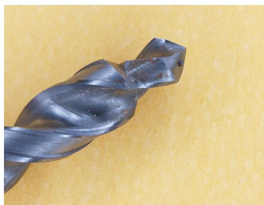
Slika 60. Oštrica dvostupnjevanog svrdla
