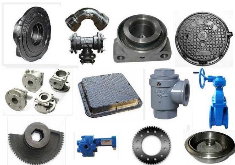
Slika 3. Primjeri odljevaka nodularnog lijeva [5]
