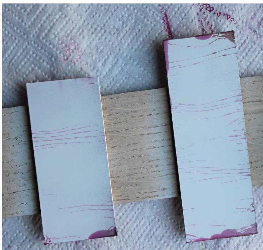
Slika 20. Indikacije na površinama etalona (gornja slika: T_{\text{pen}}=5 min, T_{\text{raz}}=20 min, E=300 lx, \vartheta=21^{\circ}\text{C} donja slika : T_{\text{pen}}=5 min, T_{\text{raz}}=20 min, E=800 lx, \vartheta=21^{\circ}\text{C} )
