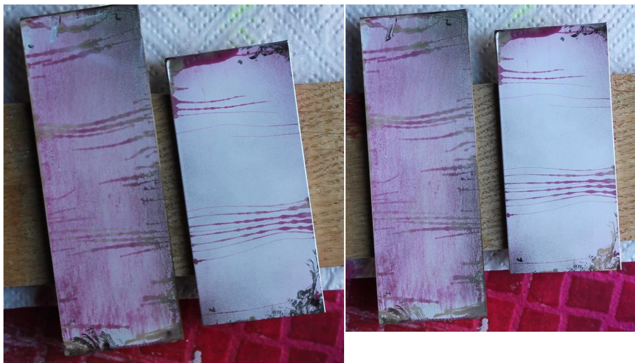
Slika 18. Indikacije na površinama etalona
