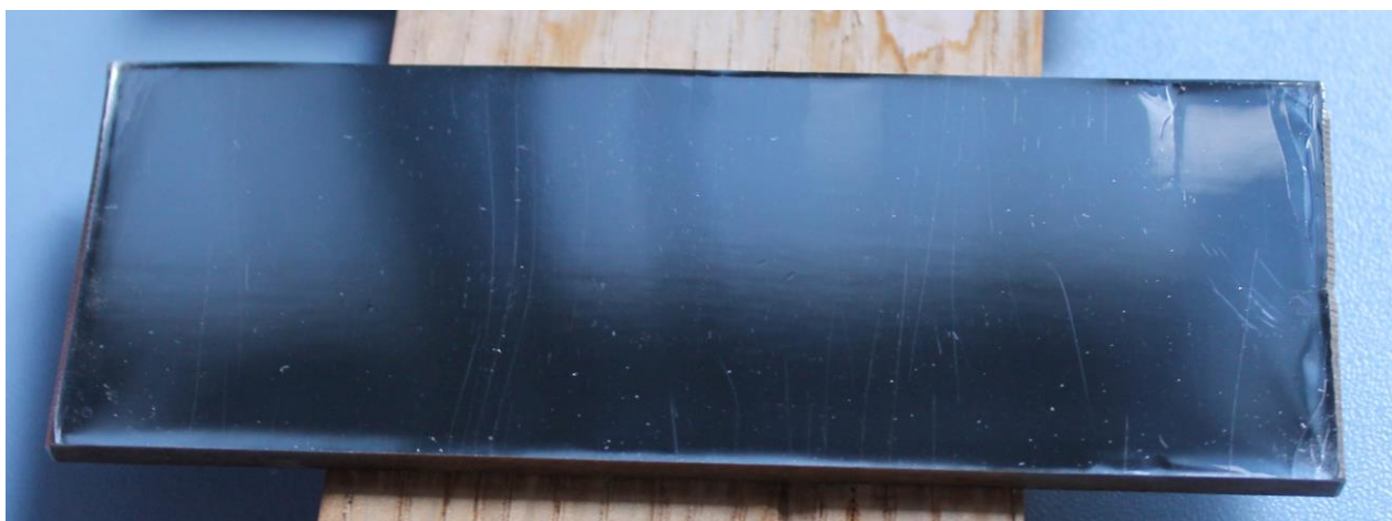
Slika 8. Etalon 2 koji se koristio za ispitivanje PT-a
