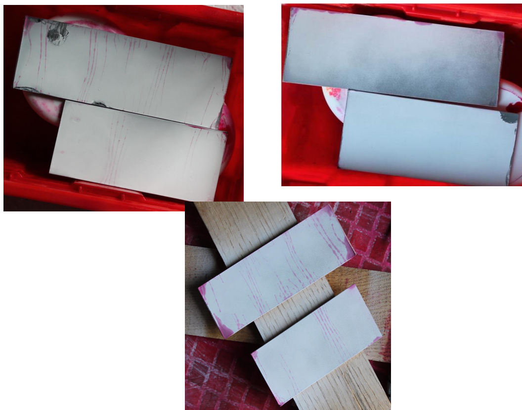
Slika 29. Usporedba indikacija na etalonima na niskoj temperaturi površine i na sobnoj temperaturi površine etalona sa različitim vremenom penetriranja
