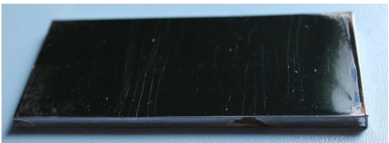
Slika 9. Etalon 1 koji se koristio za ispitivanje PT-a
