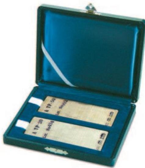
Slika 4. Radni etaloni tipa 1 [18]
