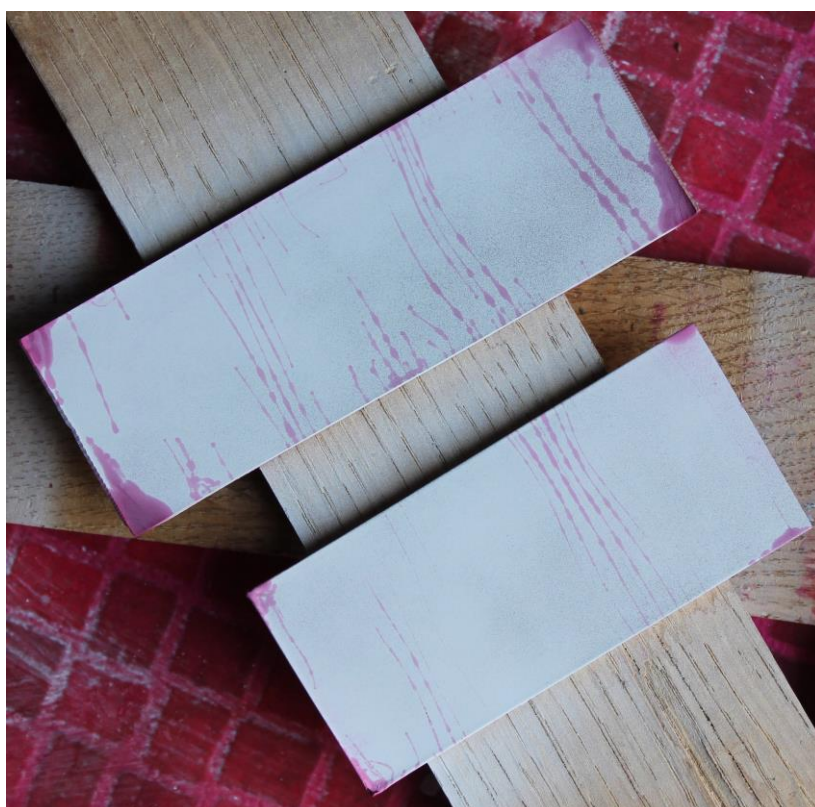
Slika 26. Indikacije na površinama etalona (gornja slika: T_{\text{pen}}=5 min, T_{\text{raz}}=10 min, E=300 lx, \vartheta=20^{\circ}\text{C} donja slika : T_{\text{pen}}=5 min, T_{\text{raz}}=10 min, E=800 lx, \vartheta=20^{\circ}\text{C} )
