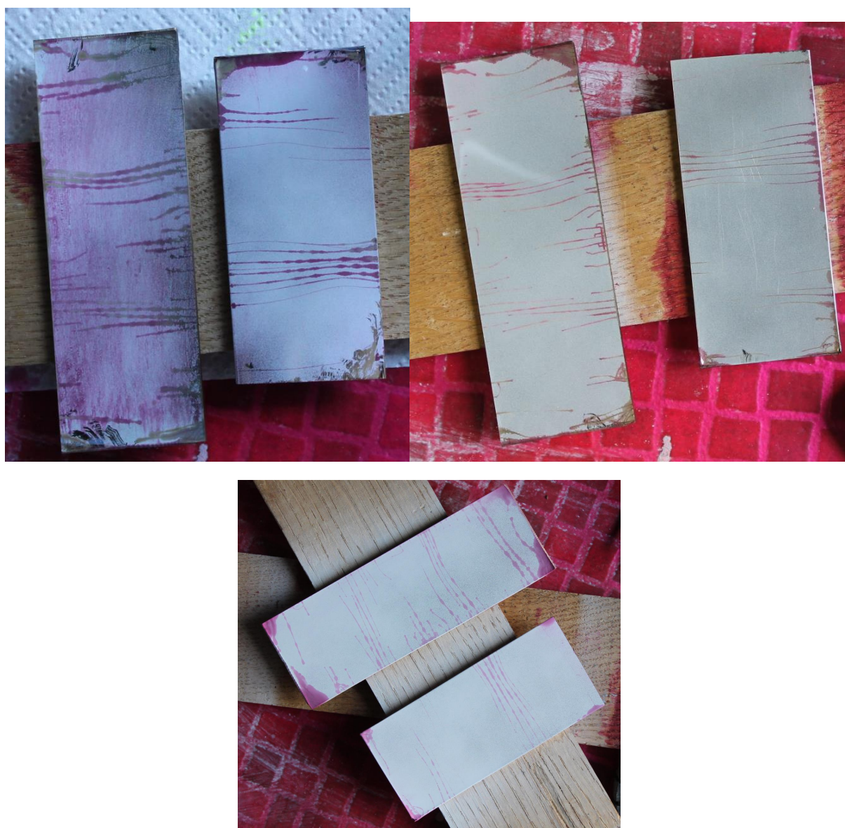
Slika 30. Usporedba indikacija na etalonima na visokoj temperaturi površine i na sobnoj temperaturi površine etalona sa različitim vremenom penetriranja
