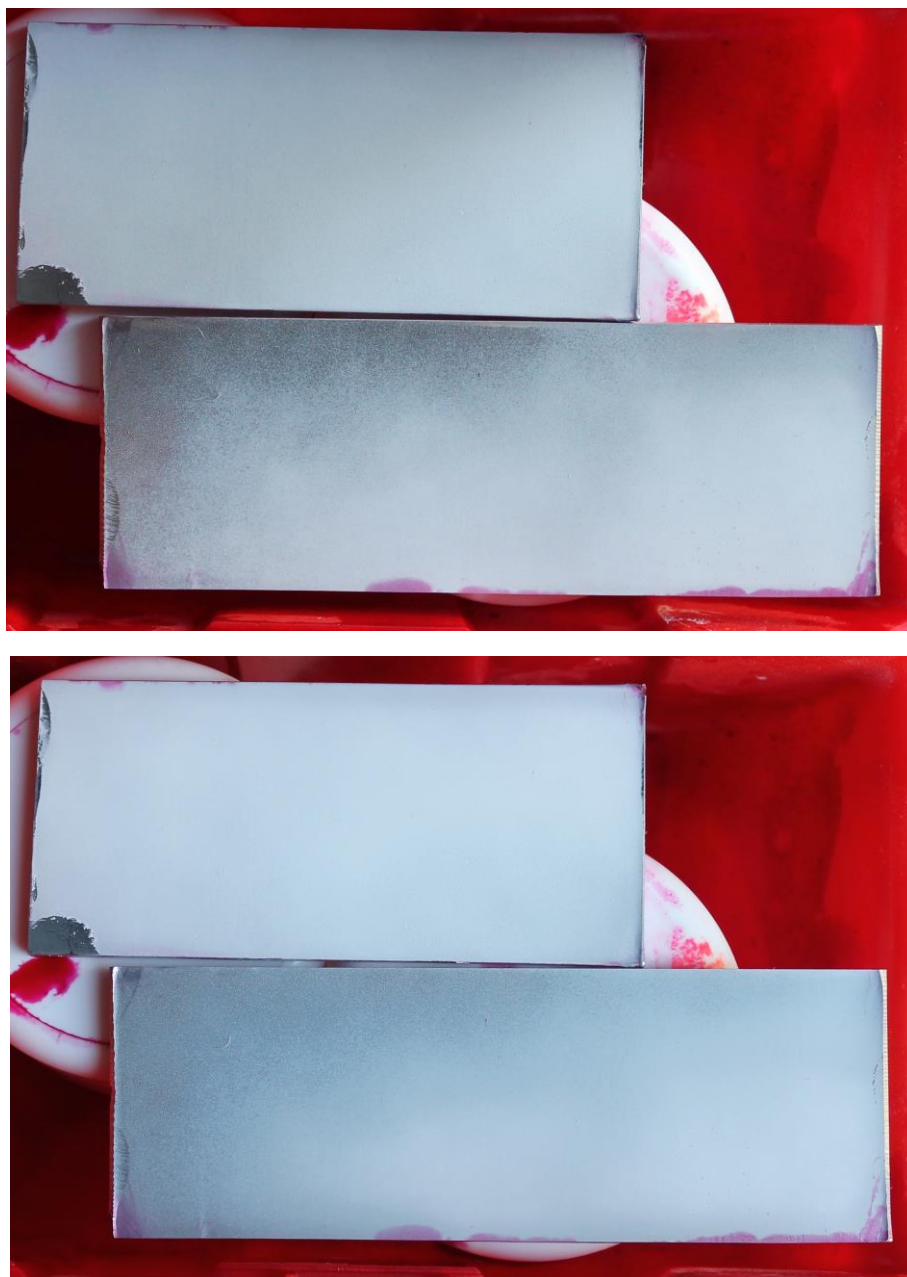
Slika 15. „Indikacije“ na površinama etalona (gornja slika: T_{pen}=5 \text{ min} , T_{raz}=20 \text{ min} , E=300 \text{ lx} , \vartheta=7^{\circ}\text{C} donja slika : T_{pen}=5 \text{ min} , T_{raz}=20 \text{ min} , E=800 \text{ lx} , \vartheta=7^{\circ}\text{C} )
