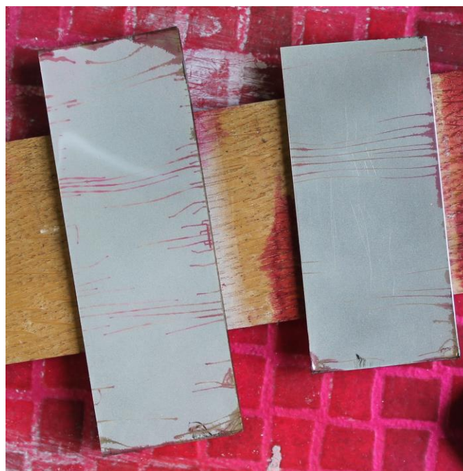
Slika 23. Indikacije na površinama etalona (gornja slika: T_{\text{pen}}=15 min, T_{\text{raz}}=10 min, E=300 lx, \vartheta=80^{\circ}\text{C} donja slika : T_{\text{pen}}=15 min, T_{\text{raz}}=10 min, E=800 lx, \vartheta=80^{\circ}\text{C} )
