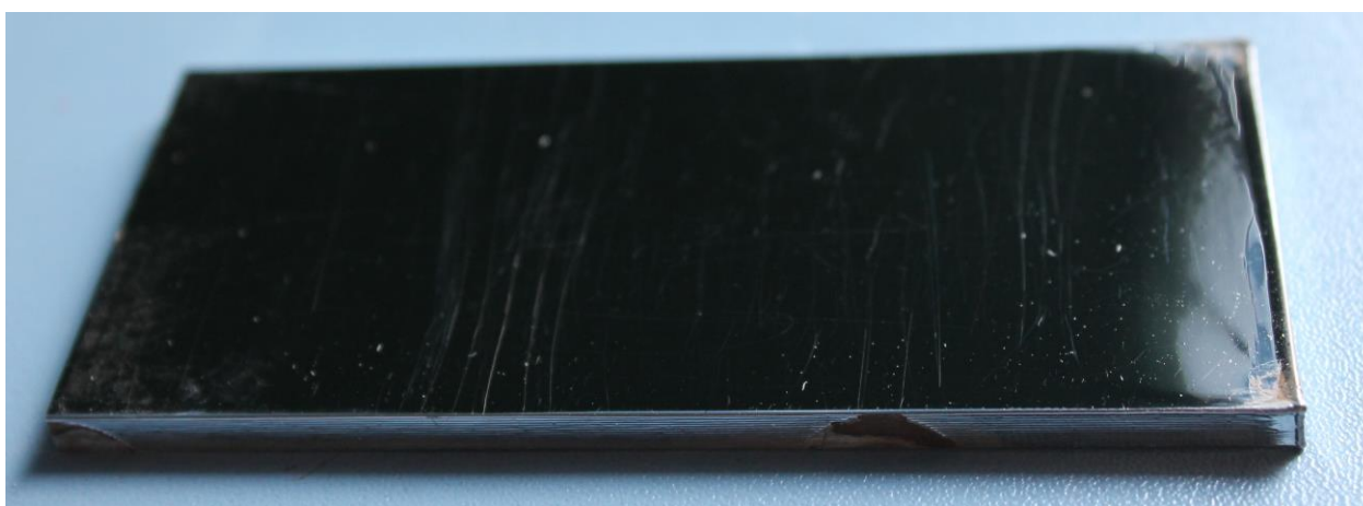
Slika 9. Etalon 1 koji se koristio za ispitivanje PT-a
