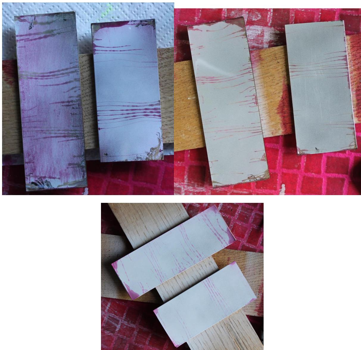
**Slika 30.** Usporedba indikacija na etalonima na visokoj temperaturi površine i na sobnoj temperaturi površine etalona sa različitim vremenom penetriranja
