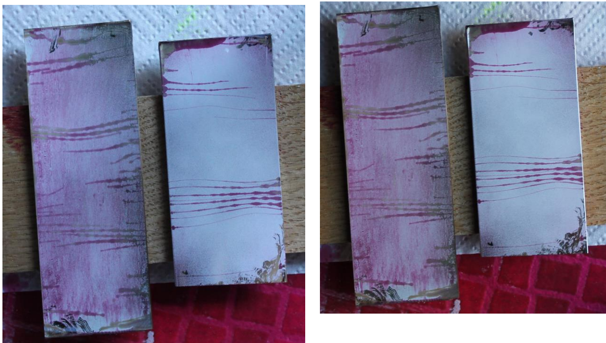
Slika 17. Indikacije na površinama etalona
