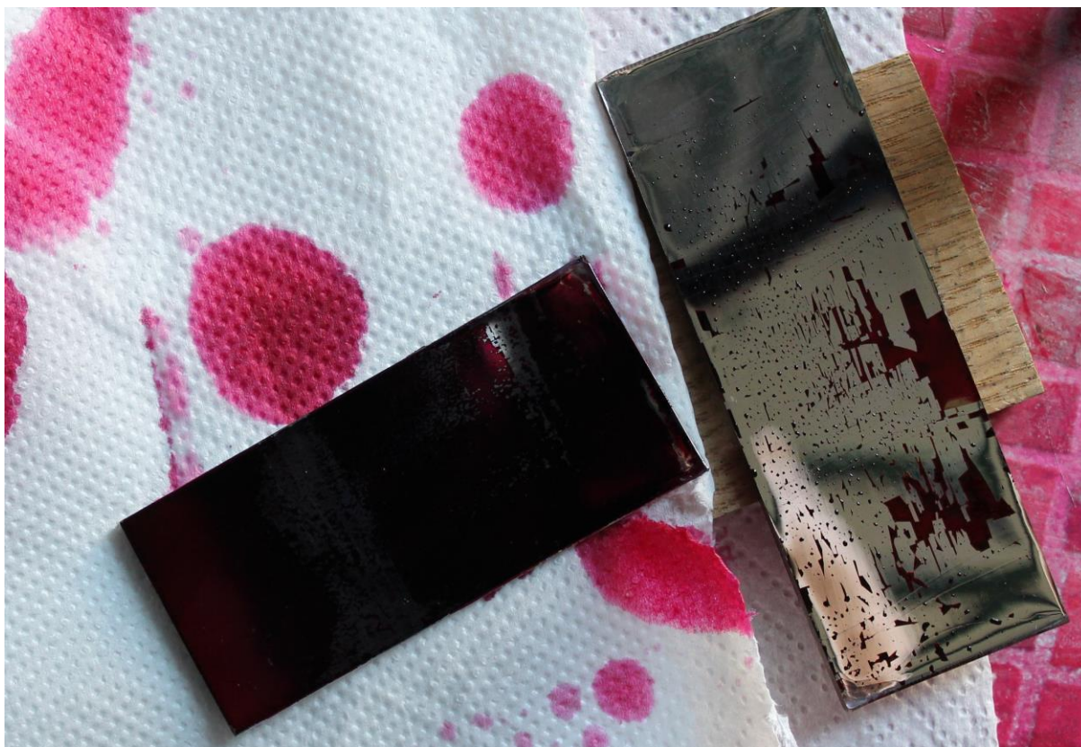
Slika 16. Ispareni penetrant na etalonu 1
