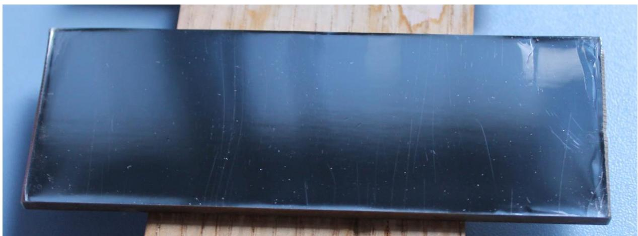
Slika 8. Etalon 2 koji se koristio za ispitivanje PT-a
