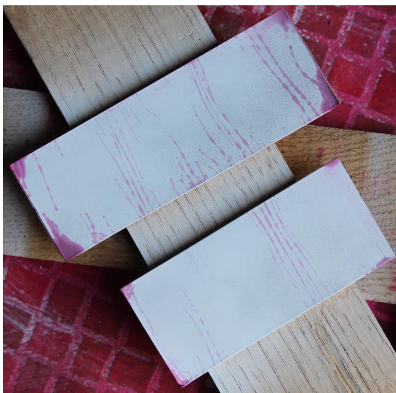
Slika 26. Indikacije na površinama etalona (gornja slika: T_{pen}=5 min, T_{raz}=10 min, E=300 lx, \vartheta=20^{\circ}\text{C} donja slika : T_{pen}=5 min, T_{raz}=10 min, E=800 lx, \vartheta=20^{\circ}\text{C} )
