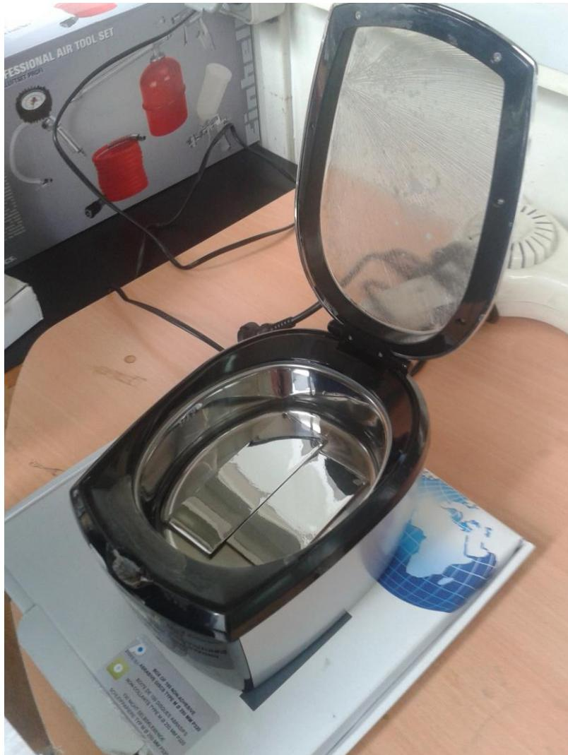
**Slika 25. Ultrazvučna kupka**
