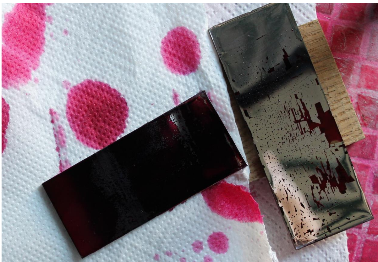
Slika 16. Ispareni penetrant na etalonu 1
