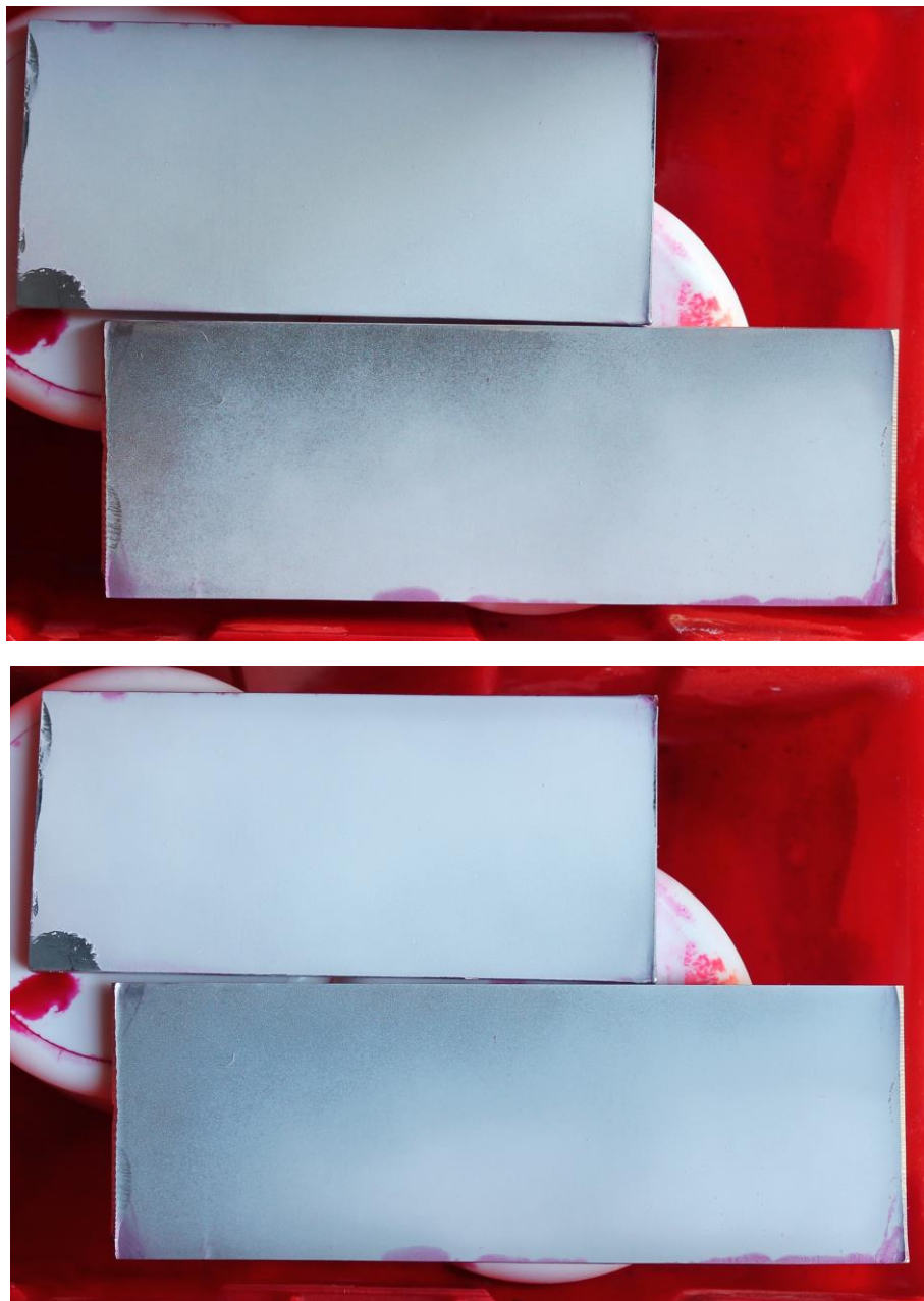
Slika 15. „Indikacije“ na površinama etalona (gornja slika: T_{\text{pen}}=5 \text{ min} , T_{\text{raz}}=20 \text{ min} , E=300 \text{ lx} , \vartheta=7^{\circ}\text{C} donja slika : T_{\text{pen}}=5 \text{ min} , T_{\text{raz}}=20 \text{ min} , E=800 \text{ lx} , \vartheta=7^{\circ}\text{C} )
