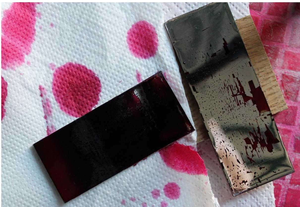
Slika 16. Ispareni penetrant na etalonu 1
