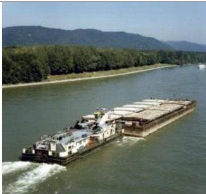
Slika 25. Potisni konvoj sa dvije barže (izvor:viadonau)
