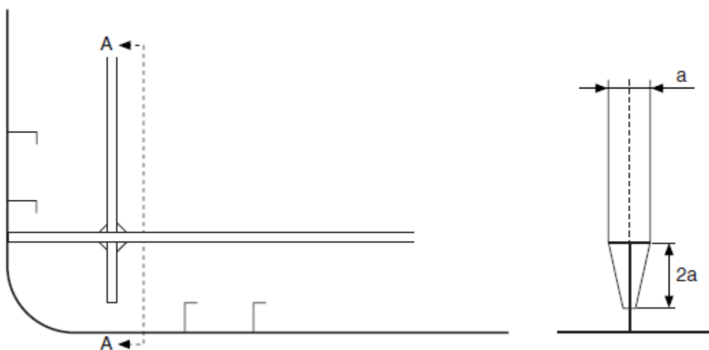
Slika 42. Spajanje dvaju primarnih nosećih elemenata
