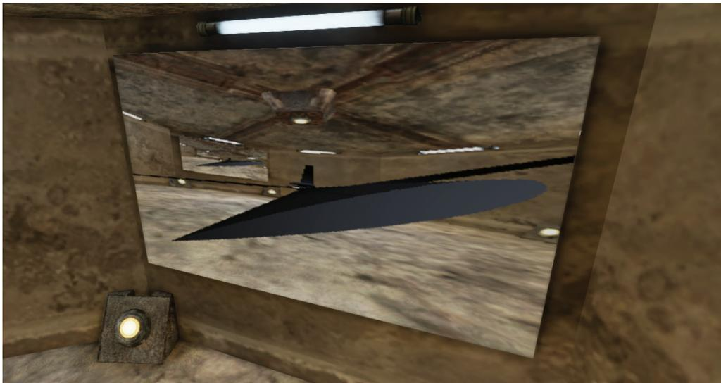
*Slika 42 – Prikaz profila vrha kraka pomoću kamere koja se rotira s krakom. Pokretna slika se prikazuje na teksturi geometrijskog objekta pomoću tehnike koja se koristi za efekt zrcala, kao primjerice za simulaciju vodene površine.*
