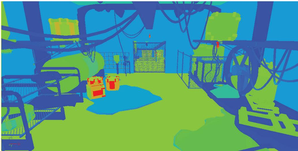
Slika 5 - Dijagnostički pregled složenosti teksture dodijeljene površini geometrijskih objekata (texture density). Toplije boje ukazuju na veću količinu memorije po jedinici površine, potrebne za pohranjivanje informacija o teksturi geometrijskog objekta.
