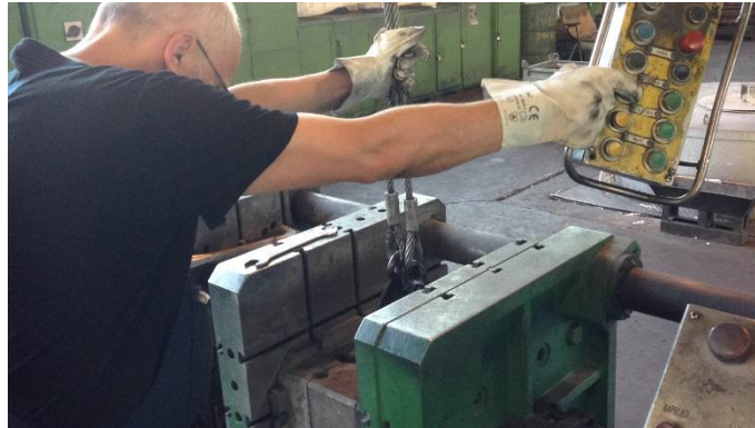
Slika 27. Pozicioniranje nove kokile
