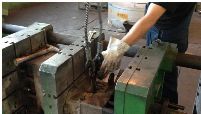
*Slika 29. Odspajanje nove kokile sa mostne dizalice*
