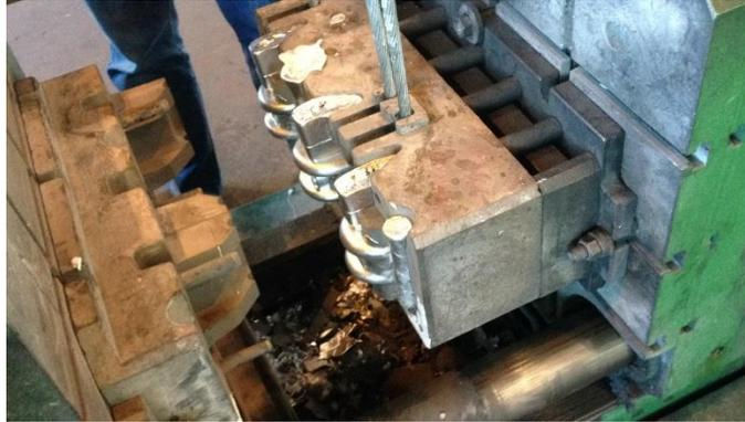
*Slika 38. Otvaranje kokile i hlađenje poluproizvoda na zraku*
