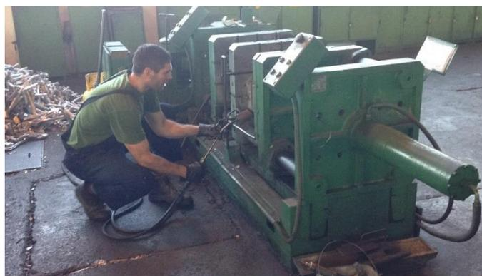
*Slika 31. Montiranje plinskog brenera na nosač*
