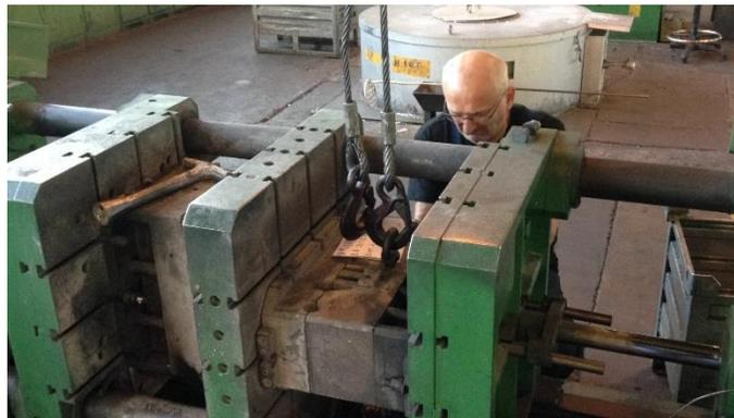
*Slika 28. Zatezanje nove kokile vijčanim spojem*
