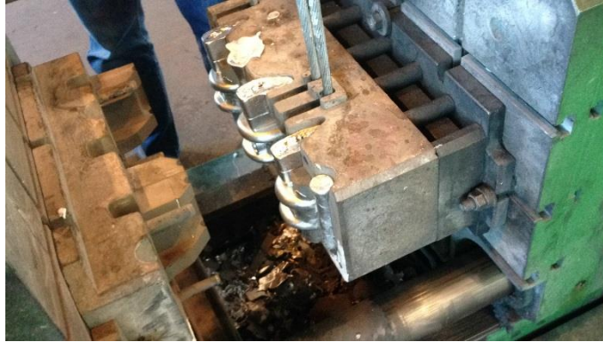
Slika 38. Otvaranje kokile i hlađenje poluproizvoda na zraku
