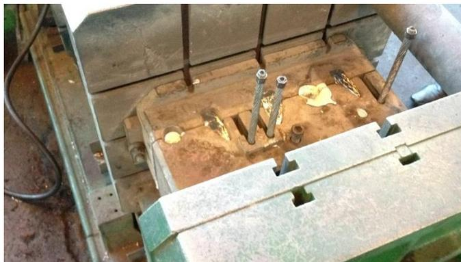
*Slika 37. Lijevanje hvataljke sa užetom u kokili*
