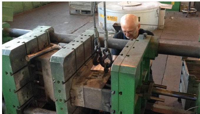
Slika 28. Zatezanje nove kokile vijčanim spojem
