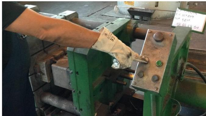
*Slika 30. Probni rad nove kokile (provjeravanje centriranosti)*
