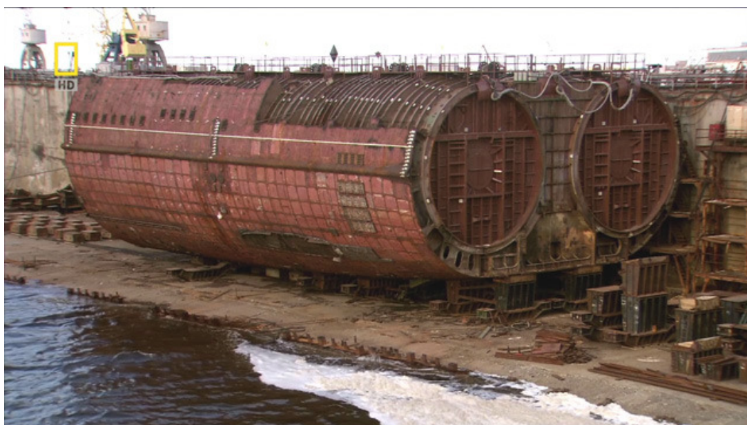
Slika 15. Izvađeni dio trupa s nuklearnim reaktorom [16]
