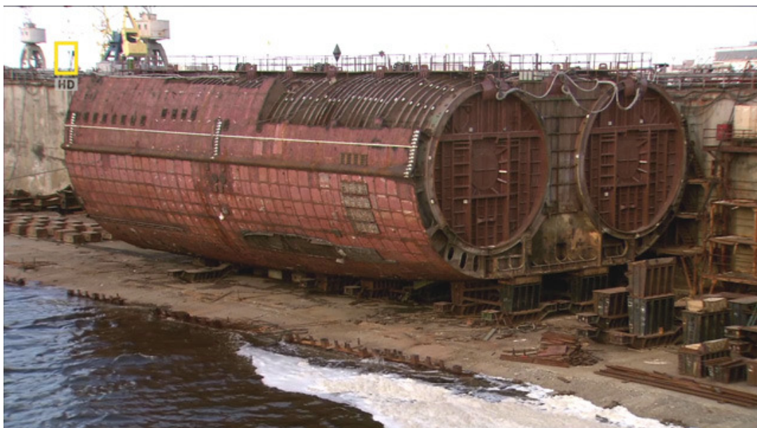
Slika 15. Izvađeni dio trupa s nuklearnim reaktorom [16]
