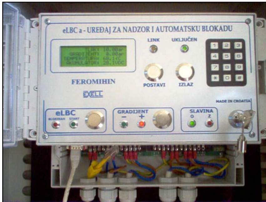
Slika 31. Izgled kontrolne ploče eLBC uređaja Feromihin Exell
