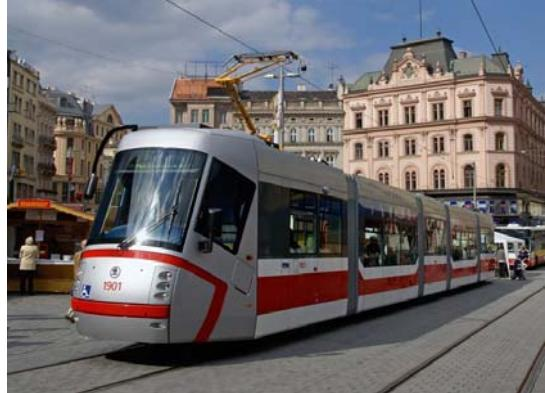
Electra 13 T je niskopodni tramvaj konstruiran za grad Brno, Republika Česka.
