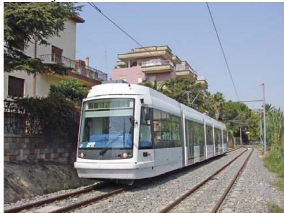
Electra 06 T je niskopodni tramvaj visokog kapaciteta za grad Cagliari na Sardiniji.
