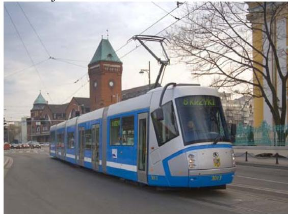
Electra 16 T je niskopodni tramvaj velikog kapaciteta konstruiran za grad Wrocław, Poljska.
