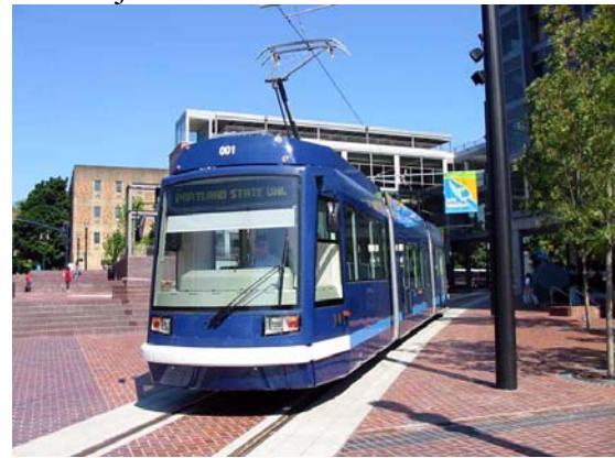
Electra 10 T je niskopodni tramvaj konstruiran za tržište U.S.A.
