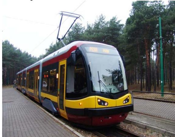
Niskopodni petodijelni tramvaj proizveden za tvrtku MPK Łódź Spółka z o. o., iz grada Lodz u Poljskoj.
