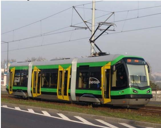
Niskopodni trodijelni tramvaj proizveden za tvrtku Tramwaje Elbląskie, iz Poljske.
