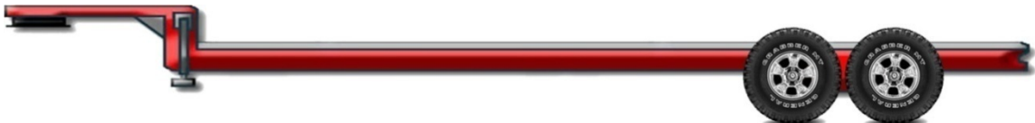
Slika 42. Labudičasta poluprikolica tvrtke Schmitz
