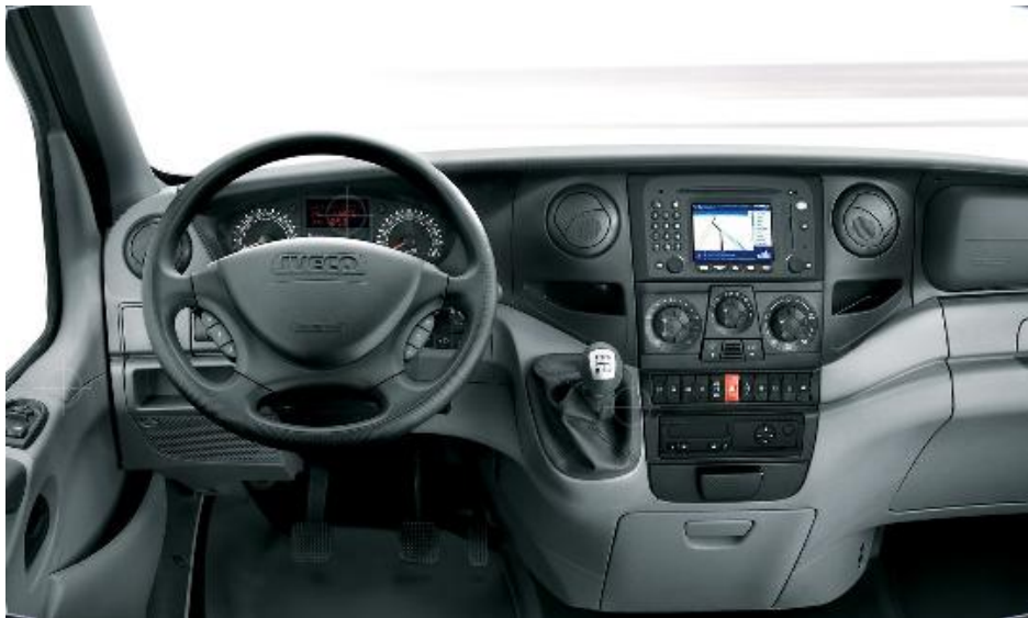
Slika 18. Unutrašnjost kabine i smještaj ručica za reduciranje [11]
