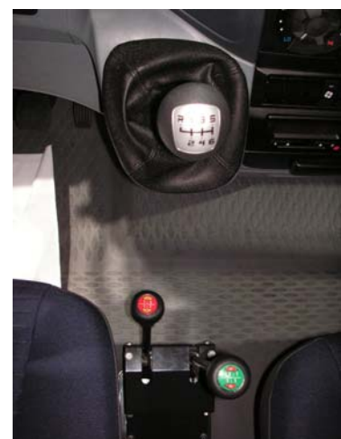
Slika 11. Ručice mjenjača, splitera i redukcija [11]
