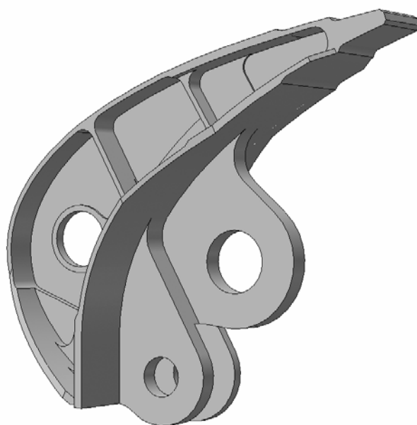
Slika 2.7. Stvarni izgled glavnog rebra 3
