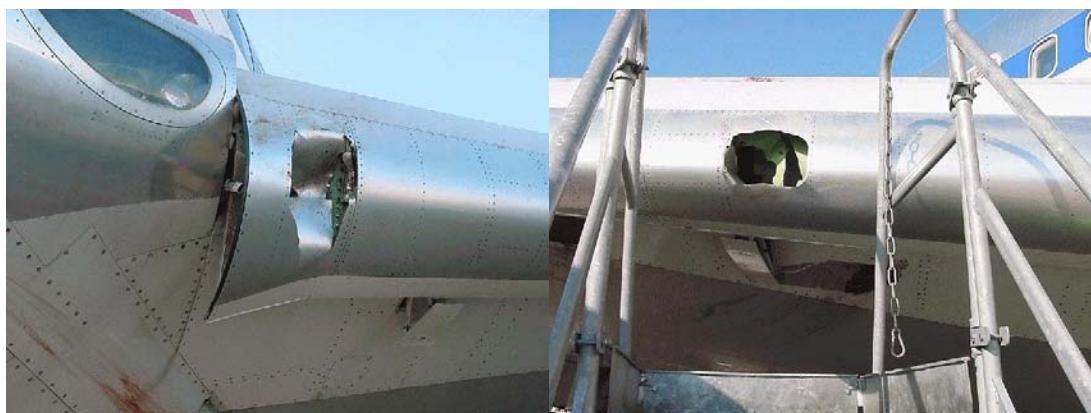
*Slika 1.1. Oštećenja na pretkrilcu nastala uslijed udara ptice [2]*
