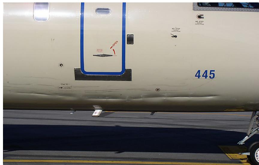
Slika 1.2 Oštećenje konstrukcije rudom za vuču [3]
