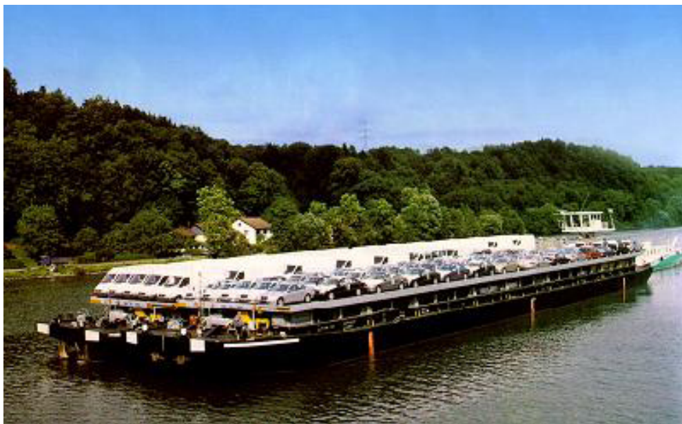
Slika 3.1.7. Kompozicija od dvije barže tipa Europa II pogonjene brodom guračem
