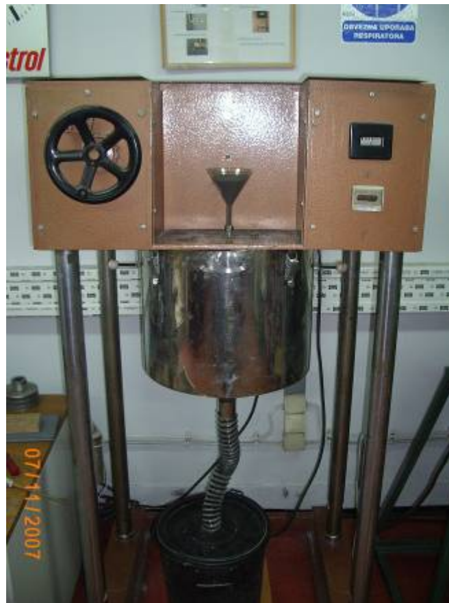
Slika 35 – Uređaj za ispitivanje otpornosti na eroziju
