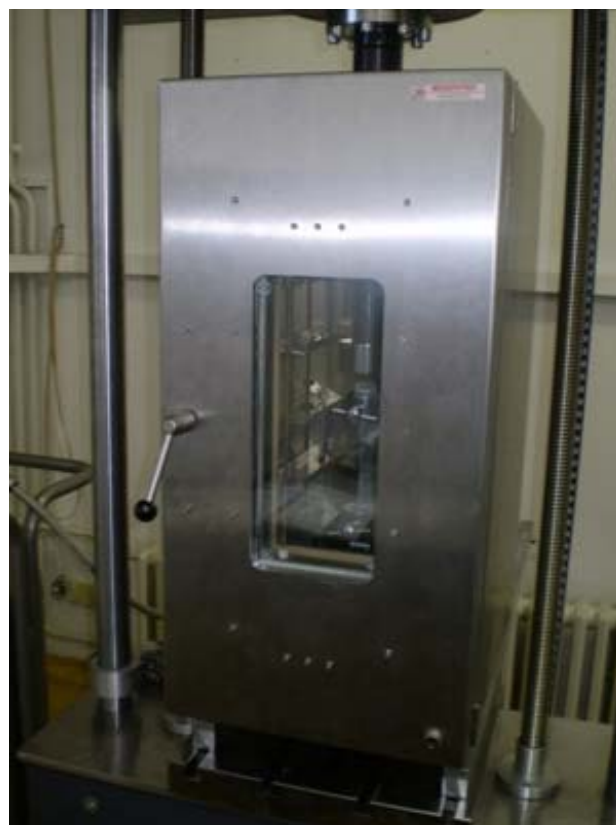
Slika 6.4. Komora za temperiranje
