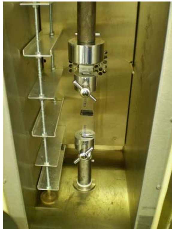
Slika 6.6. Ispitno tijelo stegnuto u hvataljke
