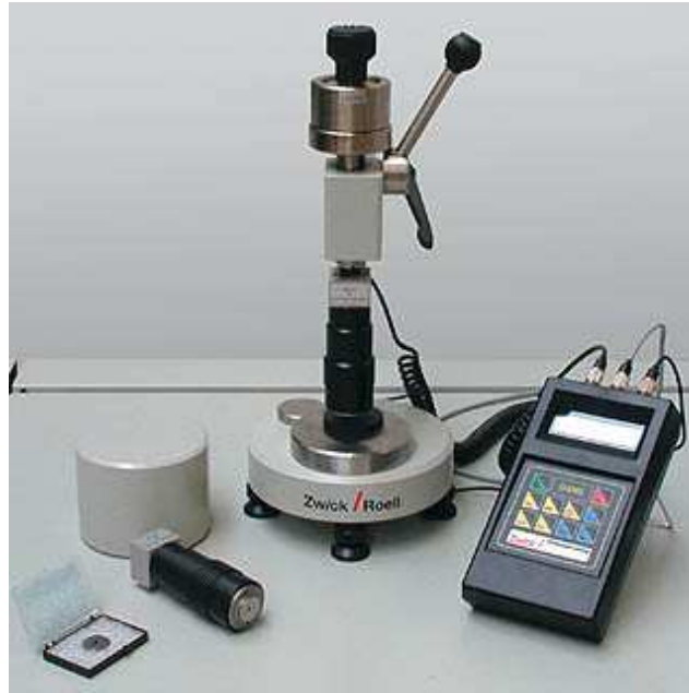
Slika 7.5. Schore- ov uređaj za ispitivanje tvrdoće 26
