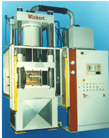
Slika 5.3. Preša za izravno prešanje 17
