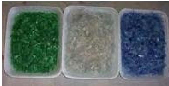
Slika 5.9. Prikaz po boji razvrstane PET mljevine [34]
