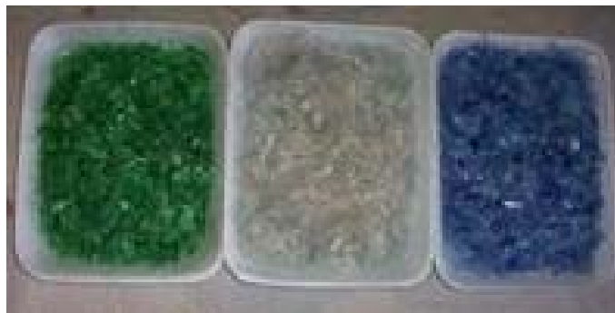
Slika 5.9. Prikaz po boji razvrstane PET mljevine [34]
