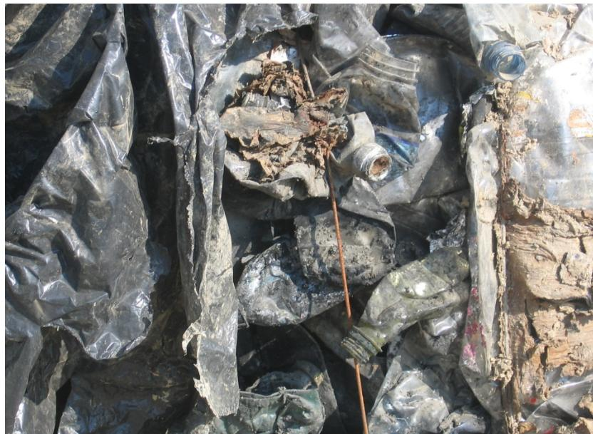
Slika 6.10. Jako onečišćene i degradirane PET boce
