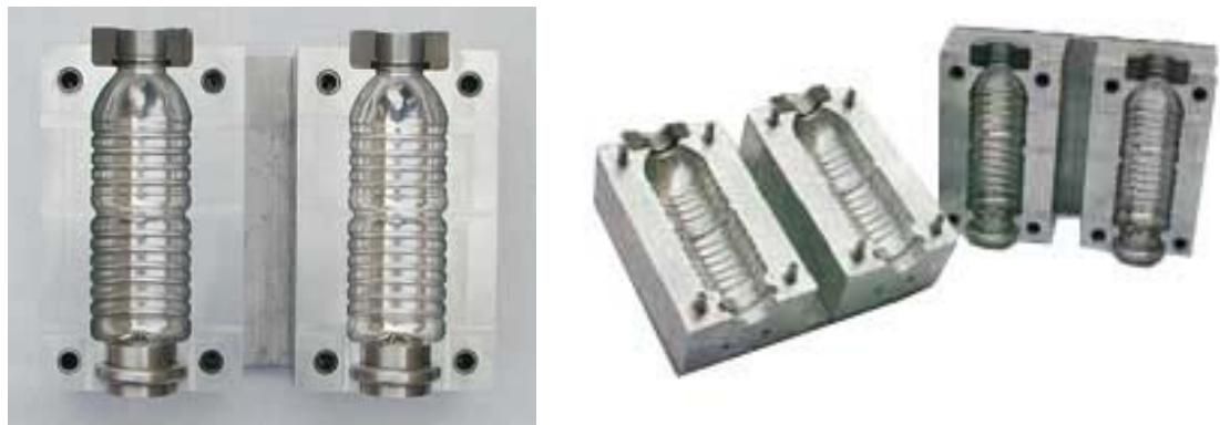
Slika 3.5. Prikaz kalupa za razvlačno puhanje PET boce [14]
