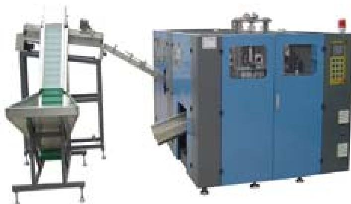
Slika 3.4. Prikaz automatske razvlačne puhalice za PET boce (Aoktac 3000) [13]
