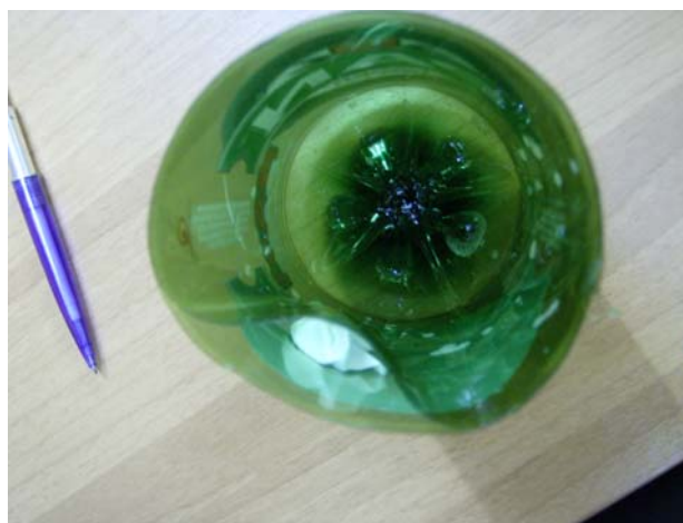
Slika 6.14. Višeslojna PET boca PAN piva
