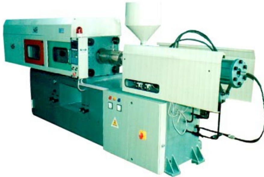
Slika 3.3. Prikaz ubrizgavalice za izradu PET predoblika (SANTEC SPI – 200) [12]
