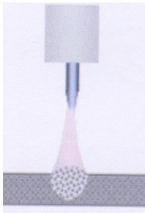
*Slika 3.5. Izgled profila zavara dobiven pri korištenju CO<sub>2</sub> kao zaštitnog plina, CO<sub>2</sub> daje veliku dubinu penetracije i širinu samog zavara. [8]*
