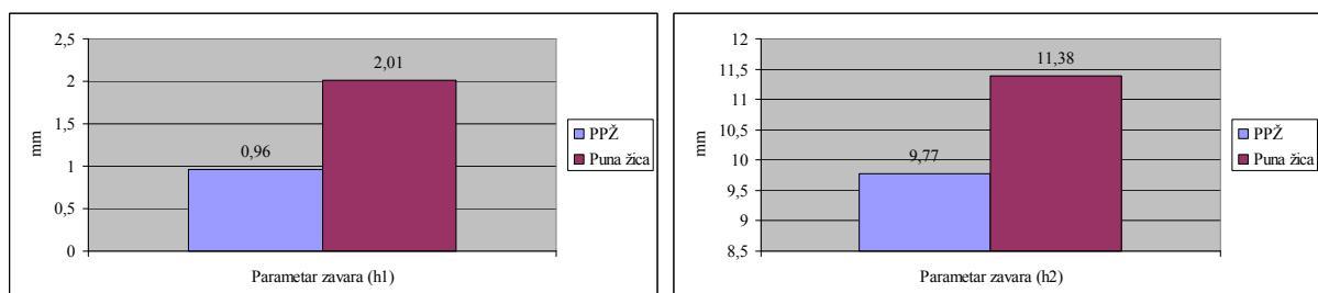
**Slika 8.47. i 8.48.** Usporedba zajedničkih parametara ( $h1, h2$ ) PPŽ i pune žice uzoraka H i I u dijagramskom prikazu.
