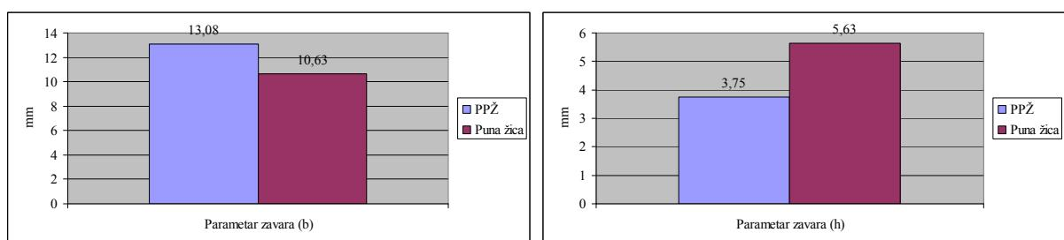
**Slika 8.40. i 8.41.** Usporedba zajedničkih parametara (b, h) PPŽ i pune žice uzoraka D i F u dijagramskom prikazu.
