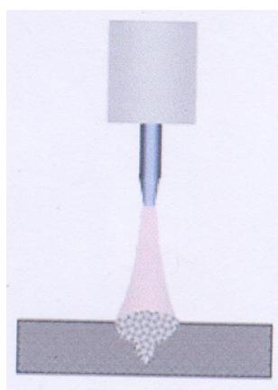
*Slika 3.6. Izgled profila zavara dobiven pri korištenju Ar kao zaštitnog plina; Ar daje veliku i usku dubinu penetracije po obliku kao "prstenasta" ili penetracija u obliku čavla. [8]*
