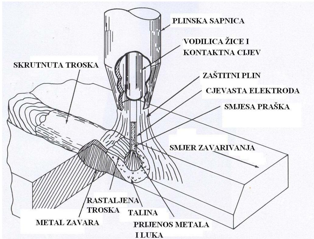
*Slika 2.3.* Prikaz i dijelovi FCAW-G postupka zavarivanja. [2]
