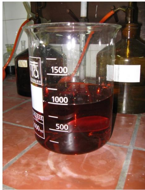
**Slika 8.16.** Pripremljena otopina prema sjevernoameričkoj normi ASTM G48-99a koja se koristi za ispitivanje jamičaste korozije.
