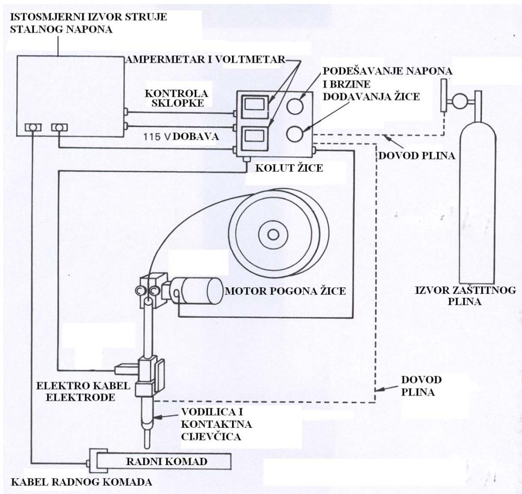
*Slika 3.13. Dijelovi automatske opreme za FCAW zavarivanje. [2]*
