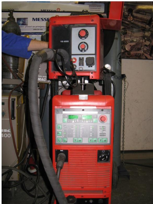
*Slika 7.2. Izvora struje za zavarivanje MIG/MAG/FCAW postupkom sa dodavačem žice
