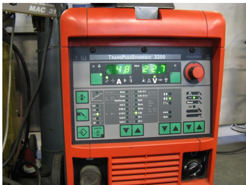
*Slika 7.3. Kontrolna ploča uređaja za zavarivanje omogućava odabir i namještanje
