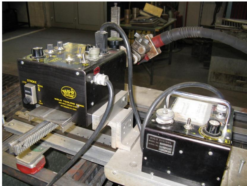
**Slika 7.4.** Uredaj automatskog posmaka pri zavarivanju, model Bug-5100, proizvođača Bug-O Systems; omogućava odabir brzine zavarivanja i njezino mijenjanje pri samom zavarivanju, kao i dodatne mogućnosti pri zavarivanju npr. njihanje zavarivačkog pištolja, odabir smjera zavarivanja,...
