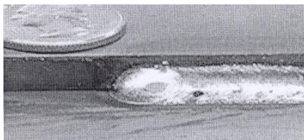
*Slika 2.1. Izgled zavara dobivenog FCAW postupkom. [1]*
