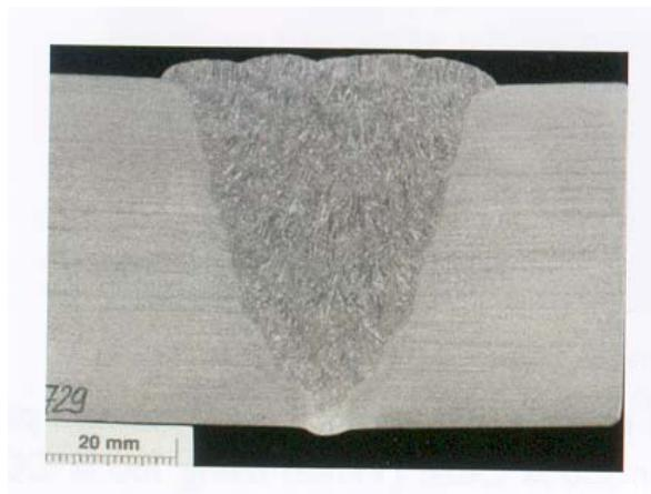
*Slika 4.8. Makroizbrusak zavara izvedenog FCAW postupkom. [4]*
