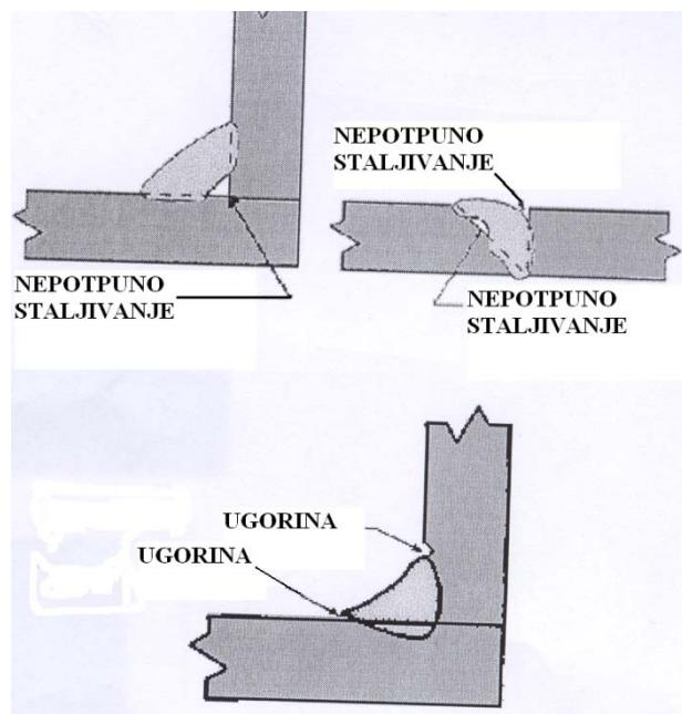
*Slika 6.4. Nepravilnosti pri zavarivanju (ugorina i nepotpuno staljivanje) i njihov izgled pri poprečnom presjeku zavara. [10]*
