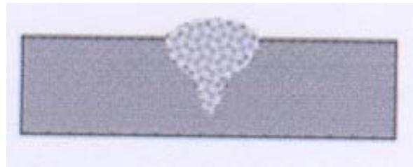
*Slika 3.9. Izgled profila zavara dobiven pri korištenju zaštitne mješavine plina Ar/O<sub>2</sub>, ova vrsta mješavine daje vrlo veliku dubinu penetracije, ali i uži profil zavara. [8]*
