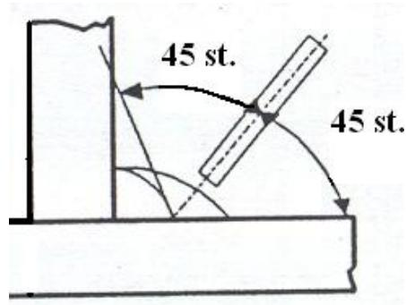
*Slika 7.9. Kut pod kojim je postavljen zavarivački pištolj pri zavarivanju kutnog T spoja. [14]*
