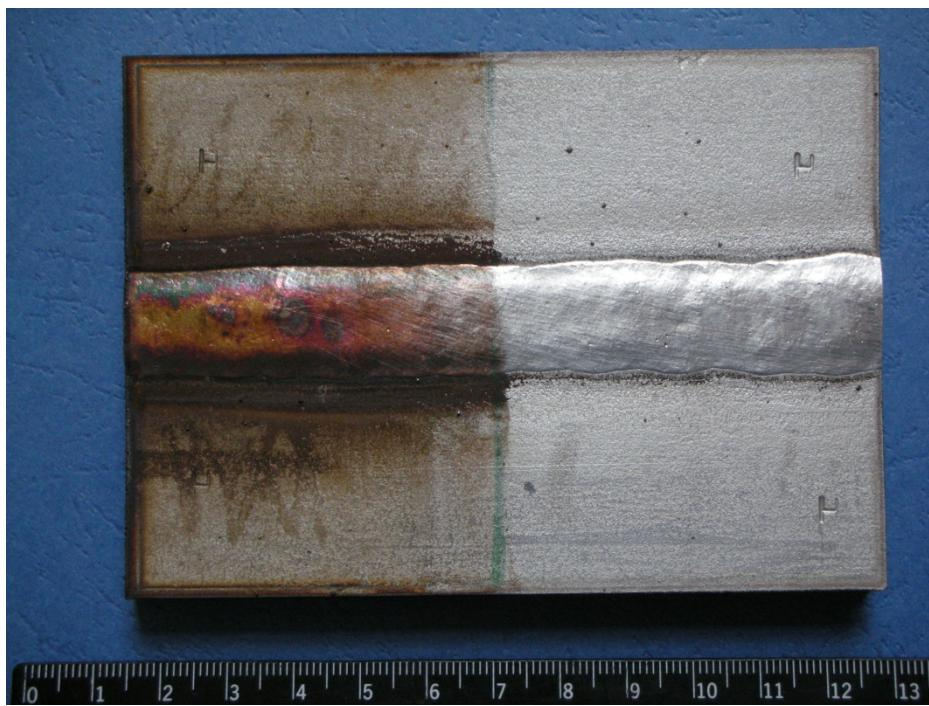
*Slika 8.14. Uzorak H je sučeljeni spoj izveden FCAW-G postupkom uz PPŽ; razlika naprema G uzorku je u pripremi spoja.*
