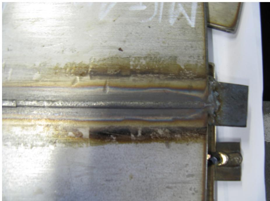
*Slika 8.8. Prvi prolaz (korijenski) pri zavarivanju MIG postupkom uz punu žicu i razmak u korijenu od 1 mm. Rezultat je vrlo dobar izgled i nadvišenje korijena zavara. Rezultat je bolji nego u slučaju zavarivanja FCAW-G postupkom.*
