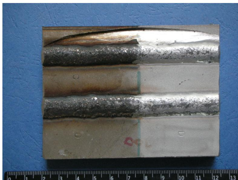
*Slika 8.11. Navarene gusjenice oznake C i D (gornja je oznake C, a donja oznake D) izvedene na čeličnoj ploči uz struju zavarivanja  $I_z = 180$  A; 235 A. Ljevi dio uzorka nije odmašćen i bajcan dok su ti postupci čišćenja izvedeni na desnom dijelu, kao što se i vidi.*
