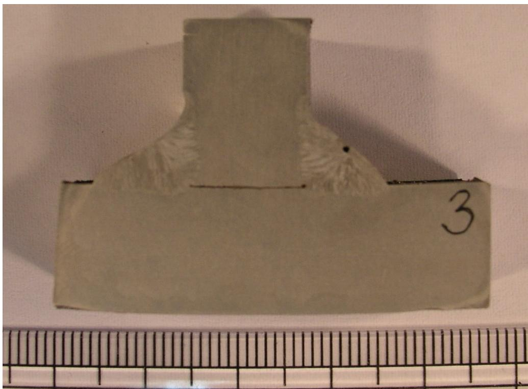
**Slika 8.27.** Prikaz makro izbruska broj 3, uzoraka A i B, prikazuje zavare kutnog T spoja dobijene FCAW-G postupkom uz PPŽ (lijevi zavar na slici) i MIG postupkom uz punu žicu (desni zavar na slici). Zavar dobiven uz FCAW-G postupak ima veću dubinu penetracije i nešto je širi uz bolju simetriju.
