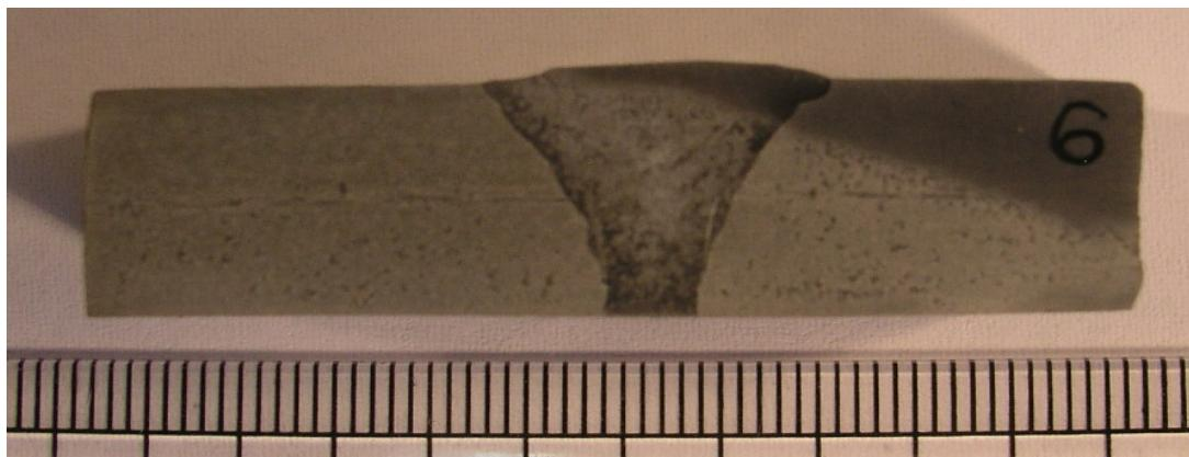
**Slika 8.30.** Prikaz makro izbruska broj 6, uzorka H, prikazuje zavar dobiven FCAW-G postupkom uz PPŽ i V žljeb kuta  $60^\circ$  uz razmak u korijenu od 3 mm i korištenje keramičke podloge. Ovako izveden zavar ima prolazno protaljen korijen kao i prolazno nadvišenje lica zavara. Vidi se razlika oblika profila zavara po visini u odnosu na predhodnu sliku i MIG postupak.
