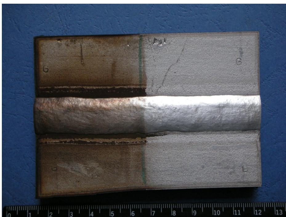
*Slika 8.13. Uzorak G je sučeljeni spoj izведен FCAW-G postupkom uz PPŽ.*
