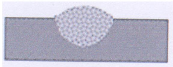
*Slika 3.8. Izgled profila zavara dobiven pri korištenju zaštitne mješavine plina Ar/CO<sub>2</sub>, ova vrsta mješavine daje dubinu penetracije ovisnu o udjelu CO<sub>2</sub> u mješavini, a na taj način se dubina penetracije može i prilagođavati ovisno o potrebi. [8]*
