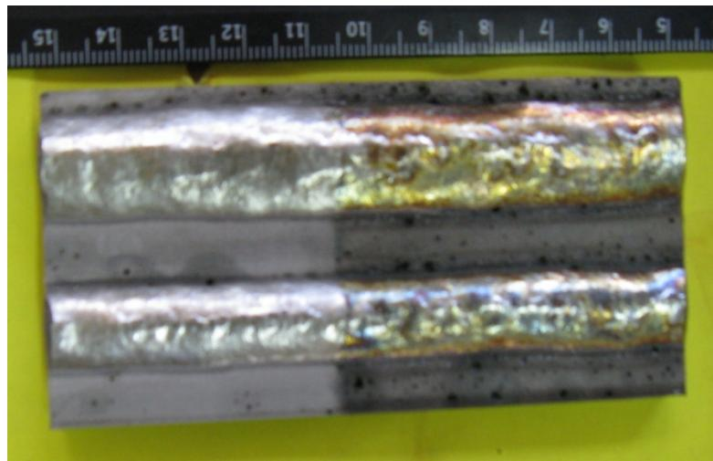
*Slika 8.20.* Navari izvedeni FCAW-G postupkom uz PPŽ, odnosno uzorci E i F. Jamičasta korozija je također zahvatila ZUT i osnovni metal koji je manje plemenit od dodatnog metala, a veličina i učestalost su vrlo slične kao i kod predhodnog uzorka.
