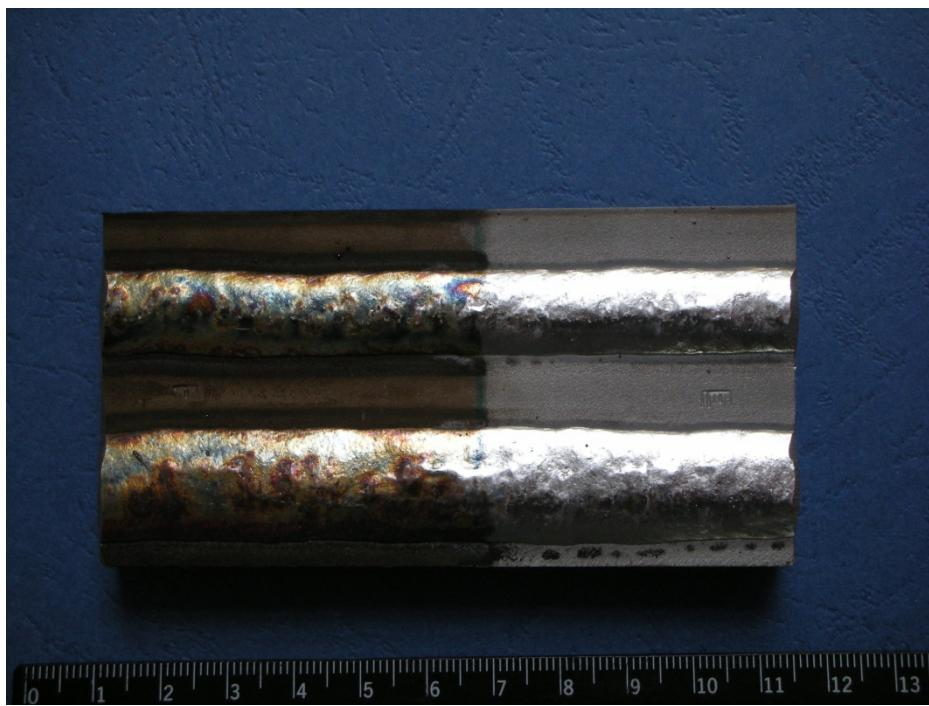
*Slika 8.12. Navarene gusjenice oznake E i F (gornja je oznake E, a donja oznake F) izvedene na čeličnoj ploči uz struju zavarivanja  $I_z = 180\text{ A}$ ;  $235\text{ A}$ . Kao i kod predhodnih uzoraka vidi se da je desni dio odmašćen i bajcan.*
