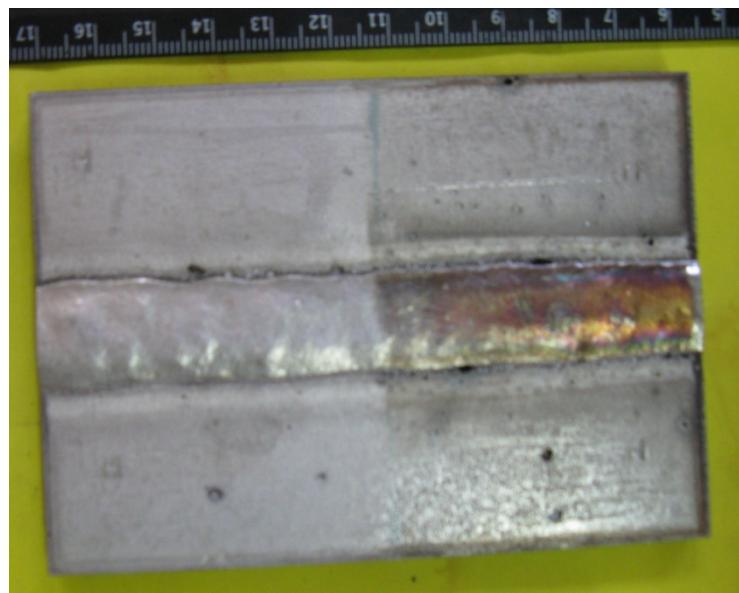
*Slika 8.22. Zavar sučeljenog spoja dobiven FCAW-G postupkom uz PPŽ kod uzorka H i razmak u korijenu od 3 mm. Vidljiv je razvoj rupičaste korozije uz liniju spoja metala zavara i ZUT-a, ali u manjem obimu nego kod predhodnog primjera. Kod ovog uzorka je došlo do prihvatljivog provara korijena.*
