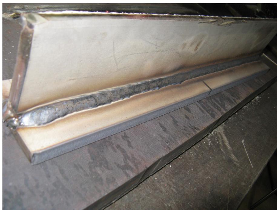
*Slika 7.11. T spoj kutnog zavara čelika 316Ti (W.Nr. 1.4671) zavaren MIG postupkom uz punu žicu.*
