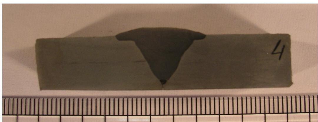
**Slika 8.28.** Prikaz makro izbruska broj 4, uzorka G, prikazuje zavar dobiven FCAW-G postupkom uz PPŽ i V žljeb kuta  $60^\circ$  uz razmak u korijenu od 1 mm i korištenje keramičke podloge. Ovako izveden zavar sadrži u korijenu zaostalu trosku vjerojatno zbog premalenog otvora korijena.
