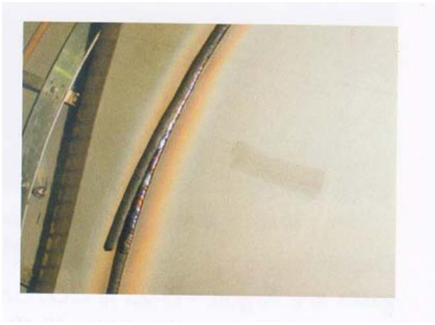
*Slika 3.4. Primjer samoskidajuće troske zavara. [4]*
