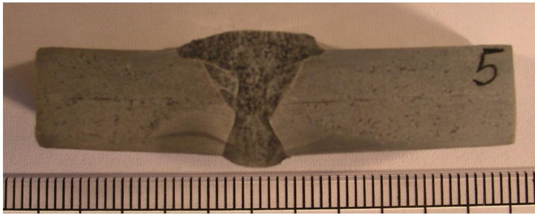
**Slika 8.29.** Prikaz makro izbruska broj 5, uzorka I, prikazuje zavar dobiven MIG postupkom uz punu žicu i V žljeb kuta  $60^\circ$  uz razmak u korijenu od 1 mm i korištenje keramičke podloge. Ovako izveden zavar ima dobru dubinu penetracije i dobar profil zavara, korijen je protaljen, a lice zavara ima nadvišenje.
