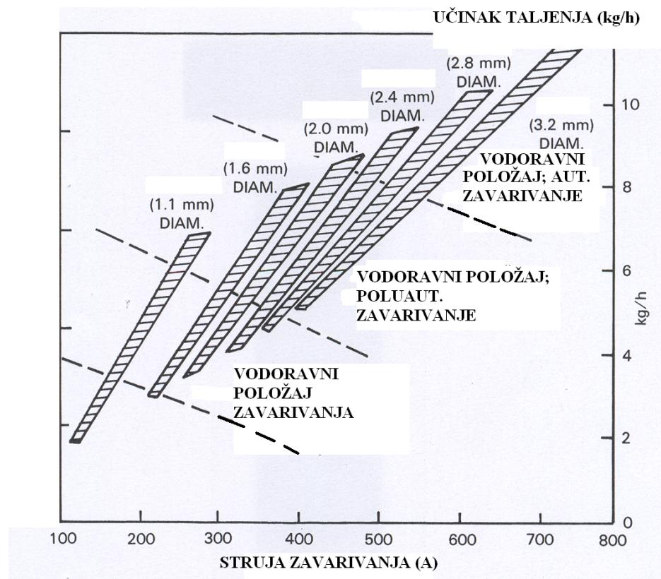
*Slika 4.4. Ovisnost struje zavarivanja o učinku taljenja kod FCAW-G postupka zavarivanja.*
