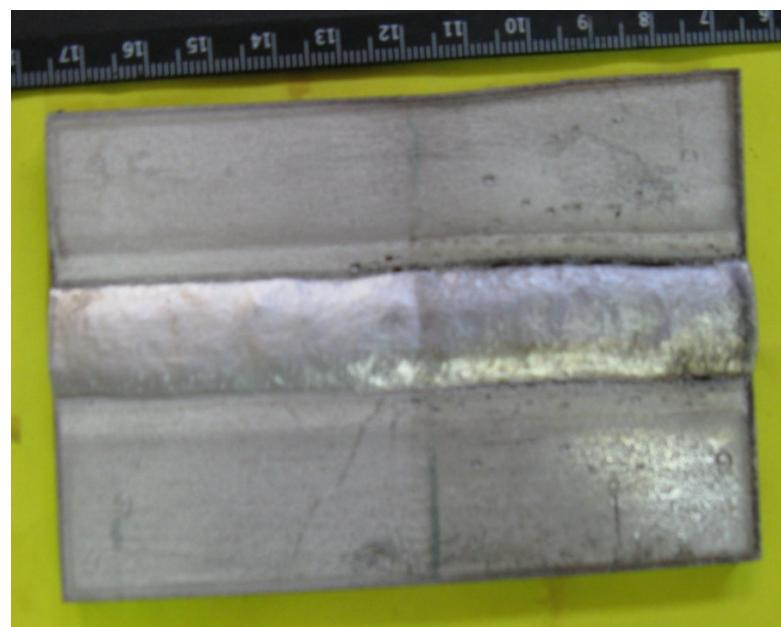
*Slika 8.21..* Zavar sučeljenog spoja dobiven FCAW-G postupkom uz PPŽ kod uzorka G i razmak u korijenu od 1 mm manje je zahvaćen jamičastom korozijom od predhodna dva primjera. Osnovni metal je ploča manje plemenitog čelika (čelik 304; dodatni metal je čelik 316), dok je vidljiv razvoj rupičaste korozije uz liniju spoja metala zavara i ZUT-a. Mogući uzrok je samo naljepljivanje zavara, bez provara u korijenu.
