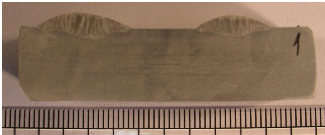
*Slika 8.25.* Prikaz makro izbruska broj 1, uzorka E i F prikazuje navare dobijene FCAW-G postupkom uz PPŽ i različite struje navarivanja. Dobiveni navari su široki, ali dubina penetracije je mala. Vidi se oblik navara na kojeg znatno utječe zaštitni plin.
