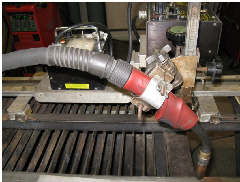
**Slika 7.5.** Prihvata zavarivačkog pištolja na uređaju Bug-O Systems Bug-5100. Omogućava odabir i mijenjanje kutova postavljanja zavarivačkog pištolja, udaljenost sapnice od radnog komada,...
