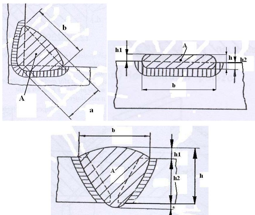
*Slike 8.31. Zajednički geometrijski parametri pokusnih zavara i navara. [14]*
