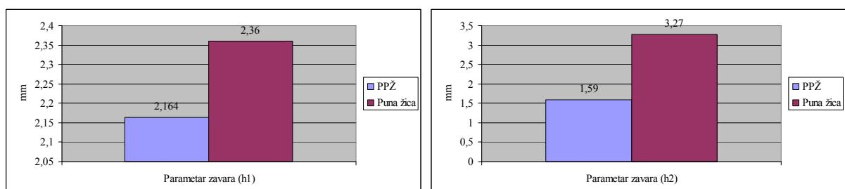
**Slika 8.42. i 8.43.** Usporedba zajedničkih parametara ( $h1$ ,  $h2$ ) PPŽ i pune žice uzoraka D i F u dijagramskom prikazu.
