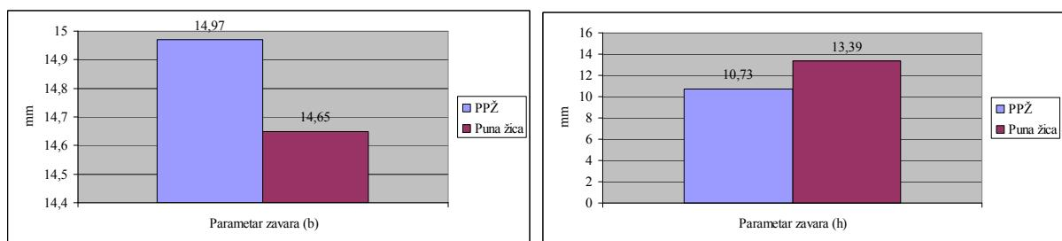
**Slika 8.45. i 8.46.** Usporedba zajedničkih parametara ( $b, h$ ) PPŽ i pune žice uzoraka H i I u dijagramskom prikazu.
