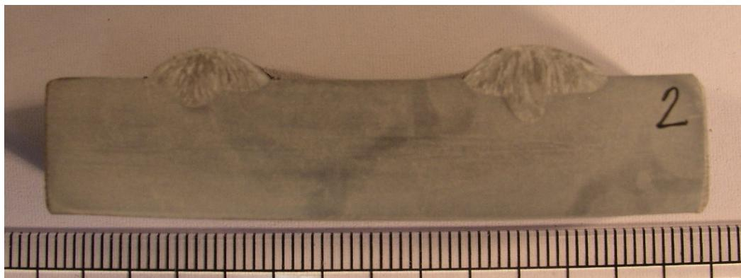
*Slika 8.26.* Prikaz makro izbruska broj 2, uzorka C i D, prikazuje navare dobijene MIG postupkom uz punu žicu i različite struje navarivanja. Dobiveni navari su uži, ali dubina penetracije je nešto veća i prstenastog je oblika. Također se vidi oblik navara na kojeg znatno utječe zaštitna mješavina (mješavina Ar/O<sub>2</sub>) koja daje tipičan oblik čavla.
