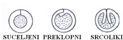
*Slika 3.1. Poprečni presjek elektrode koji pokazuje vrste spojeva pri izradi žice za zavarivanje. [5]*
