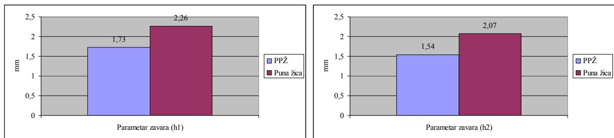
**Slika 8.37. i 8.38.** Usporedba zajedničkih parametara ( $h1$ ,  $h2$ ) PPŽ i pune žice uzoraka C i E u dijagramskom prikazu.
