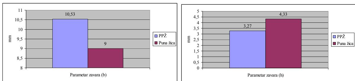
*Slika 8.35. i 8.36. Usporedba zajedničkih parametara (b, h) PPŽ i pune žice uzoraka C i E u dijagramskom prikazu.*
