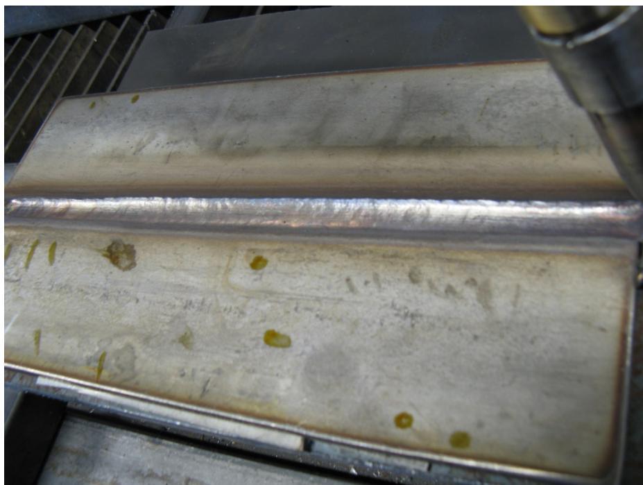
*Slika 8.6. Prvi prolaz (korijenski) pri zavarivanju MIG postupkom uz punu žicu i razmak u korijenu od 1 mm. Rezultat je vrlo dobar izgled lica zavara i vrlo je sličan onome dobijenom pri zavarivanju uz FCAW-G postupak.*
