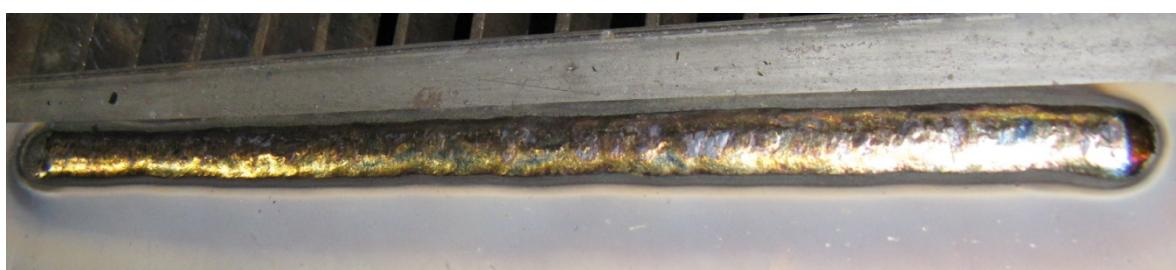
**Slika 7.14.** Izgled navarene gusjenice PPŽ nakon skidanja troske ( $I_z = 235 \text{ A}$ ).
