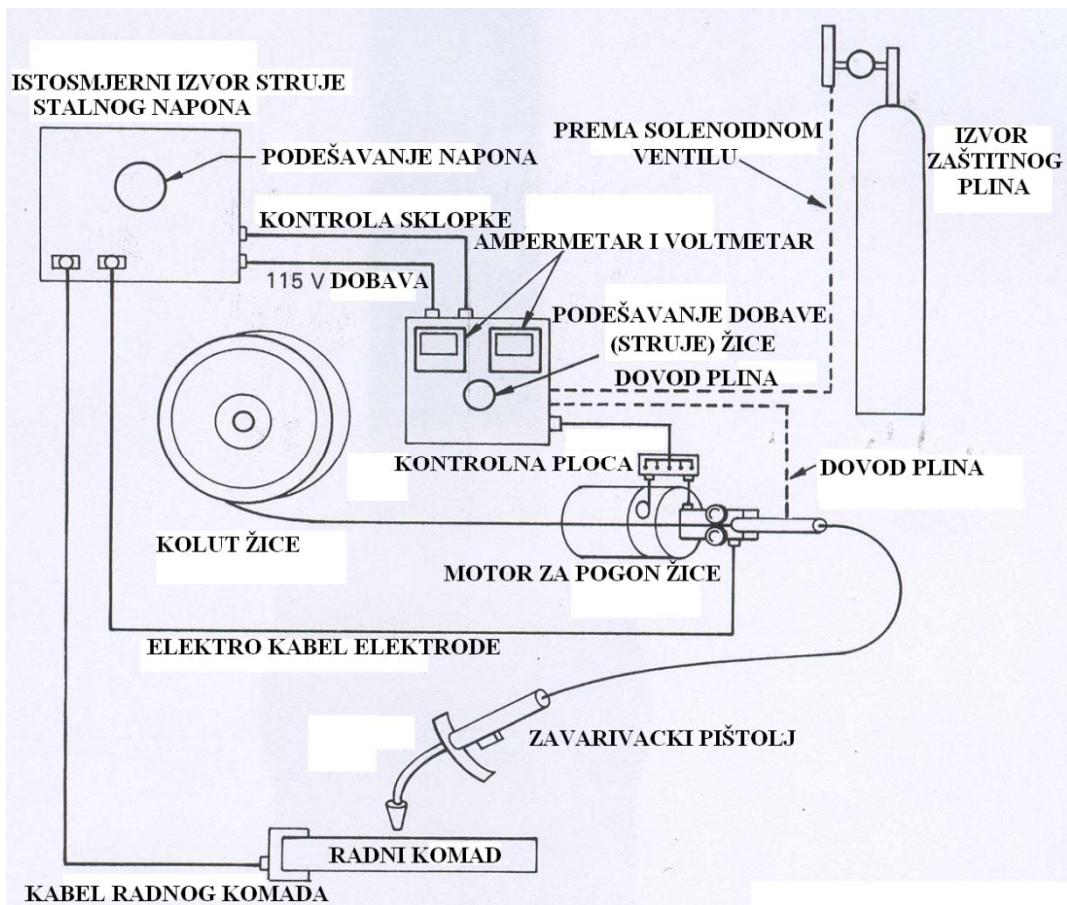
*Slika 3.11.* Dijelovi poluautomatske opreme za FCAW zavarivanje. [2]
