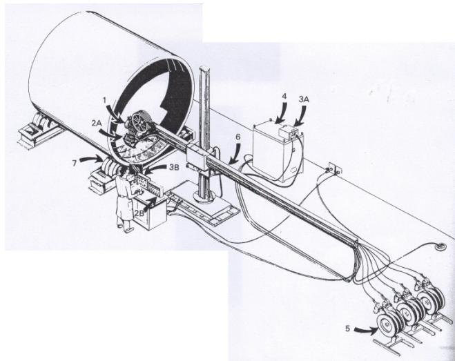
*Slika 5.3. Više elektrodni sustav za zavarivanje. [2]*
