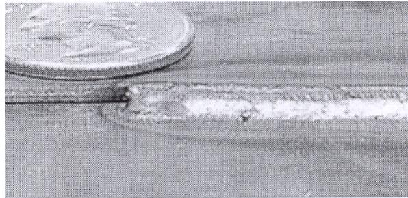
*Slika 1.1. Izgled zavara dobivenog MIG/MAG postupkom. [1]*
