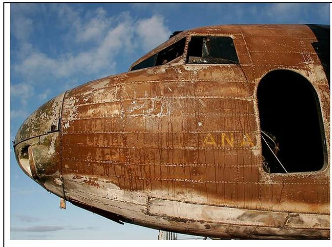
Slika 2-3 Opća korozija[6]
