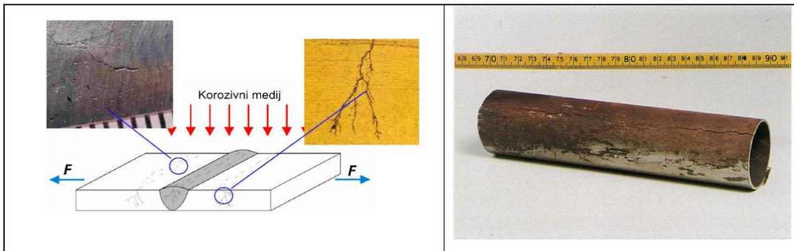
Slika 2-7 Napetosna korozija[5,7]
