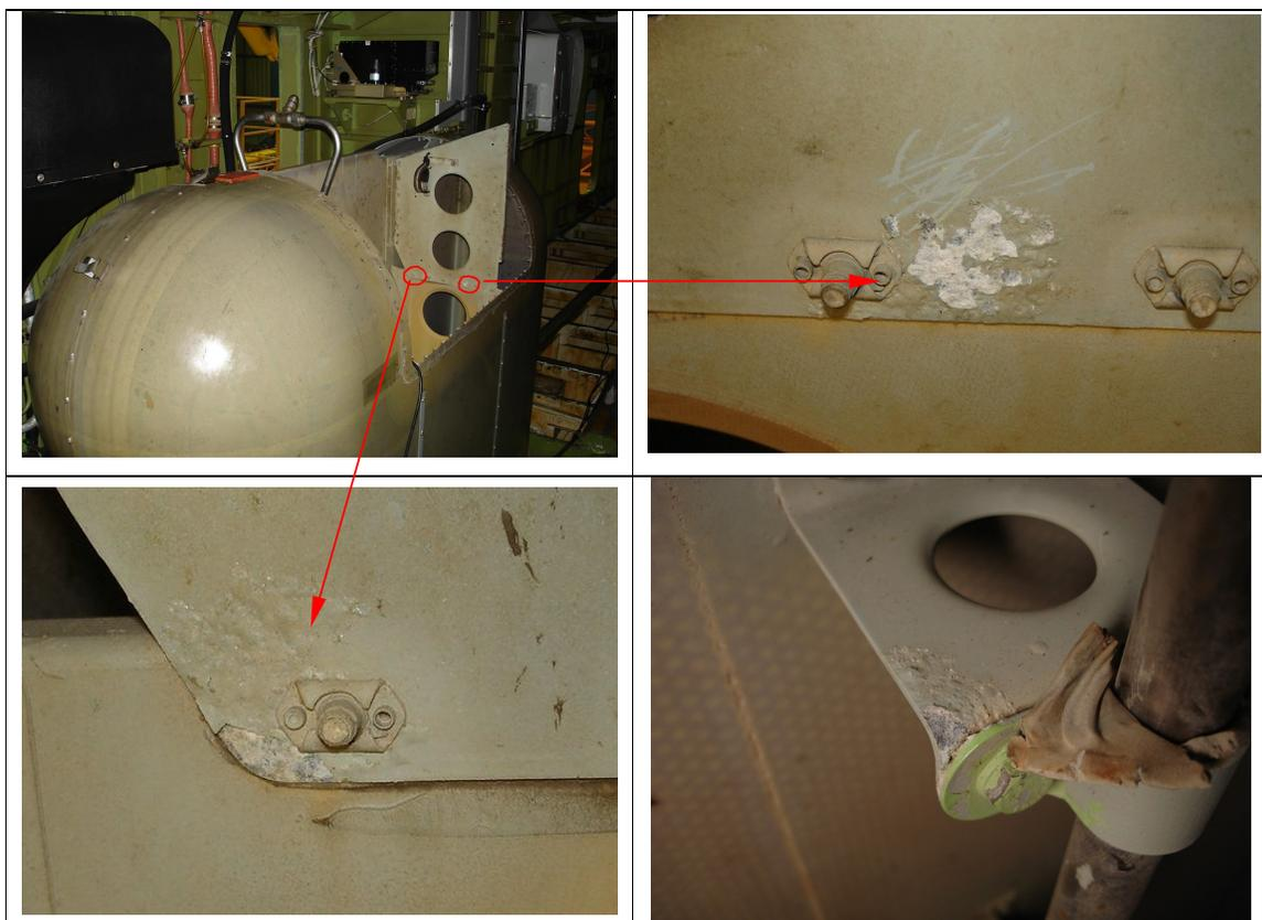
Spremnik za vodu – slana voda unutar spremnika utjecala je na pojavu potpovršinske korozije te dovela do bubrenja zaštitnog premaza. Crvene strelice pokazuju mjesta nastalih korozijskih oštećenja unutar spremnika.
