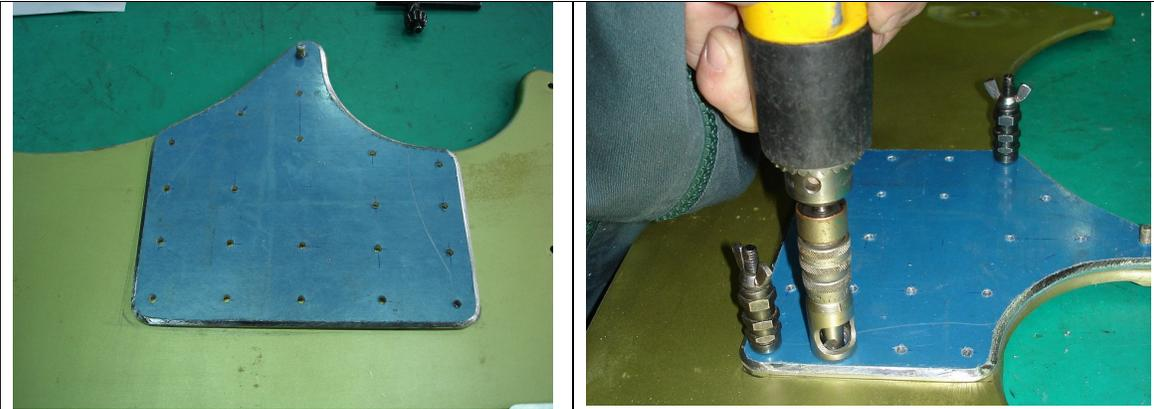
Za sanaciju pukotine koristi se aluminijska legura 7075. Oblik i debljina materijala za sanaciju te raspored zakovica na saniranom mjestu u potpunosti su definirani u "Maintenance manual-u".
