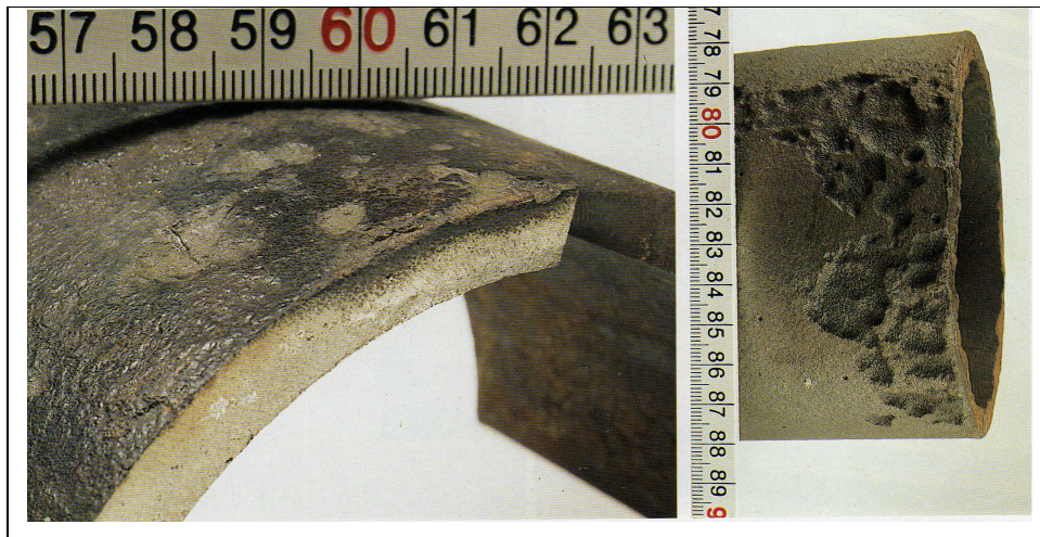
Slika 2-8 Selektivna korozija u obliku grafitizacije sivog lijeva[7]
