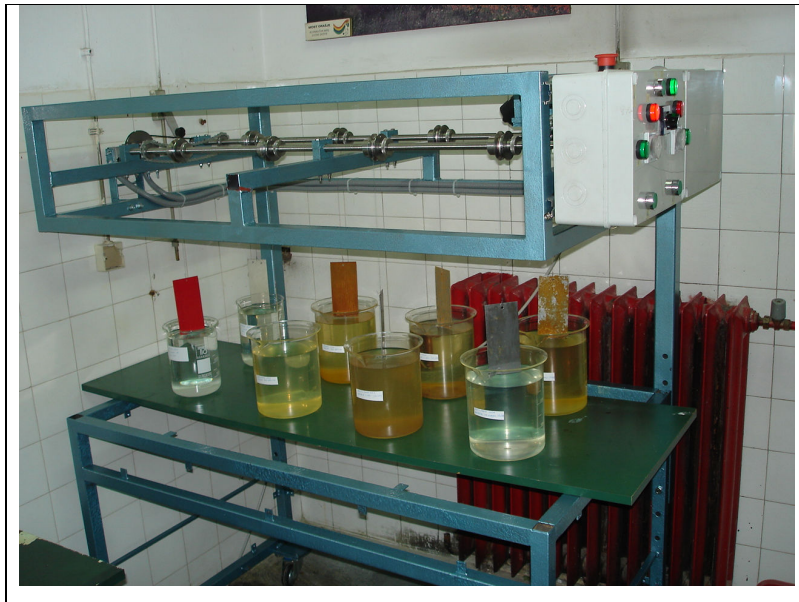
Slika 7-6 Ispitivanje uranjanjem u 3.5% -tnoj otopini NaCl[22]
