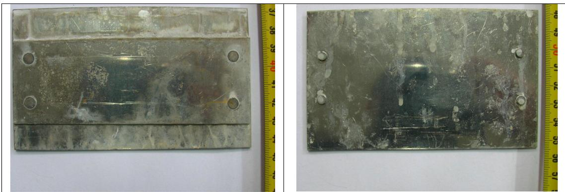
Uzorak broj 1 nakon 48 sati u slanoj komori
