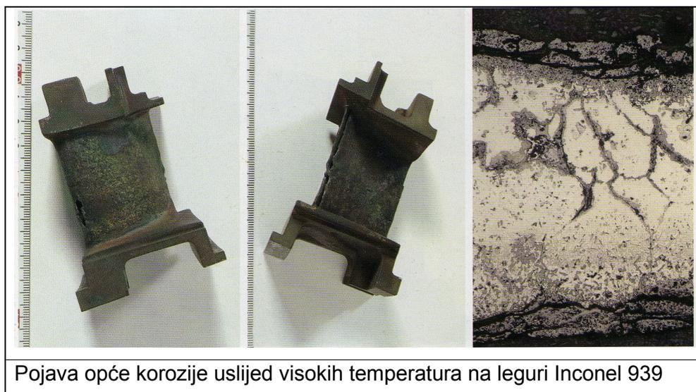
Pojava opće korozije uslijed visokih temperatura na leguri Inconel 939
