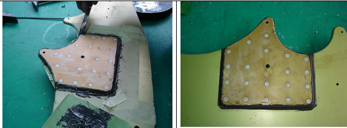
Nakon što je dio zakovicama spojen na valobran, slijedi nanošenje brtvila (P/S 870B) na mjesta spoja dvaju dijelova radi sprečavanja ulaska morske vode u procijep što bi moglo uzrokovati pojavu korozije. Valobran je spreman za zaštitu premazima nakon sušenja brtvila.
