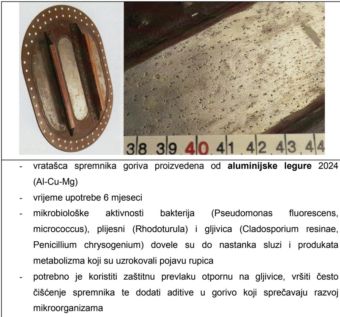
Slika 5-8 Vratašca zrakoplovnog spremnika goriva[7]
