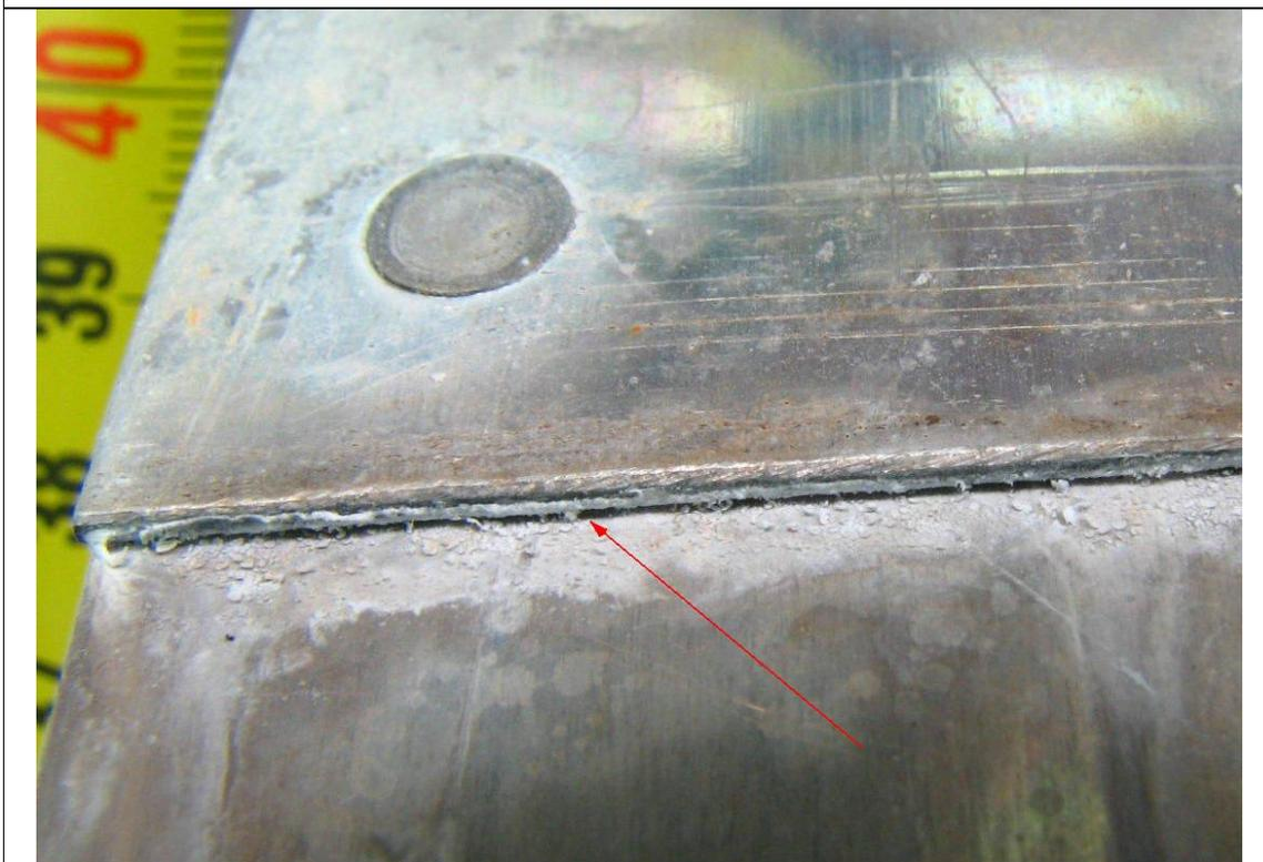
Na spoju dviju pločica vidljivi začeci pojave korozije u procijepu
