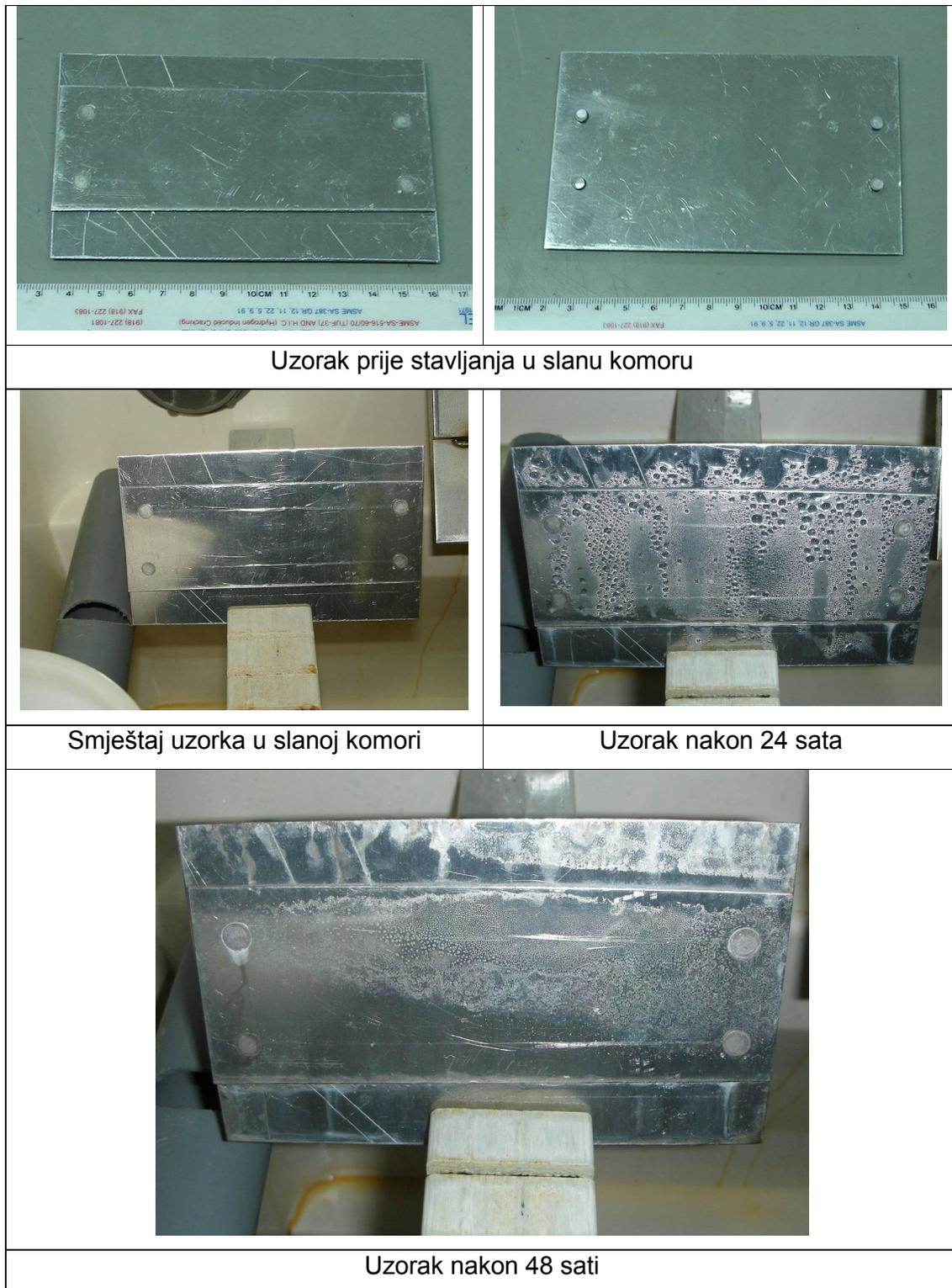
Slika 7-4 Ispitivanje uzorka broj 1 u slanoj komori[22]
