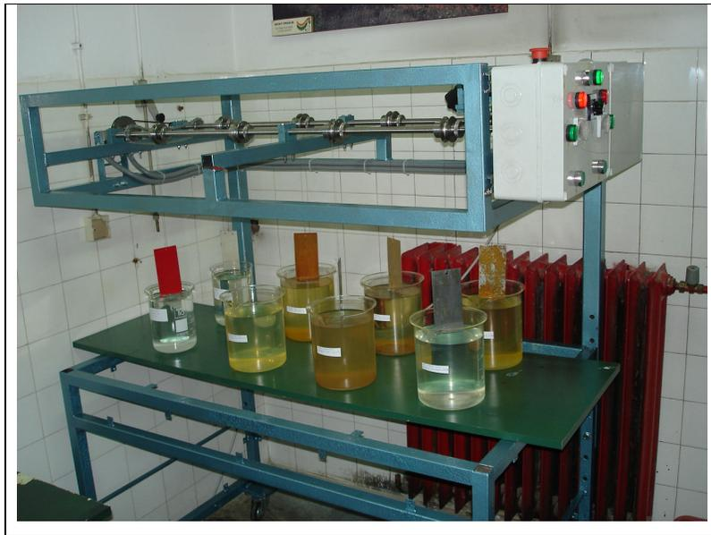
Slika 7-6 Ispitivanje uranjanjem u 3.5% -tnoj otopini NaCl[22]
