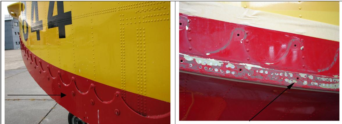
Smještaj valobrana na zrakoplovu i vidljiva mjesta spojeva valobrana sa trupom zrakoplova nakon što je uklonjen.
