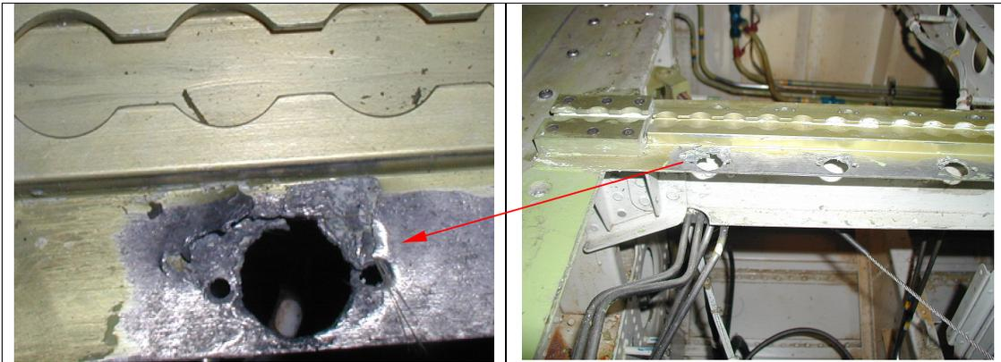
Noseća konstrukcija panela poda – spremnik za pjenu bio je pričvršćen na noseći element; došlo je do kontaminacije pjenom iz spremnika; pojava korozije u procijepu uzrokovala je smanjenje debljine nosećeg elementa.
