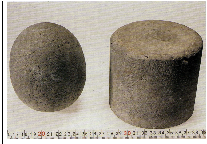
Slika 3-6 Galvanska korozija magnezija[7]
