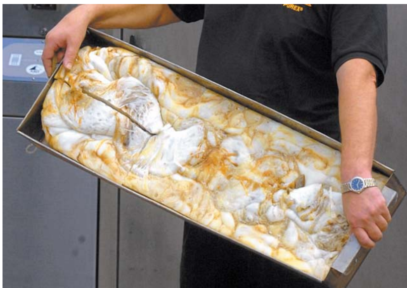
Slika 4.16 Blok PS-E-a nakon izlaza iz styromelta [35]
